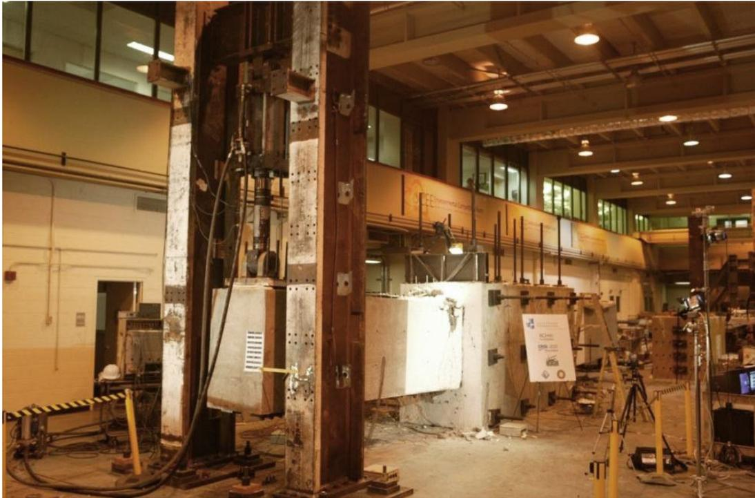
**圖 1-5 PEER 大尺寸矩形梁之反覆載重試驗裝置**
