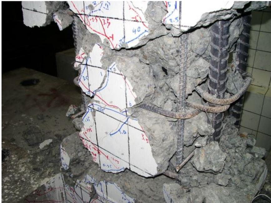
**圖 4-29 RH/SU 試體細部破壞圖**
