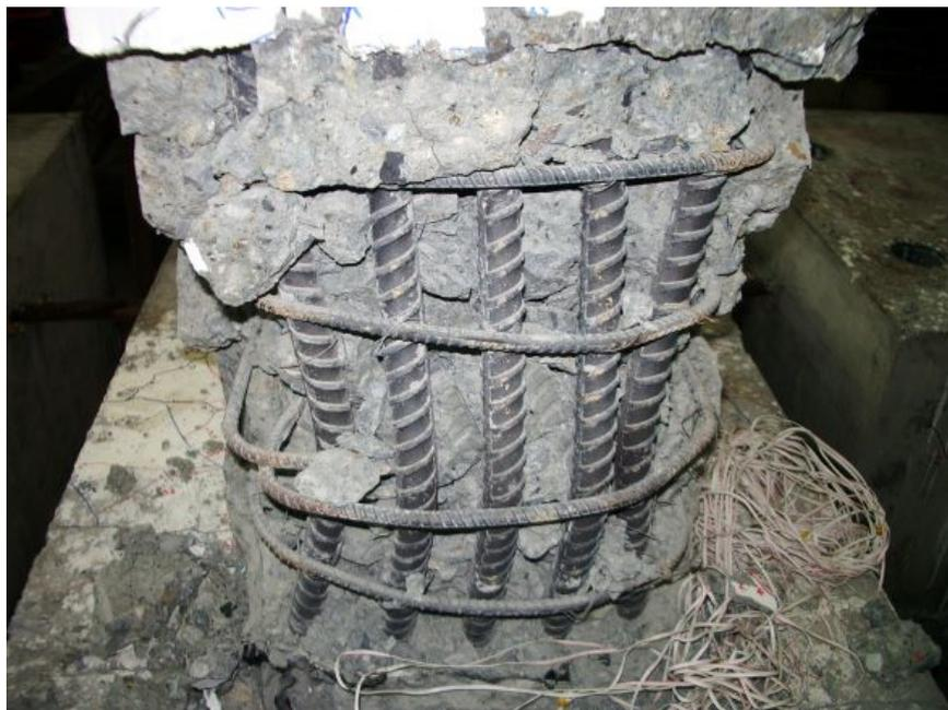
**圖 4-9 S4D 試體細部破壞圖**
