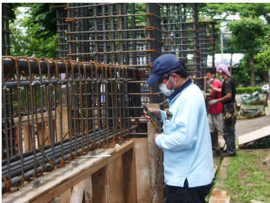
**圖 3-6 試體應變規施工圖(2)**
