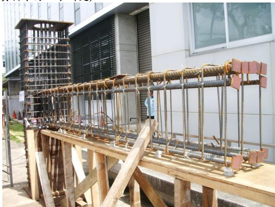
**圖 3-2 試體鋼筋組立圖(梁)**
