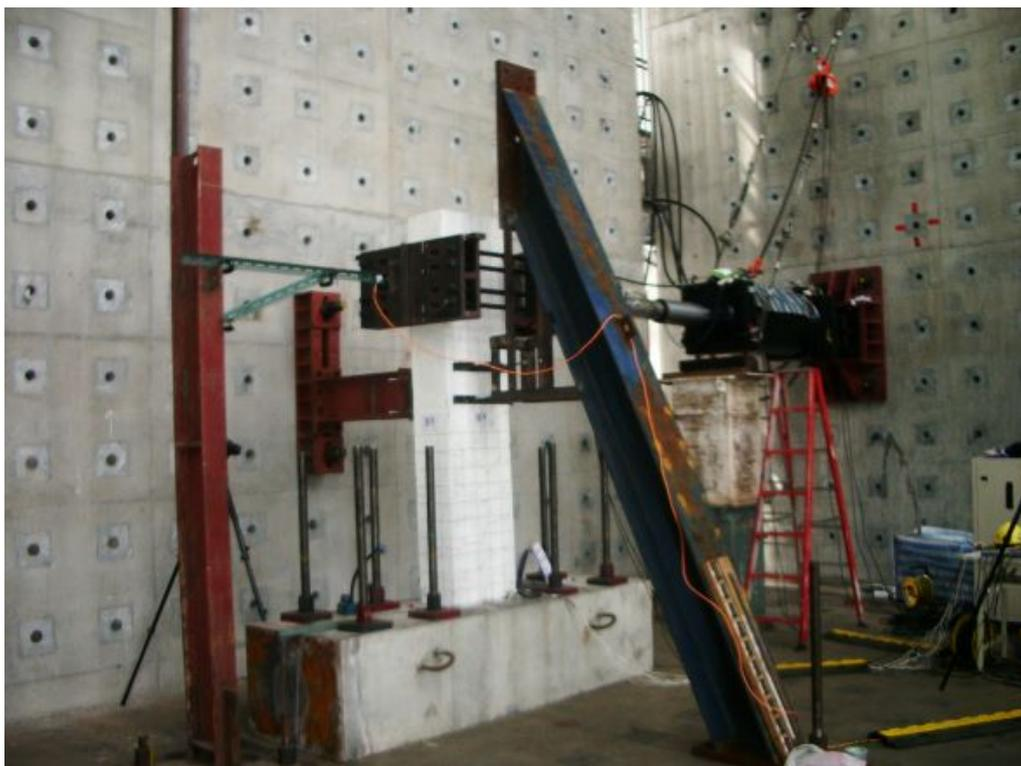
圖 4-2 鋼筋混凝土梁試體試驗圖
