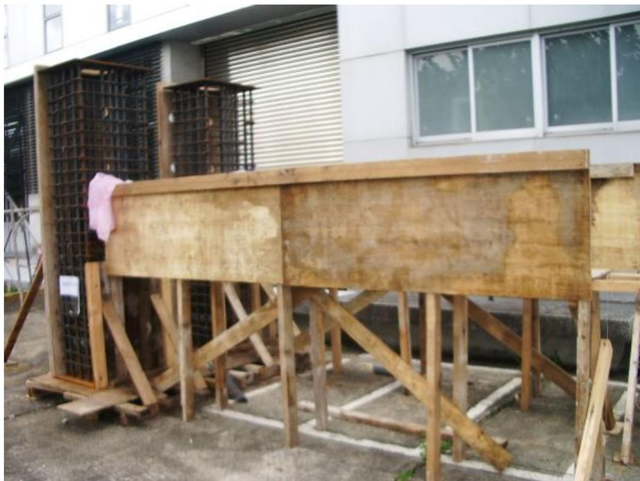
**圖 3-4 試體模板組立圖(梁)**
