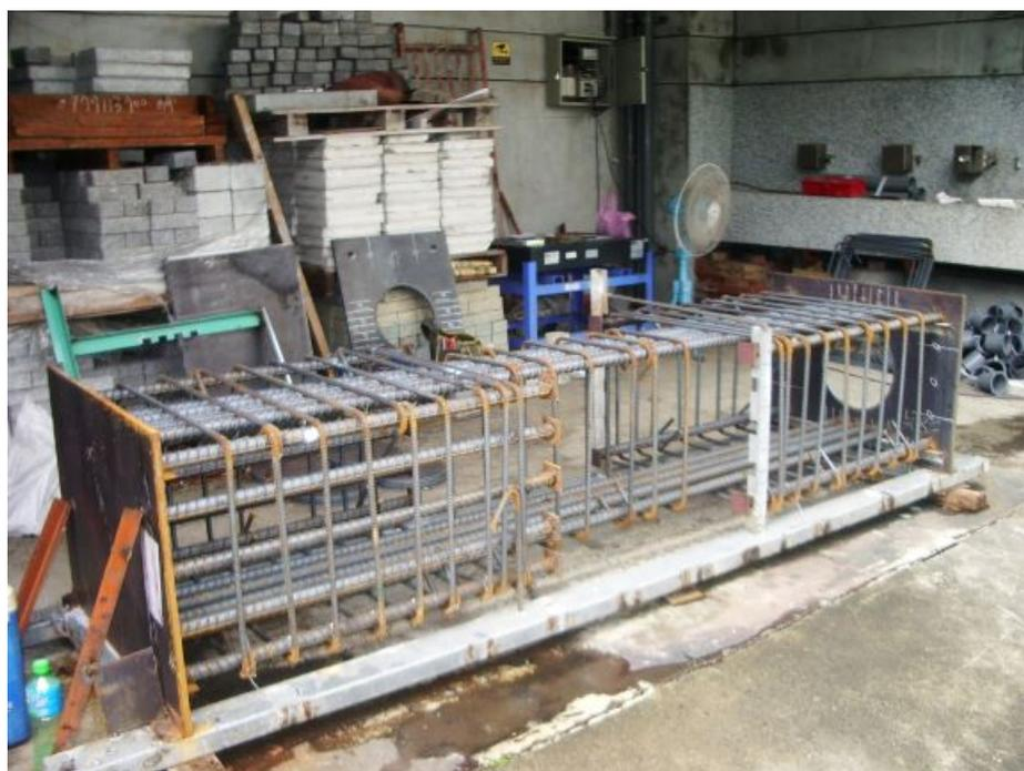
**圖 3-1 試體鋼筋組立圖(柱)**
