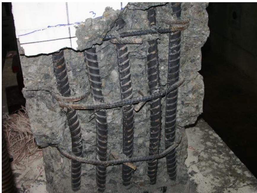
**圖 4-16 S6D-SHT 試體細部破壞圖**
