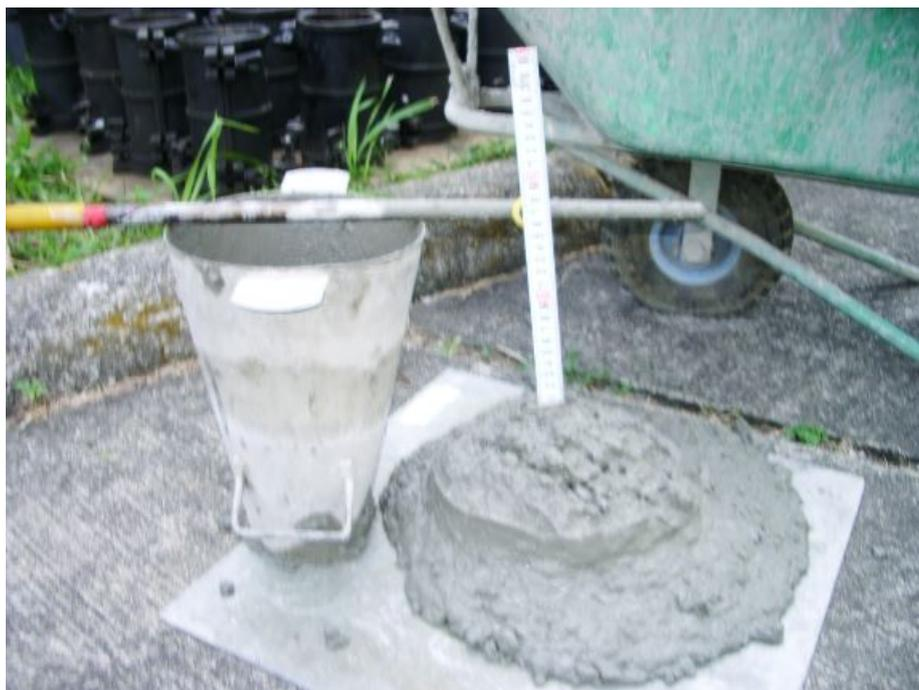
**圖 3-9 預拌混凝土坍度試驗圖**
