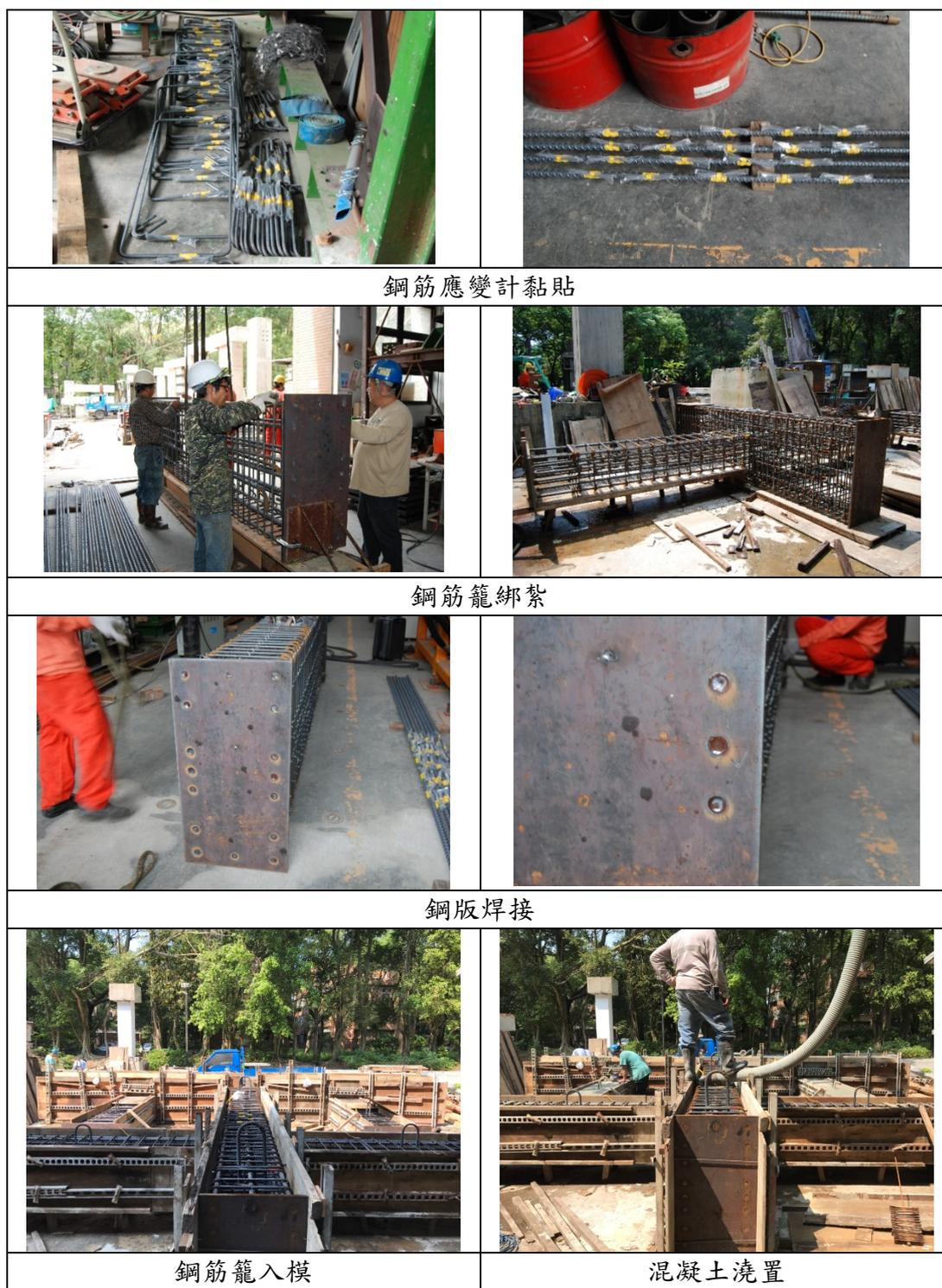
**圖 1-11 鋼筋混凝土梁柱接頭試體施工圖**
