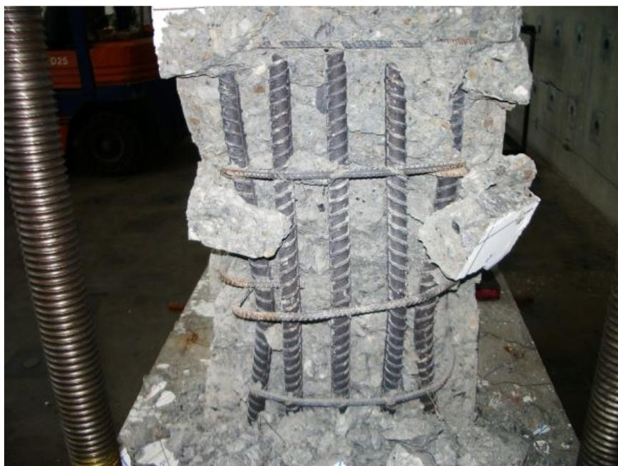
**圖 4-10 S6D 試體細部破壞圖**
