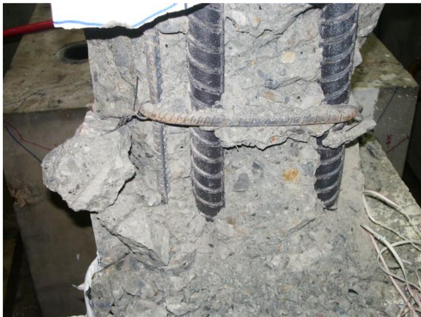
**圖 4-30 SH/SLB 試體細部破壞圖**
