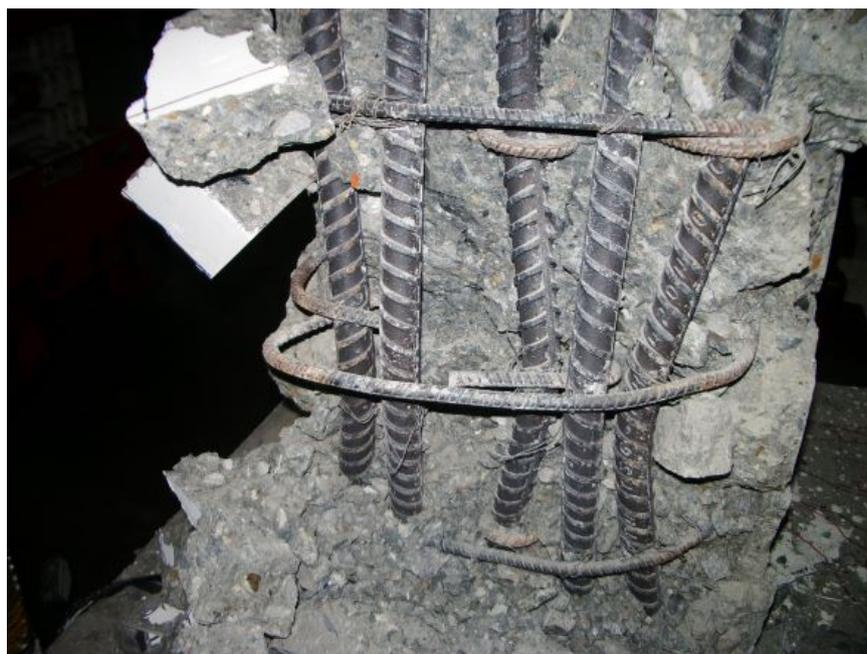
**圖 4-17 S6D-SHB 試體細部破壞圖**
