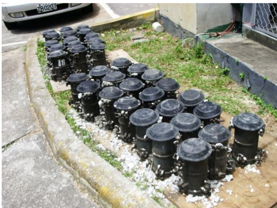
**圖 3-12 混凝土圓柱試體圖**
