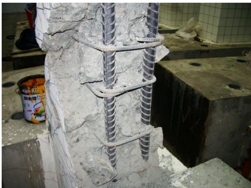
**圖 4-31 RH 試體細部破壞圖**
