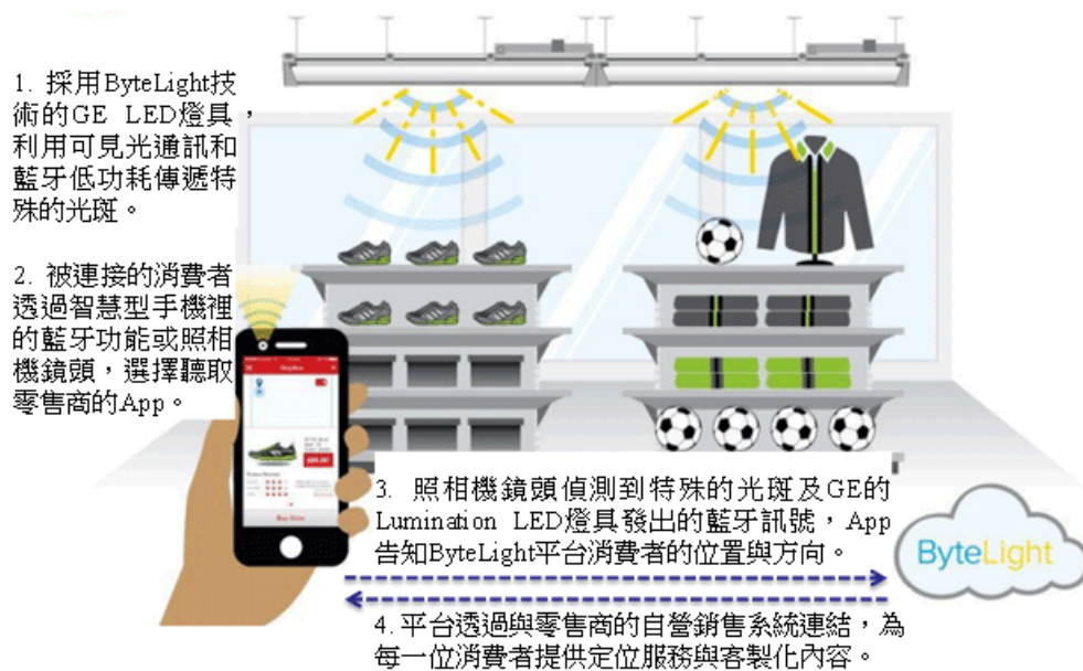
圖 4 GE 公司利用 VLC 進行智慧照明連網服務架構(拓璞產業研究所，2019)
