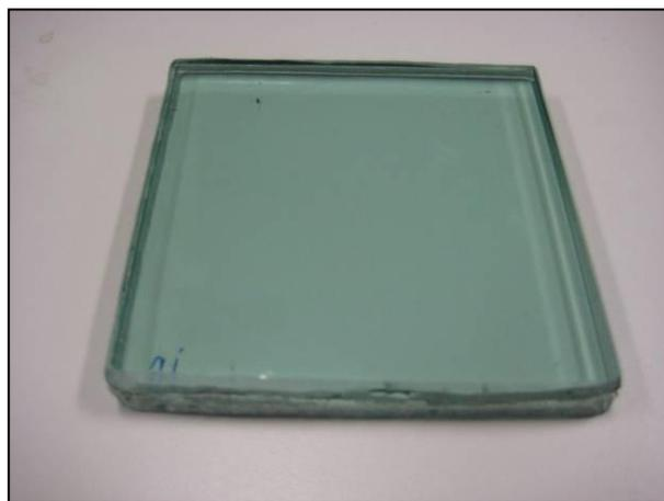
圖 2-1.4 膠合玻璃剖面示意圖及照片
