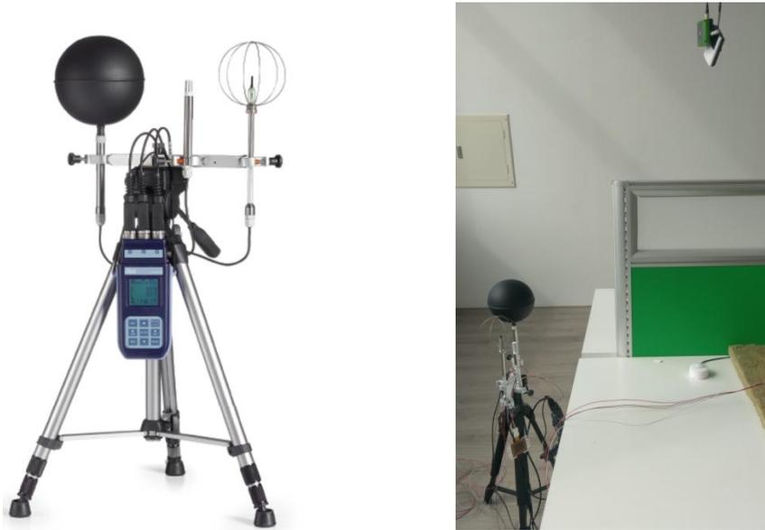
圖 3-3.5 室內熱舒適性量測系統
