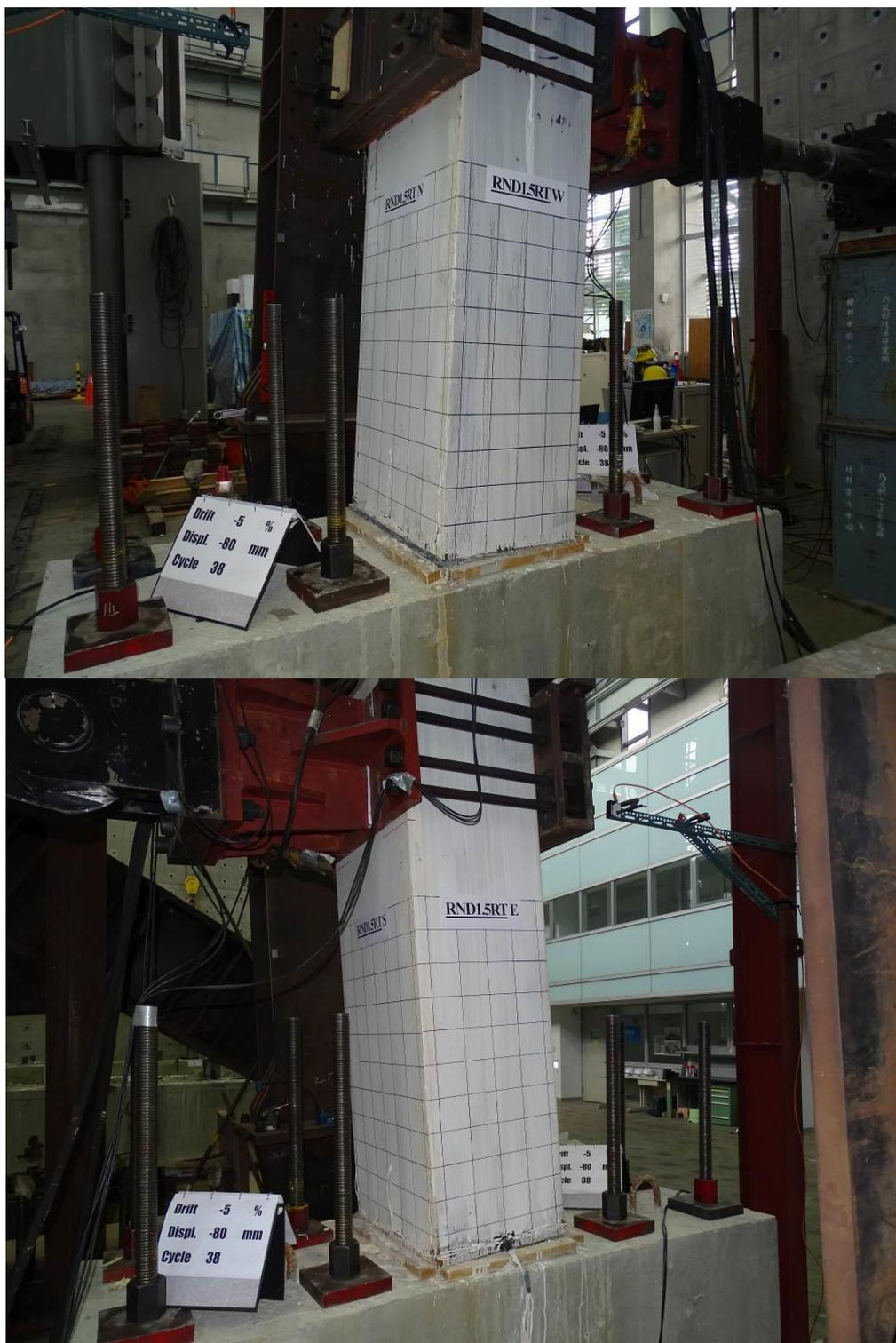
圖 3-88 側移角-5.0 %時 RND1.5RT 試體照片
