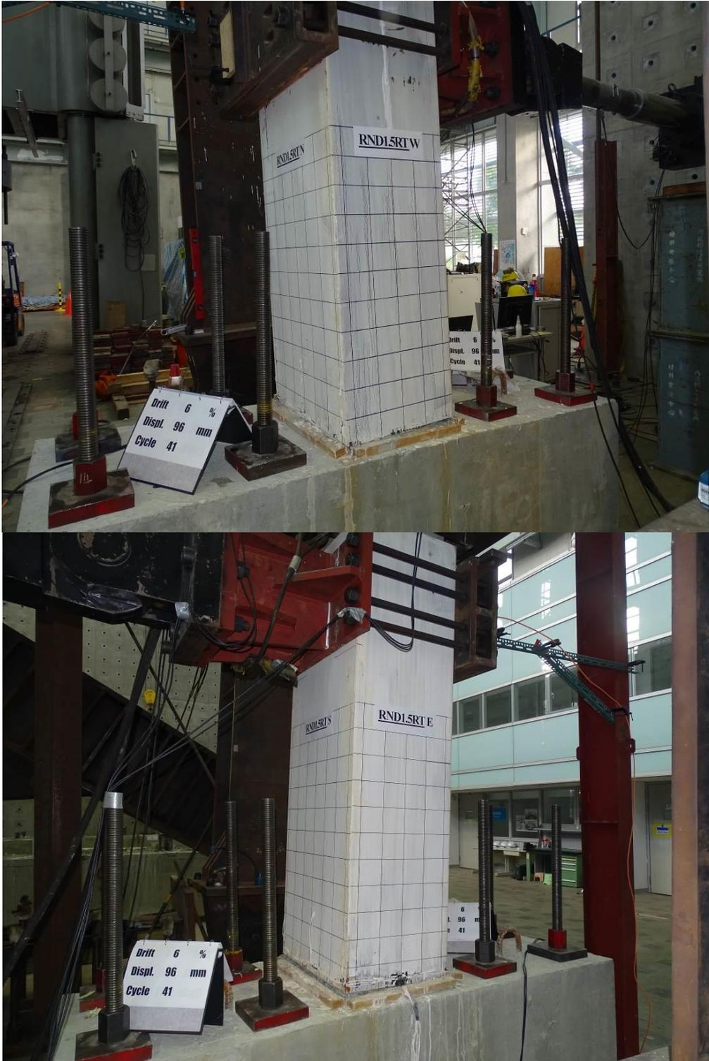
圖 3-89 側移角 6.0 %時 RND1.5RT 試體照片
