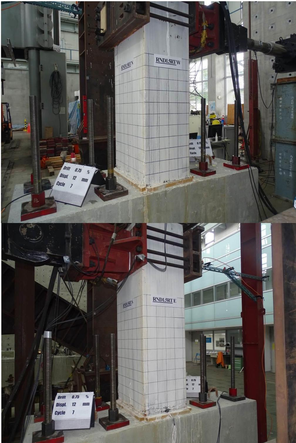
圖 3-65 側移角 0.75 % 時 RND1.5RT 試體照片
