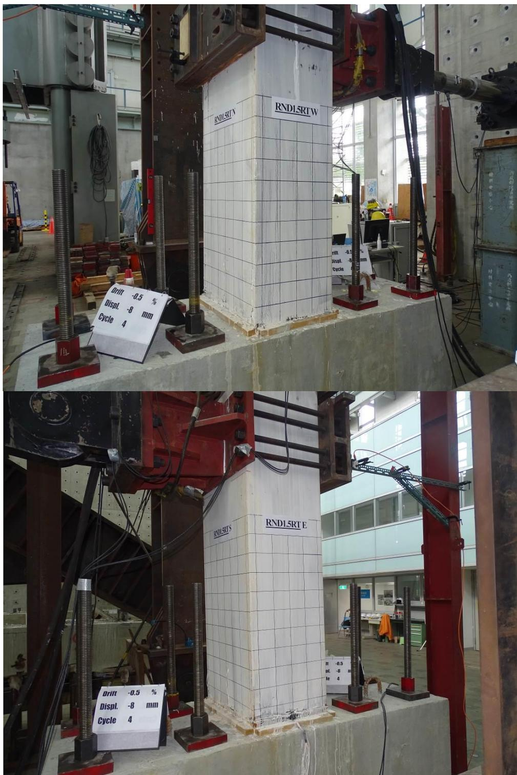
圖 3-64 側移角-0.5 %時 RND1.5RT 試體照片
