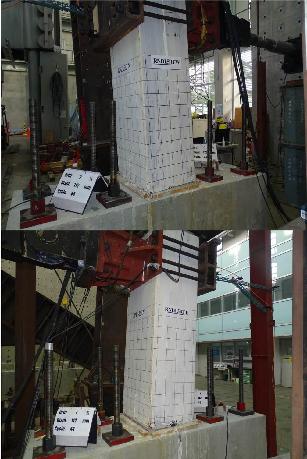
圖 3-91 側移角 7.0 %時 RND1.5RT 試體照片
