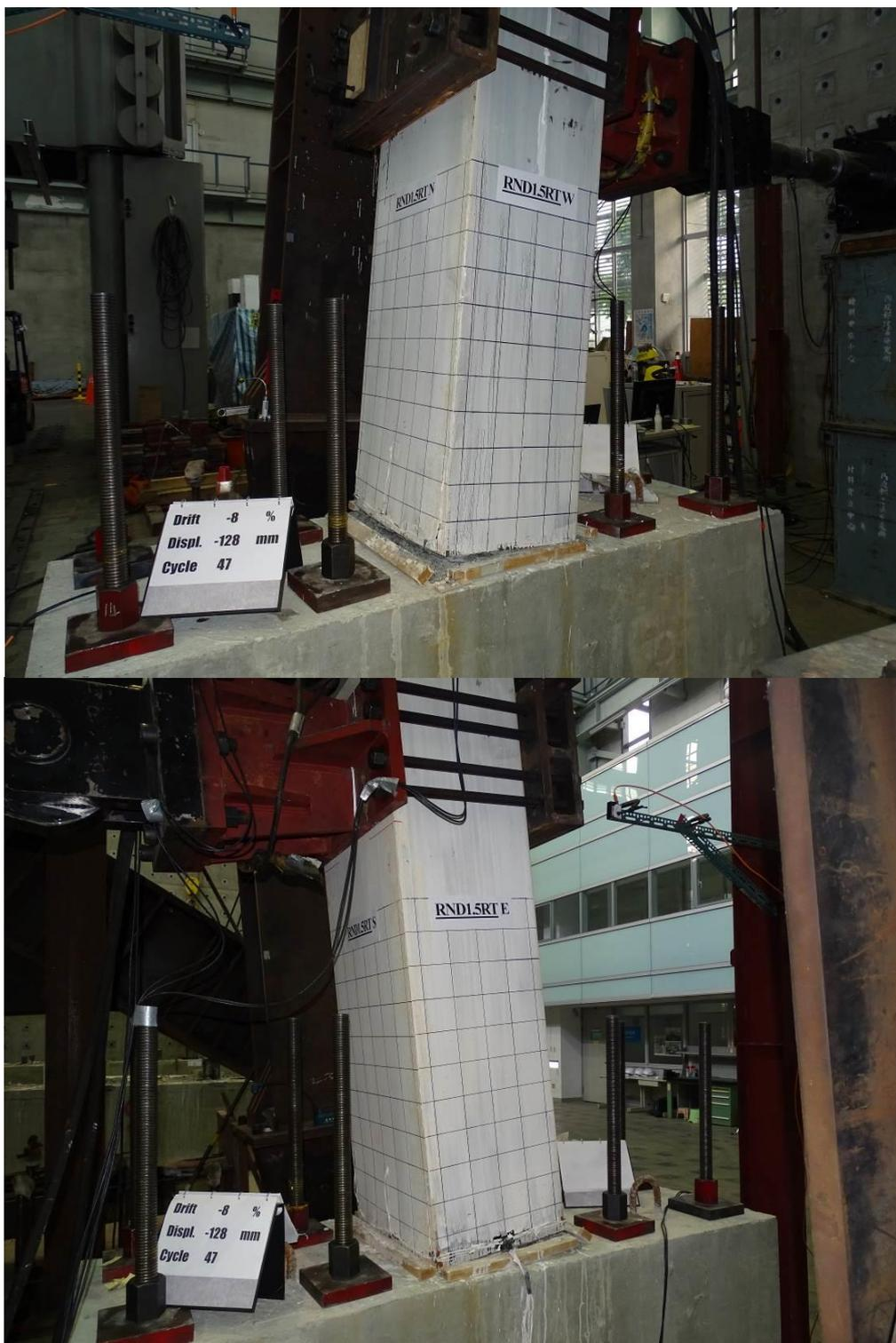
圖 3-94 側移角-8.0 %時 RND1.5RT 試體照片
