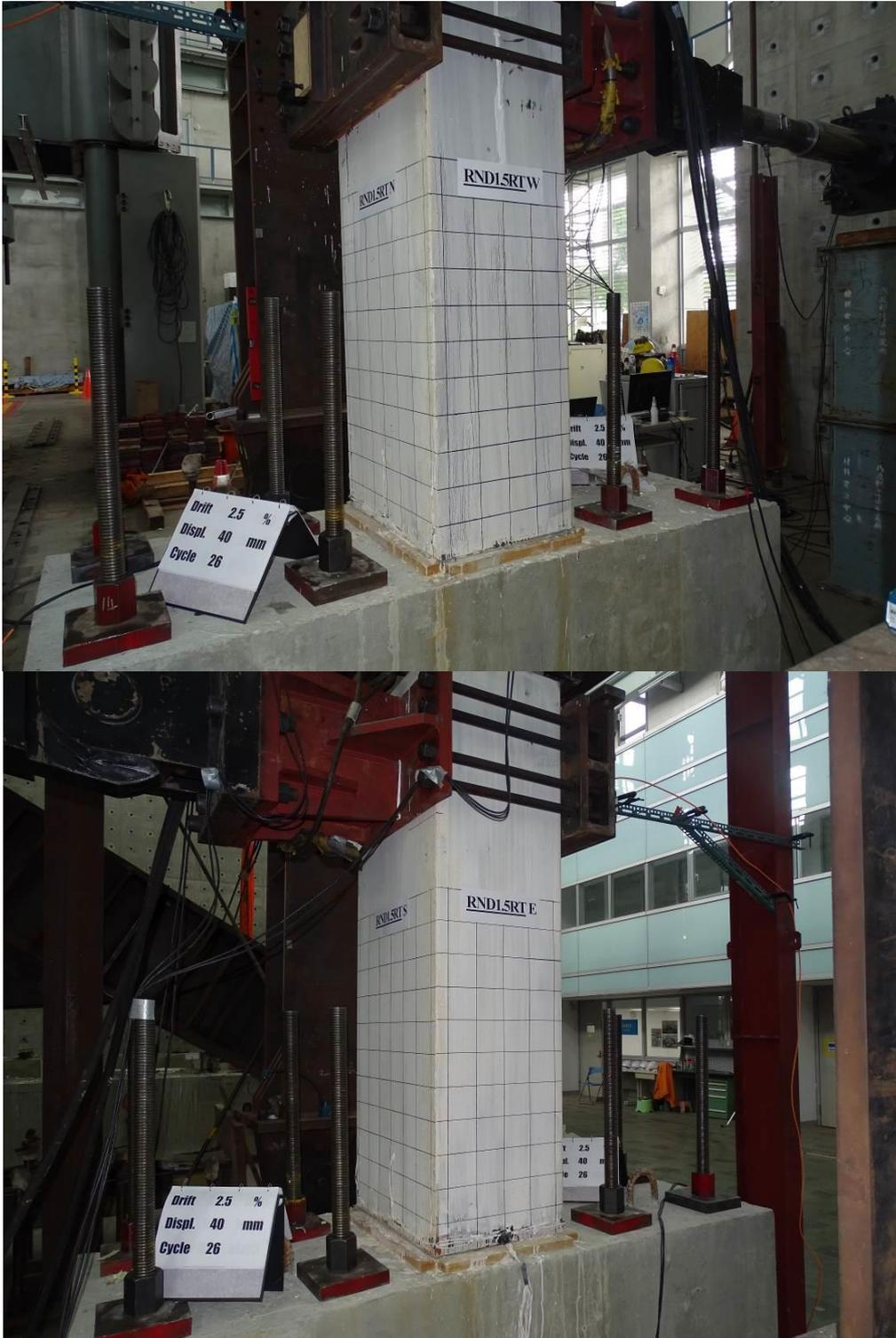
圖 3-77 側移角 2.5 %時 RND1.5RT 試體照片
