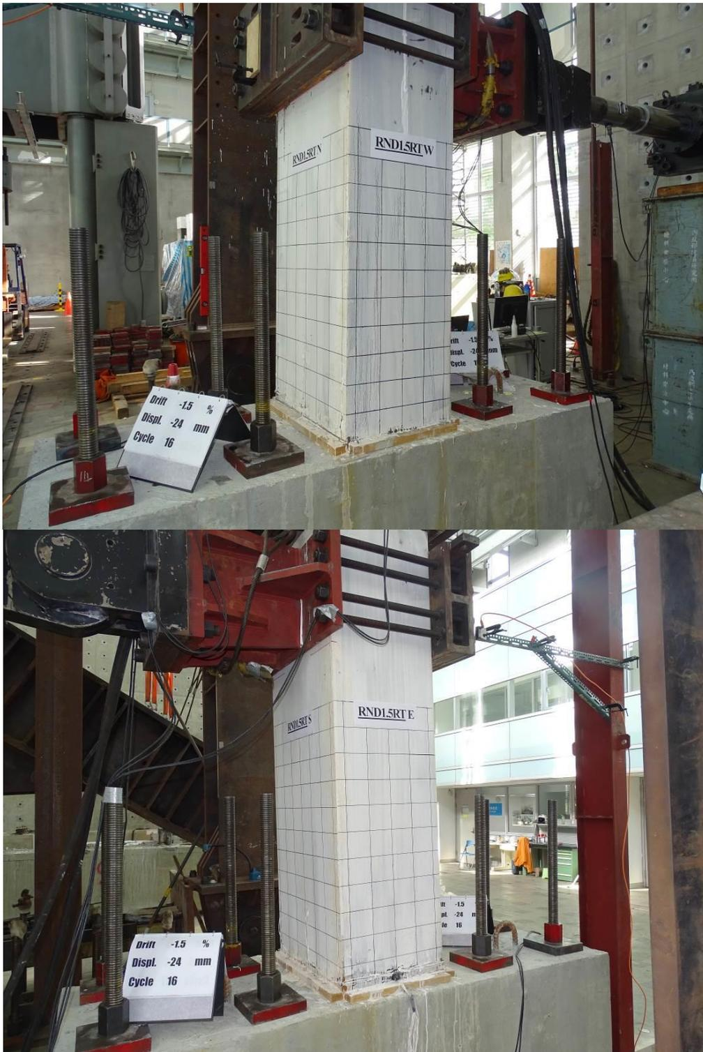
圖 3-72 側移角-1.5 %時 RND1.5RT 試體照片
