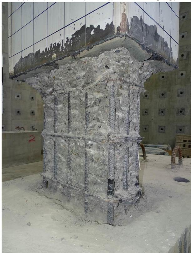
圖 4-9 RND2.0RT 切開補強鋼板及敲除保護層之觀察照片
