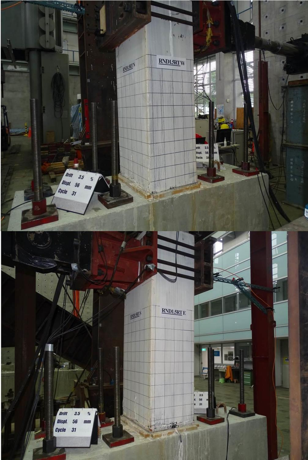
圖 3-81 側移角 3.5 %時 RND1.5RT 試體照片
