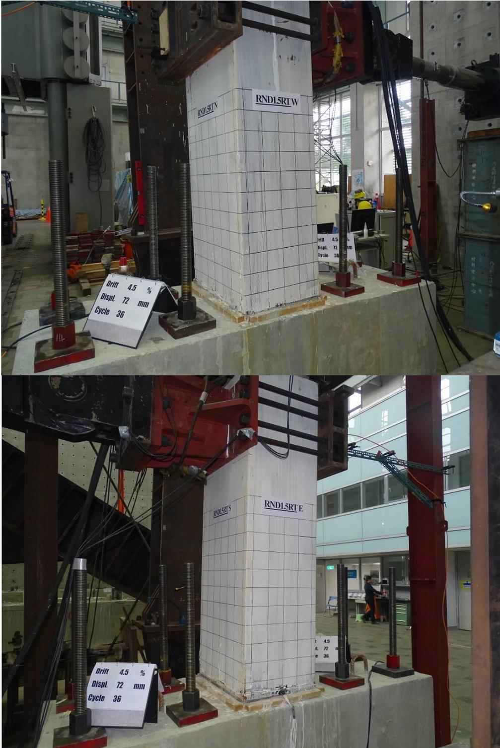
圖 3-85 側移角 4.5 %時 RND1.5RT 試體照片
