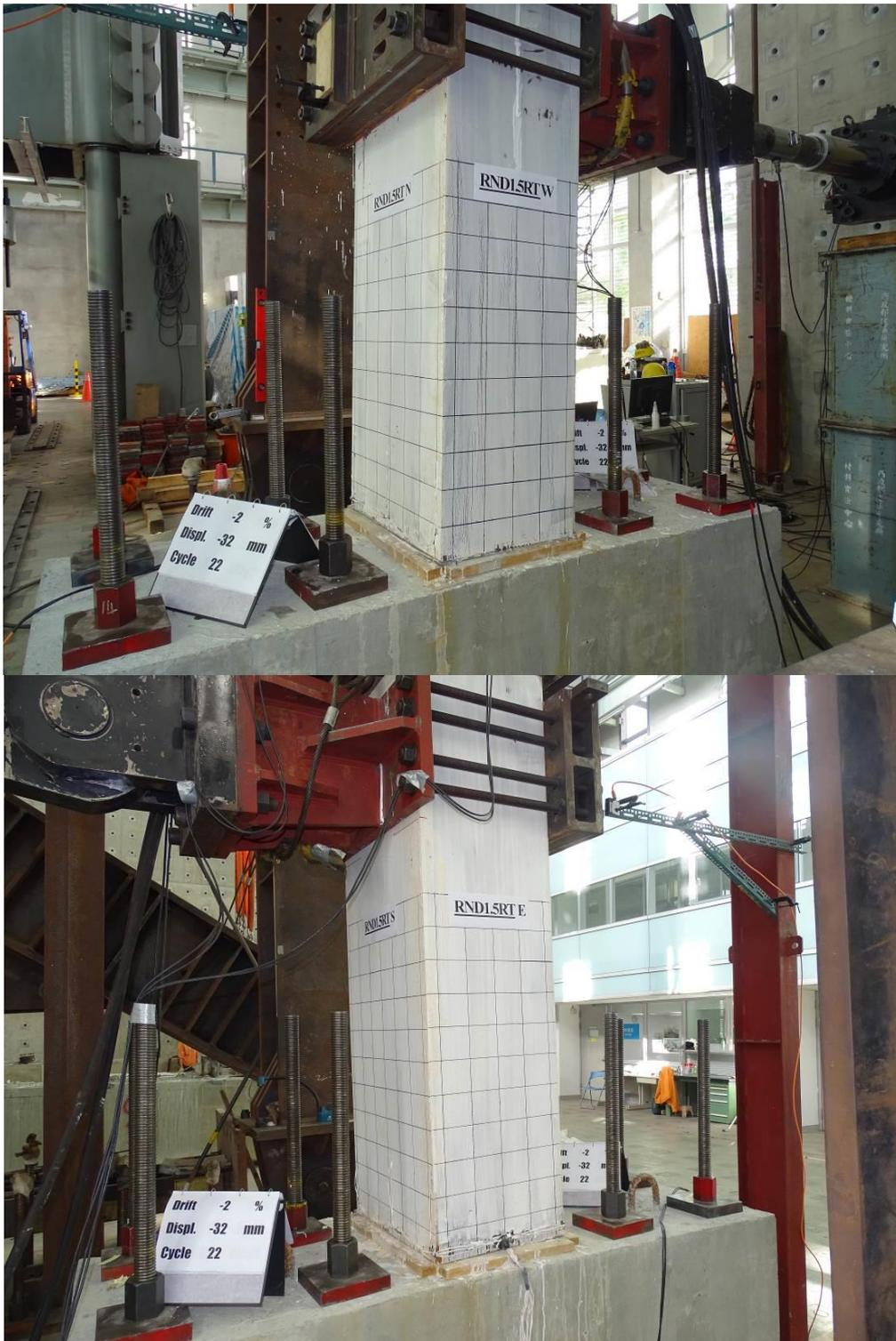
圖 3-76 側移角-2.0 %時 RND1.5RT 試體照片
