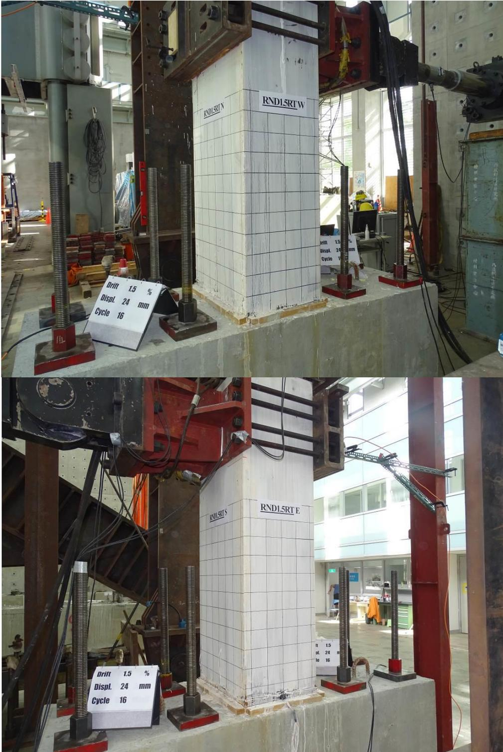
圖 3-71 側移角 1.5 % 時 RND1.5RT 試體照片
