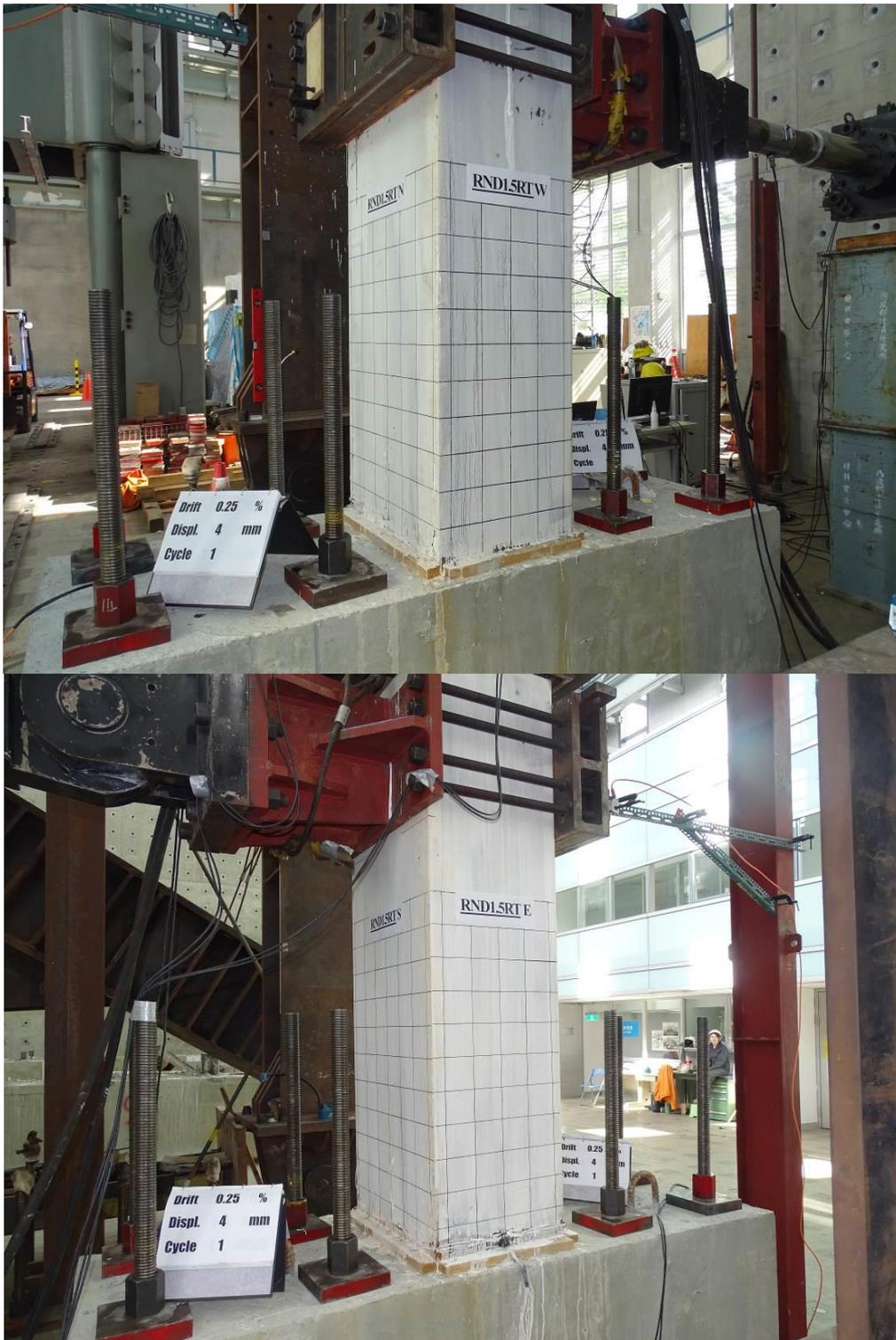
圖 3-61 側移角 0.25 % 時 RND1.5RT 試體照片
