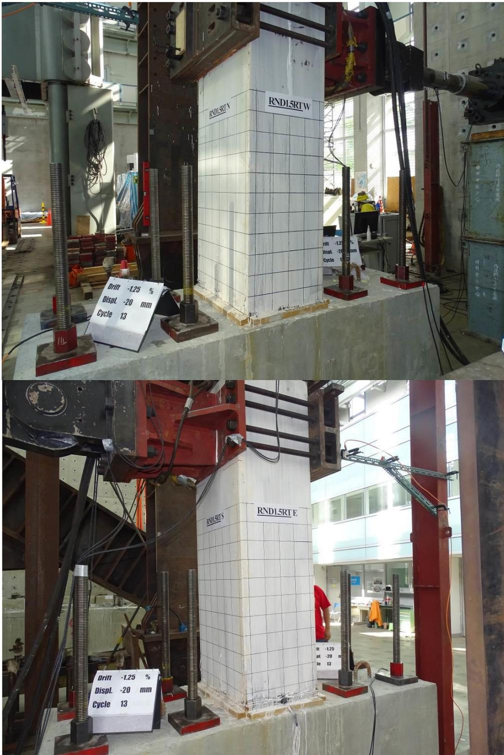
圖 3-70 側移角-1.25 %時 RND1.5RT 試體照片
