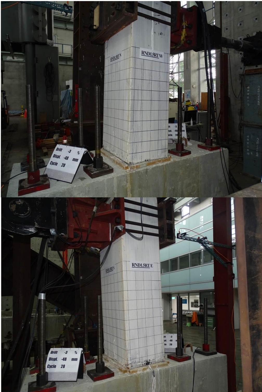
圖 3-80 側移角-3.0 %時 RND1.5RT 試體照片
