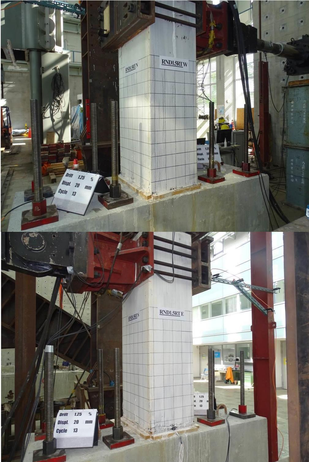
圖 3-69 側移角 1.25 % 時 RND1.5RT 試體照片
