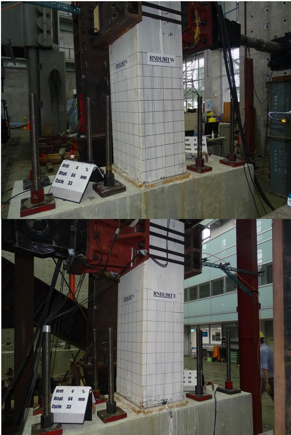
圖 3-83 側移角 4.0 %時 RND1.5RT 試體照片
