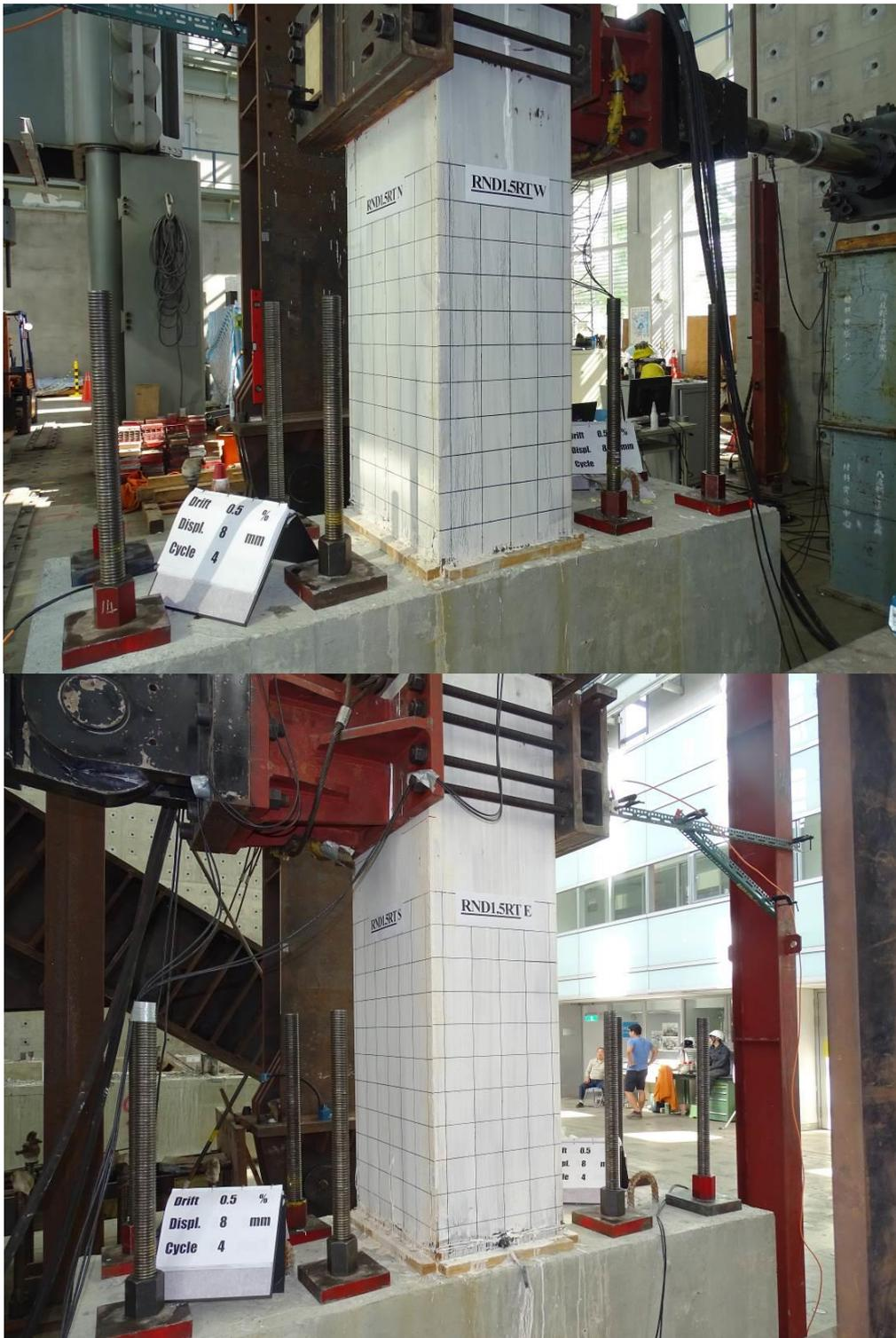
圖 3-63 側移角 0.5 %時 RND1.5RT 試體照片
