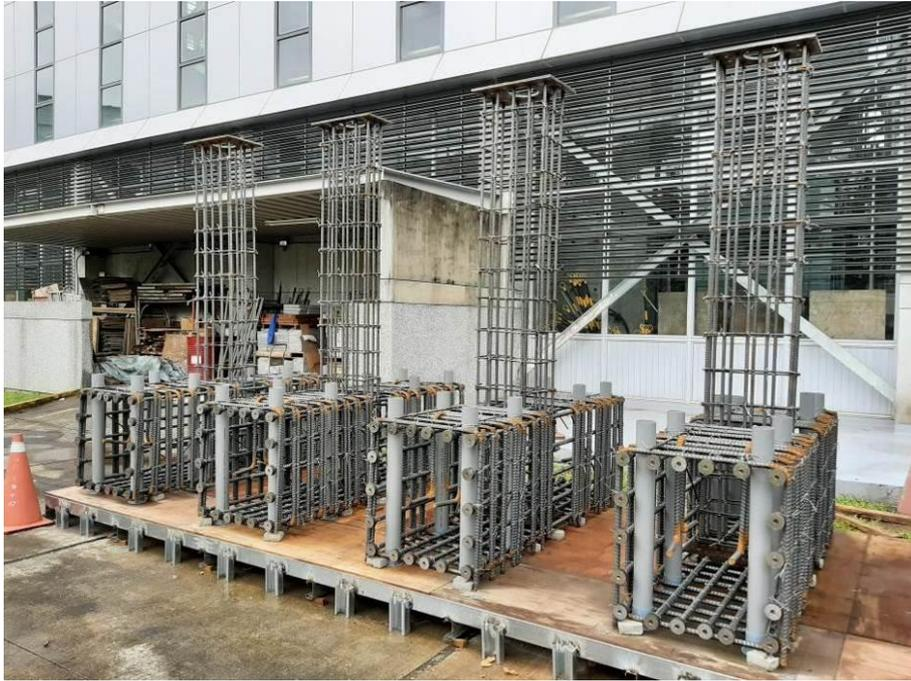
圖 3-4 試體鋼筋組立(基礎及柱)
