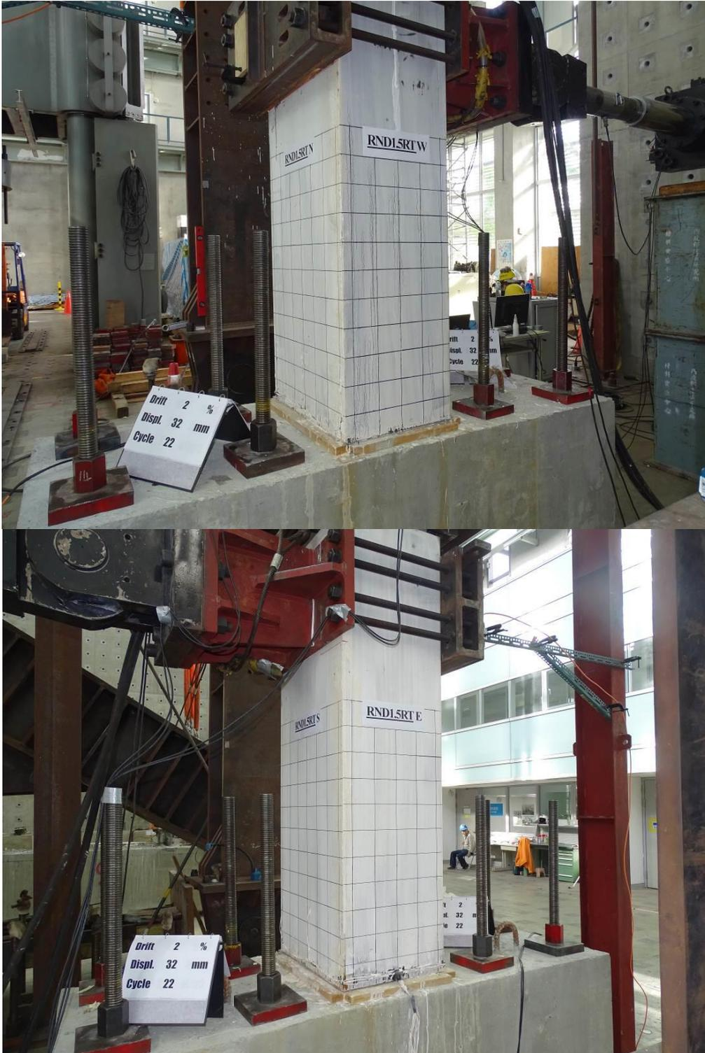
圖 3-75 側移角 2.0 %時 RND1.5RT 試體照片
