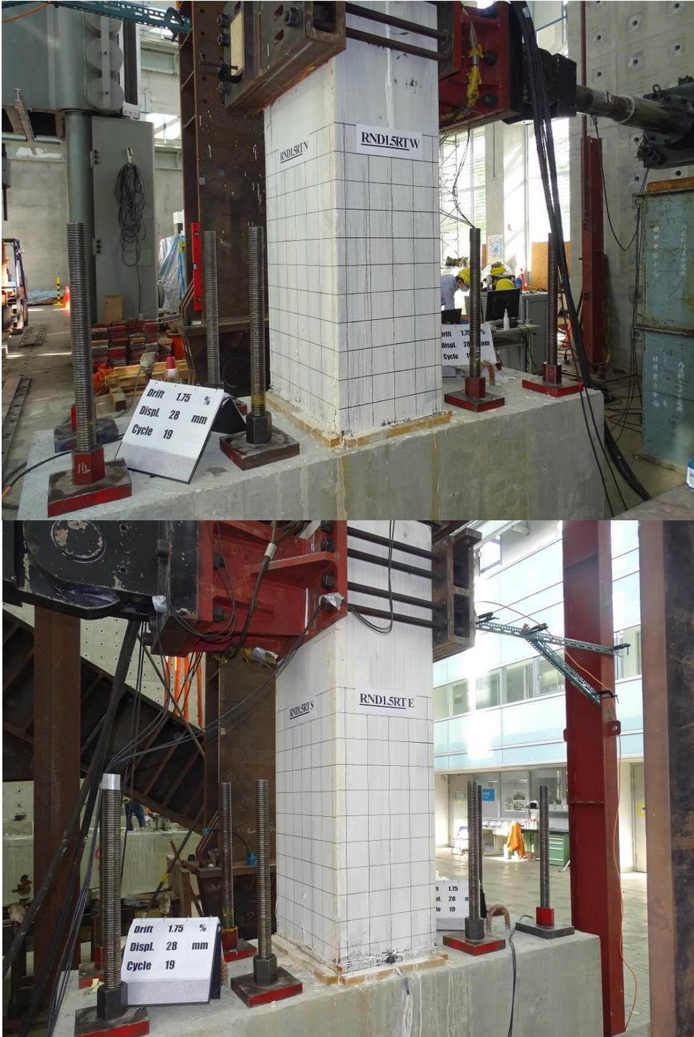
圖 3-73 側移角 1.75 % 時 RND1.5RT 試體照片
