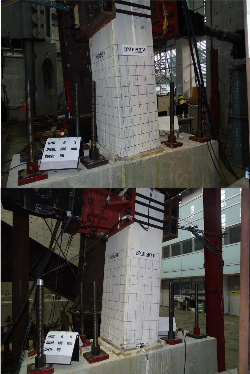
圖 3-95 側移角 9.0 % 時 RND1.5RT 試體照片
