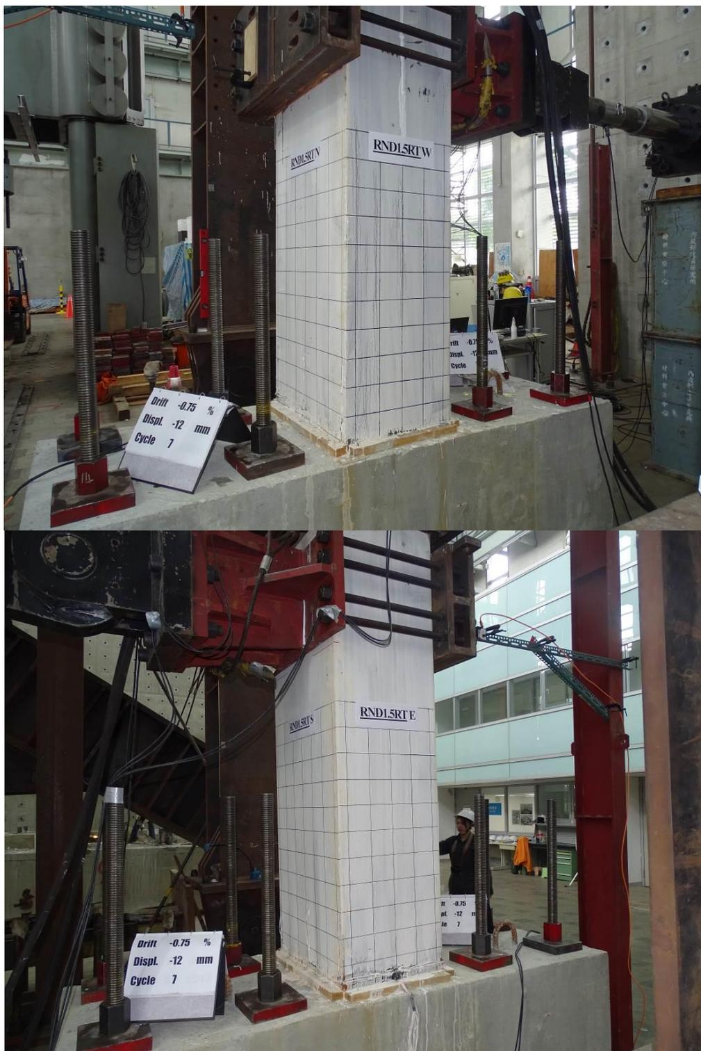
圖 3-66 側移角-0.75 %時 RND1.5RT 試體照片
