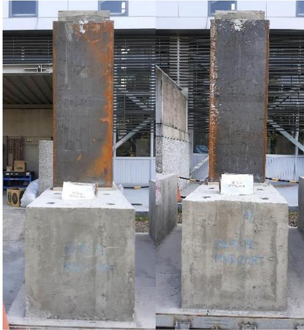
圖 3-10 鋼板補強試體加裝鋼板及灌入無收縮砂漿
