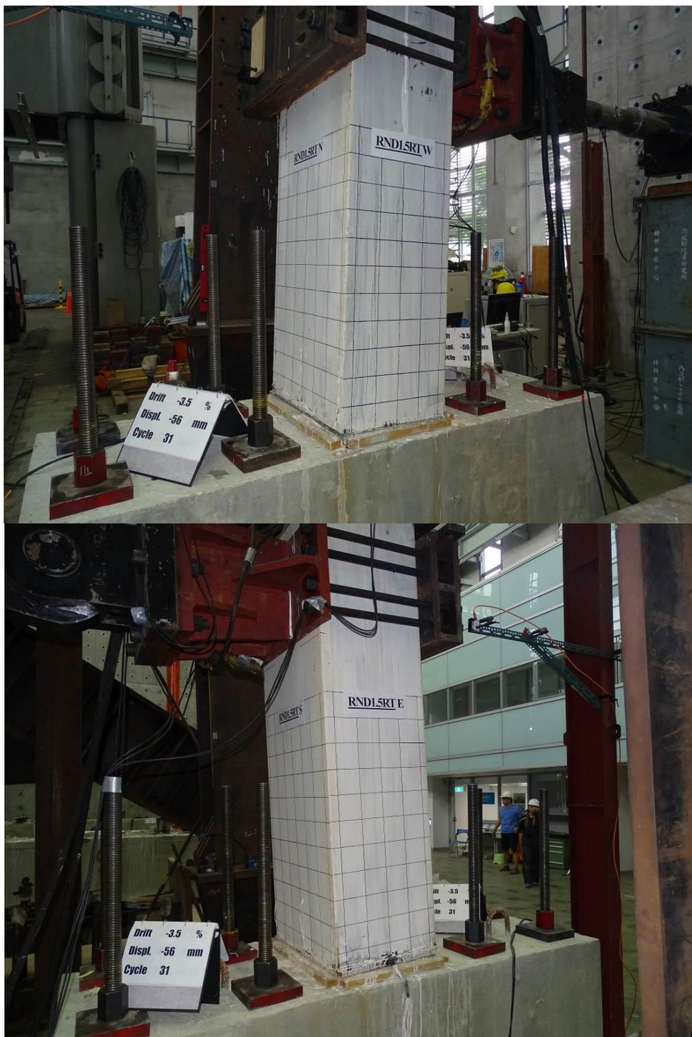
圖 3-82 側移角-3.5 %時 RND1.5RT 試體照片
