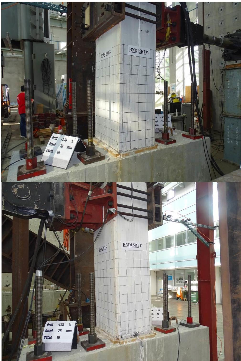
圖 3-74 側移角-1.75 %時 RND1.5RT 試體照片
