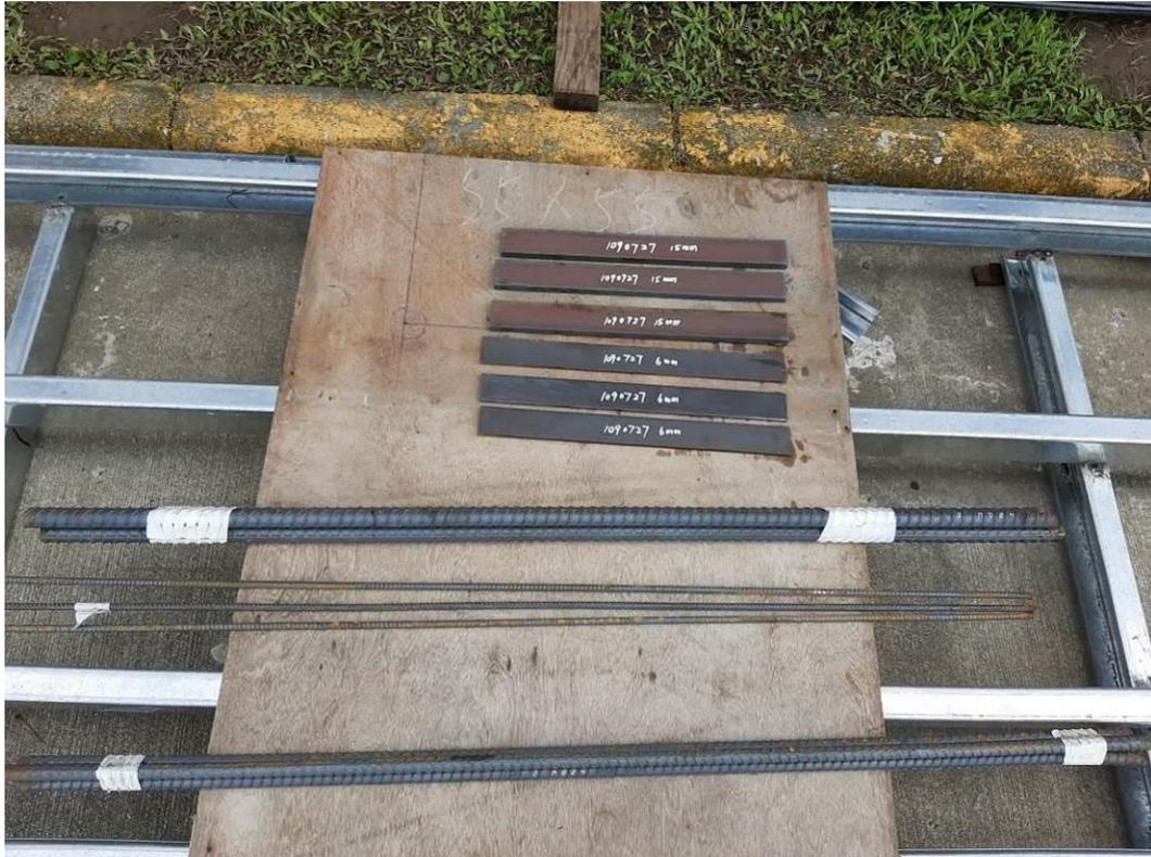
圖 3-2 試體鋼筋及鋼板 7/27 取樣送驗
