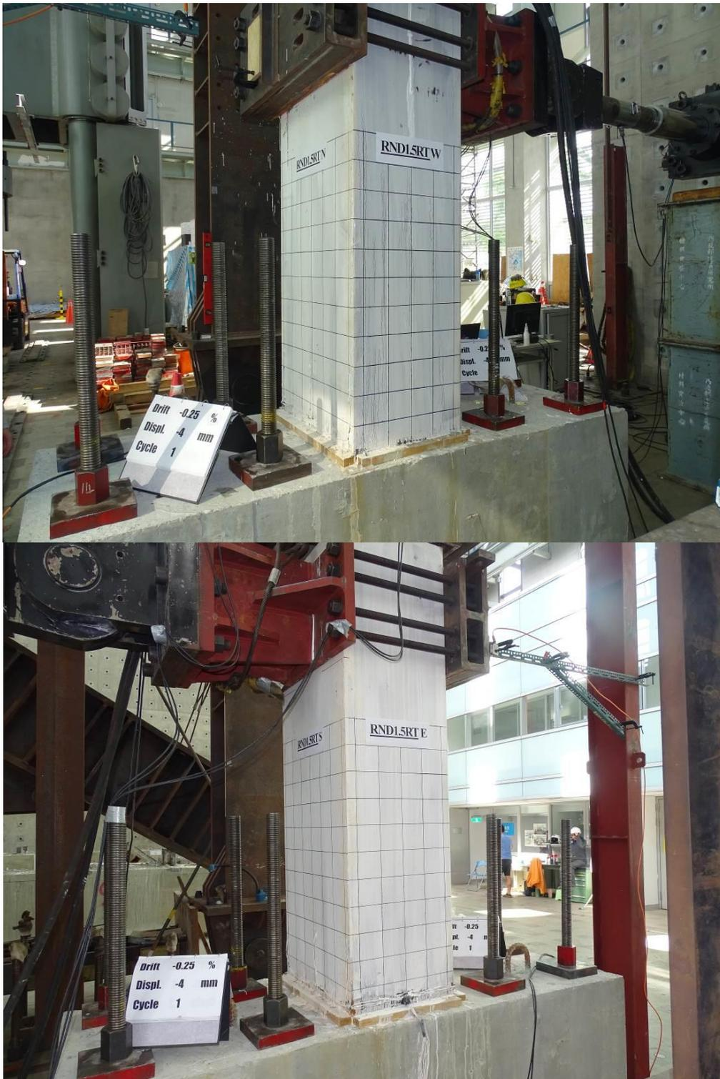
圖 3-62 側移角-0.25 %時 RND1.5RT 試體照片
