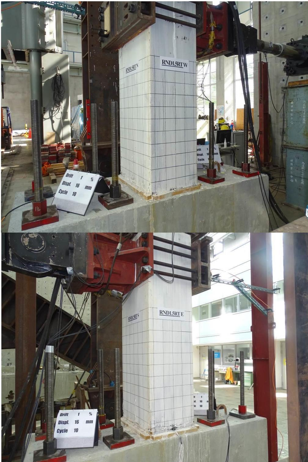
圖 3-67 側移角 1.0 % 時 RND1.5RT 試體照片
