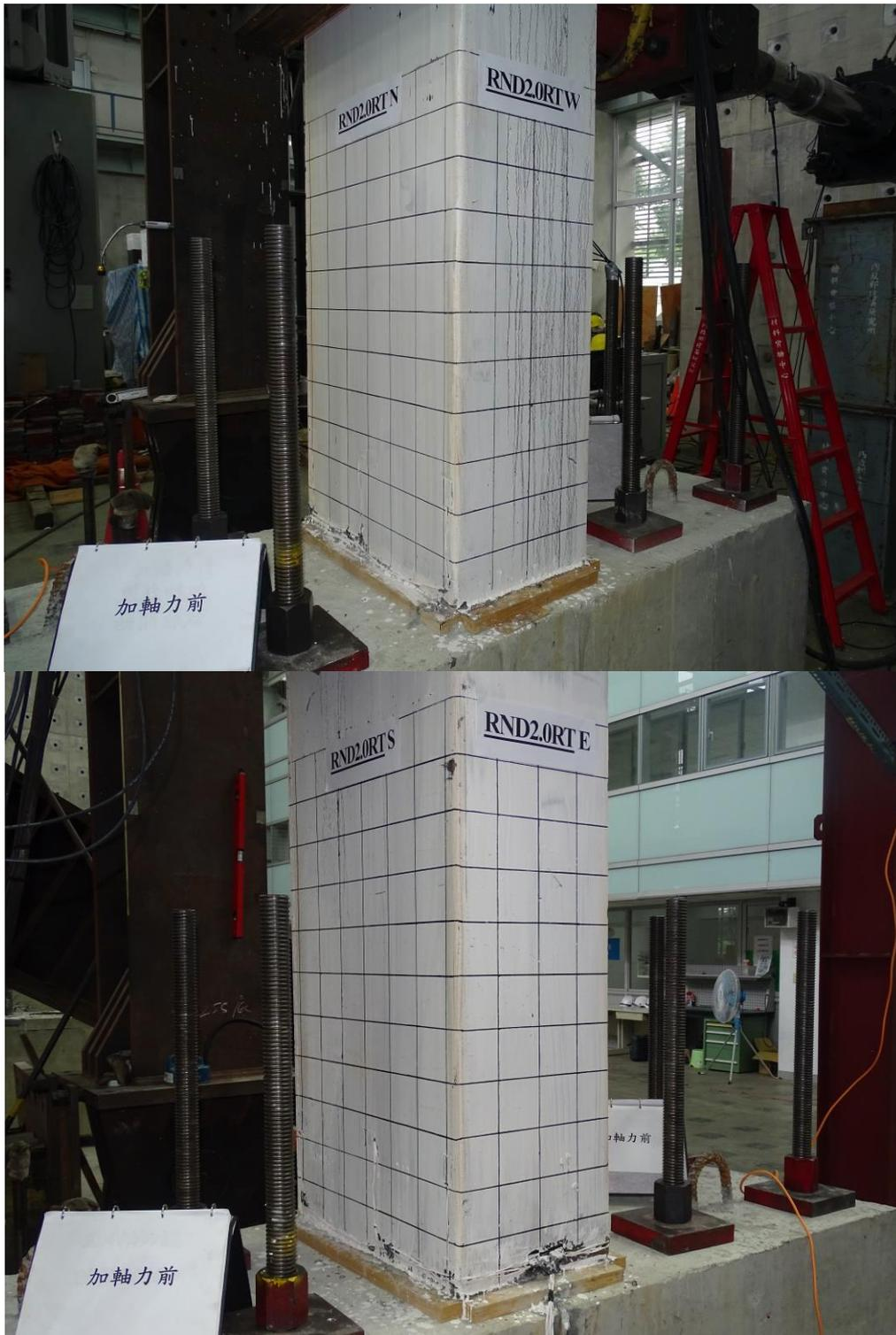
圖 3-98 加軸力前 RND2.0RT 試體照片
