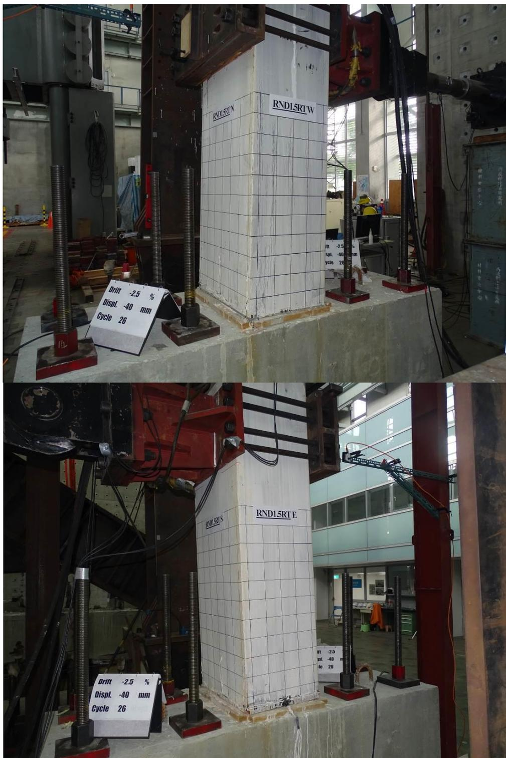
圖 3-78 側移角-2.5 %時 RND1.5RT 試體照片
