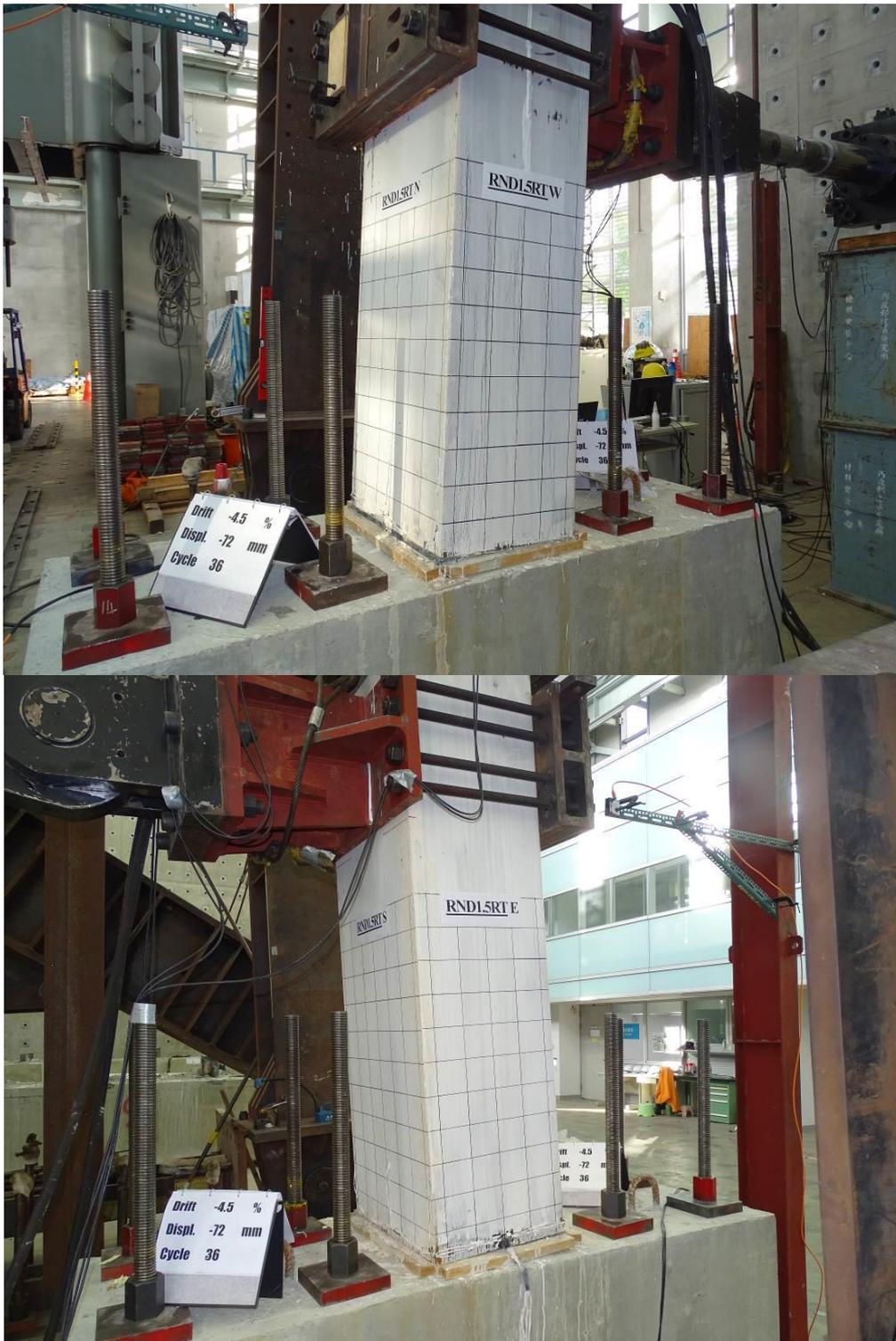
圖 3-86 側移角-4.5 %時 RND1.5RT 試體照片
