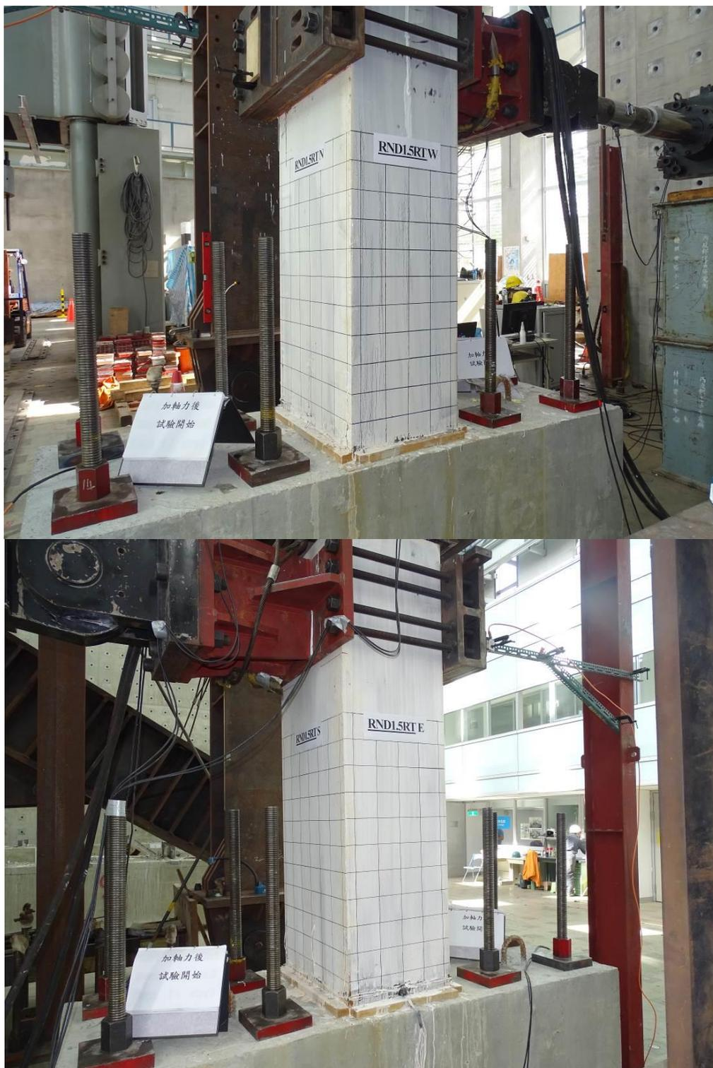
圖 3-60 加軸力後側移角 0 % 時 RND1.5RT 試體照片
