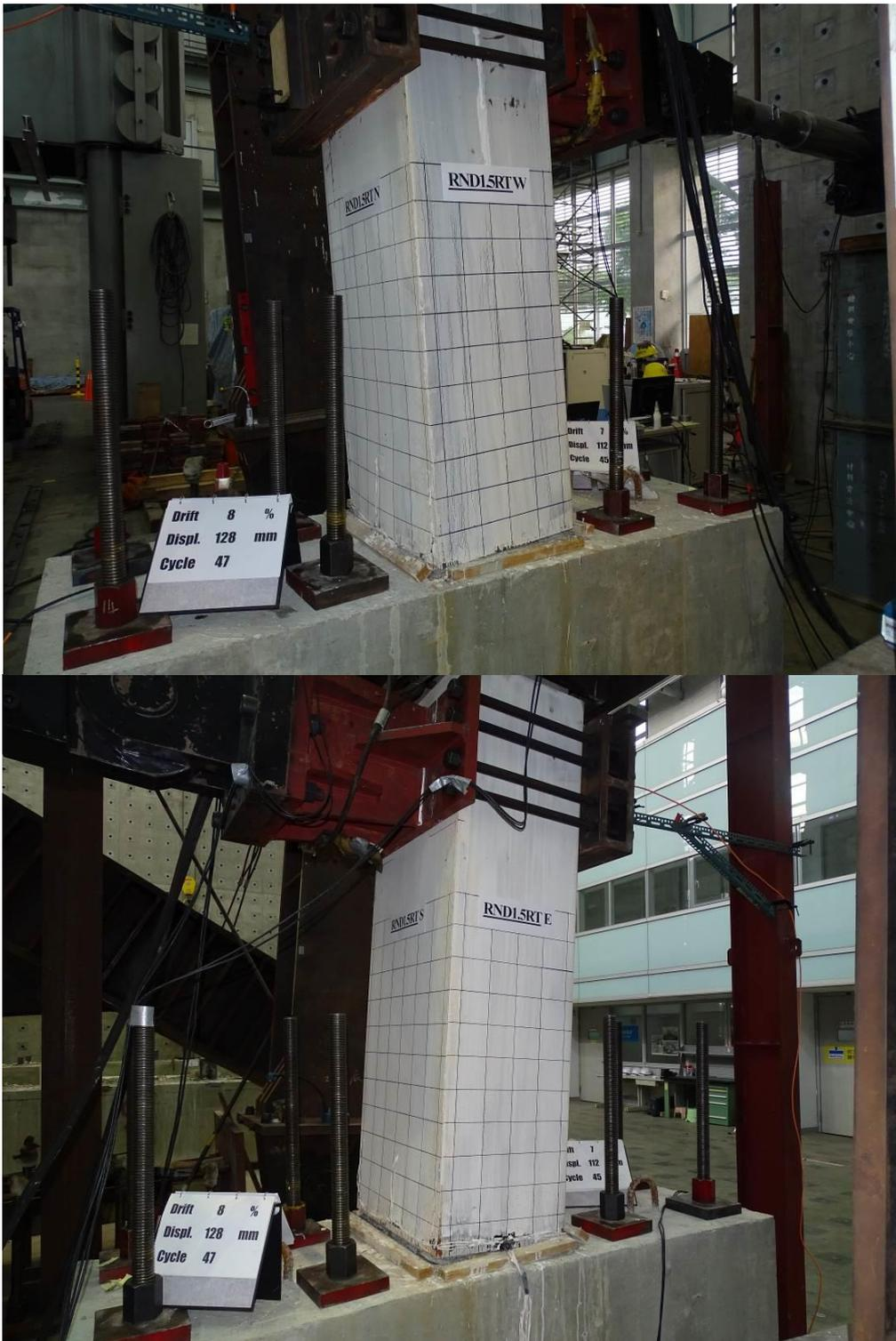
圖 3-93 側移角 8.0 %時 RND1.5RT 試體照片
