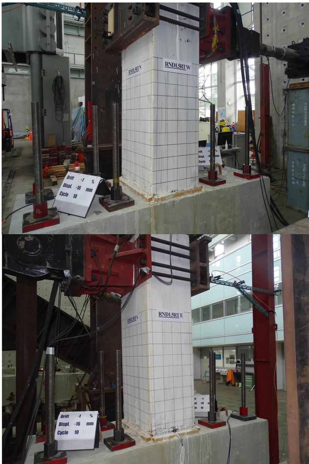
圖 3-68 側移角-1.0 %時 RND1.5RT 試體照片
