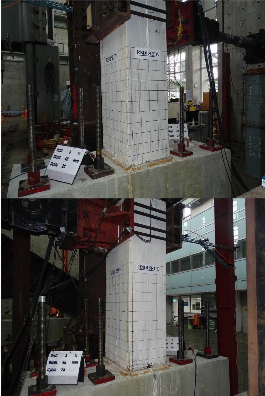
圖 3-79 側移角 3.0 % 時 RND1.5RT 試體照片
