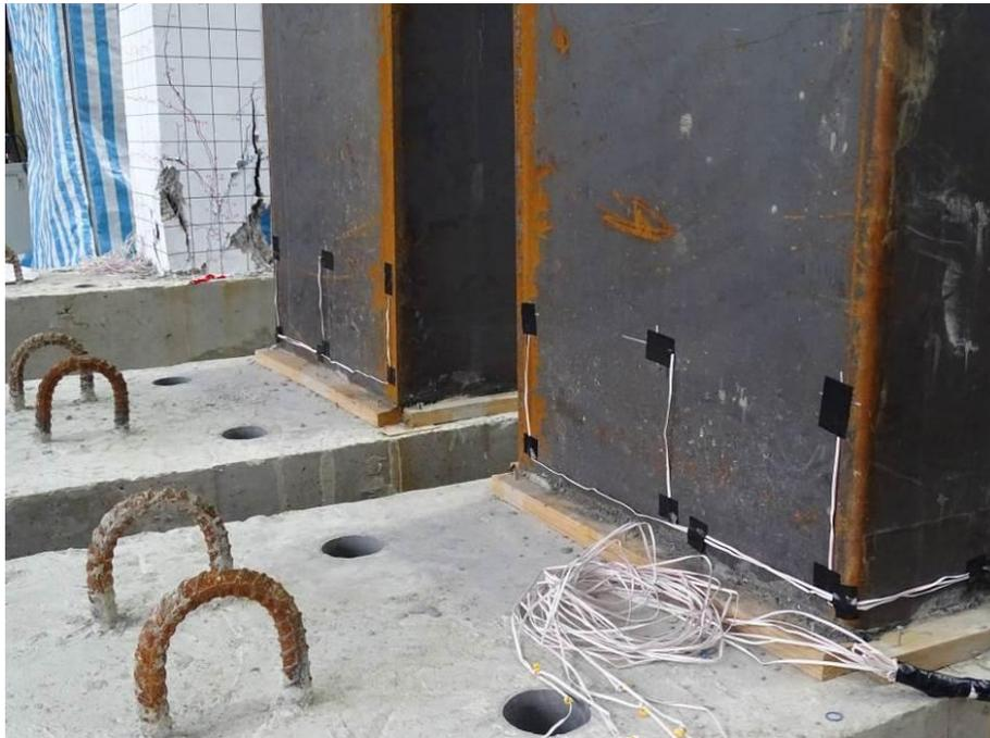
圖 3-11 鋼板補強試體之鋼板表面應變規黏貼
