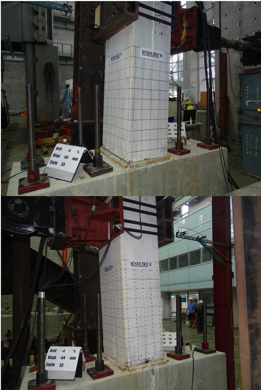
圖 3-84 側移角-4.0 %時 RND1.5RT 試體照片
