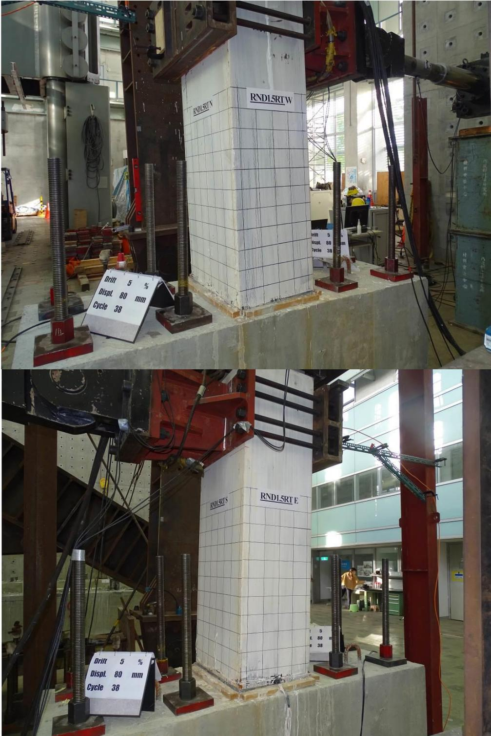
圖 3-87 側移角 5.0 % 時 RND1.5RT 試體照片
