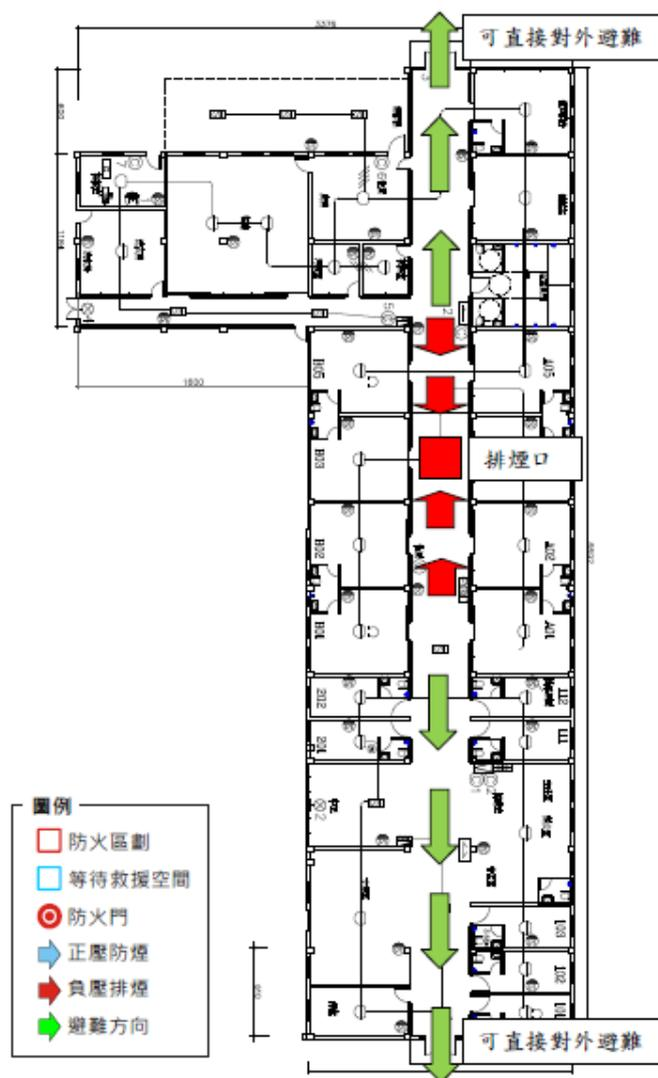
圖 3-5 某老人長照中心(中央核心型)排煙設計建議示意圖
