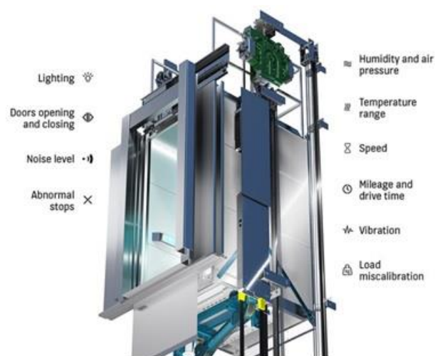
圖 5:電梯上的傳感器收集數據並將其發送到 IBM 3
