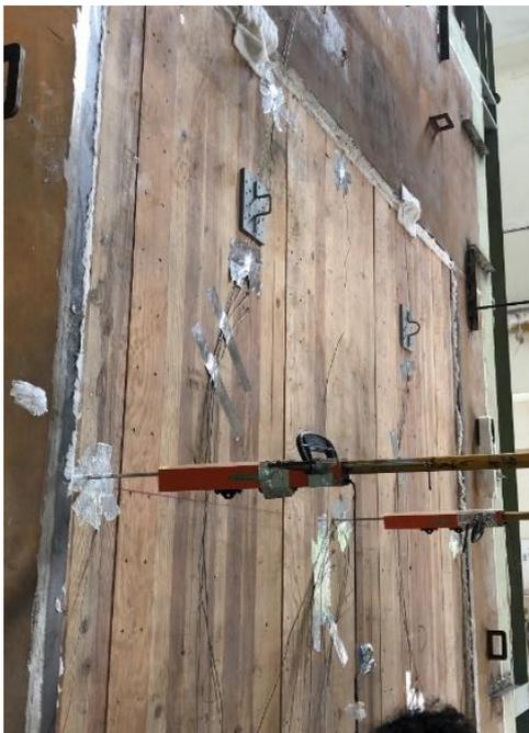
圖3-35 水平位移及自由端位移架設完成。
