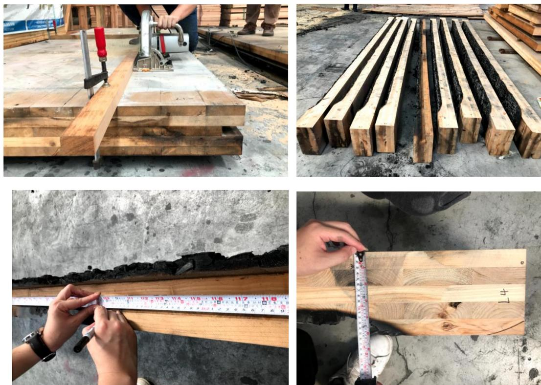
圖4-9 試體分割流程
