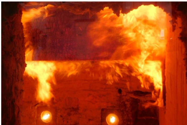
圖3-4 梁、柱複合耐火試驗爐
