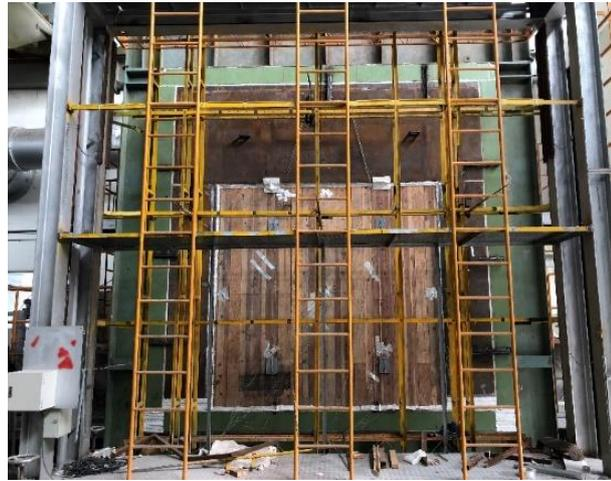
圖3-34 設置好 2 處垂直位移後，將黃色鐵架移動到試體前方，並開始設置另外 2 處之水平位移。
