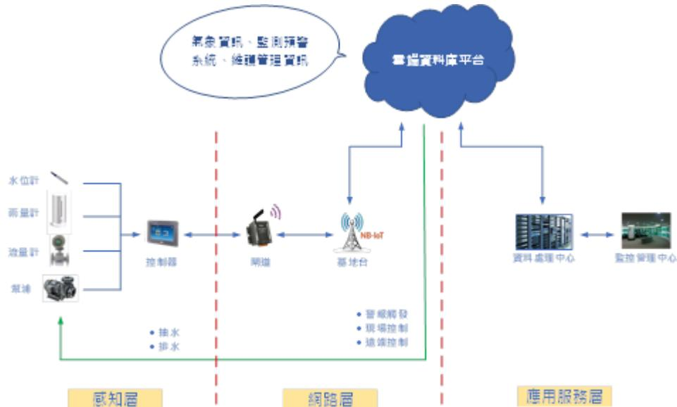
圖 1-1 智慧雨水貯集系統兩洪管理系統規劃示意圖
