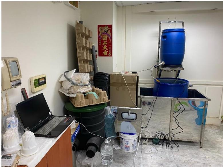
圖 3-8 慧雨水貯集系統雨洪管理之物理試驗圖
