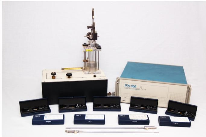
圖 4-3 IFA-300 智慧型風速儀、探針及校正儀
