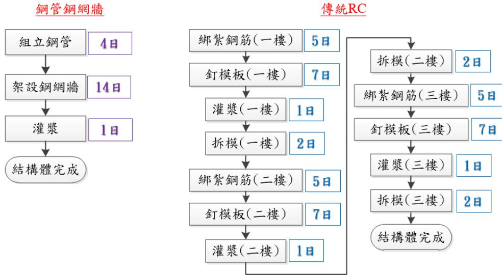
圖 2.1 案例施工流程及時間分析
