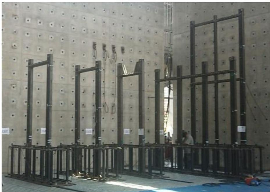
圖 3.12 鋼管骨架完成
