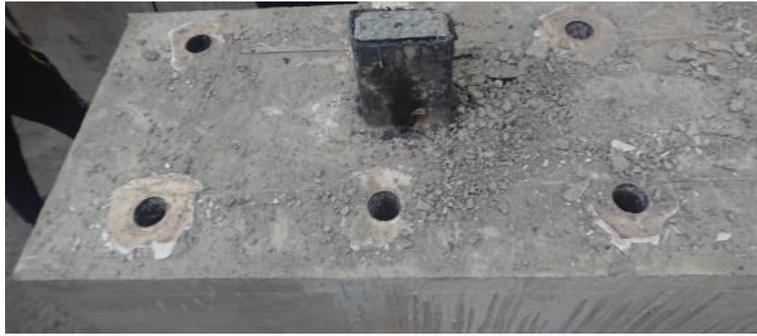
圖 4.24 2×2 試體鋼管內混凝土填充狀況
