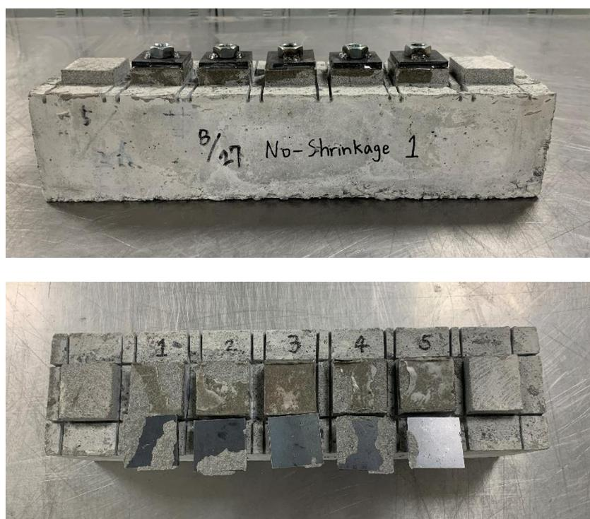
圖 4-35 無收縮水泥砂漿試體於 28 天齡期下黏結強度試驗照片
