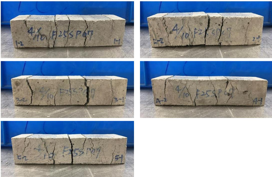
圖 4-27 F25SP07 之 28 天齡期下撓曲及抗壓試驗照片
