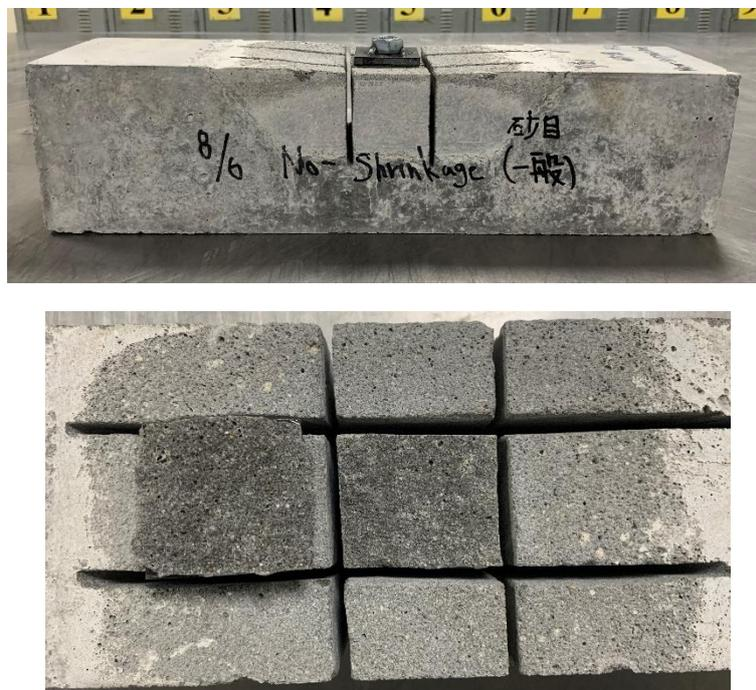
圖 4-52 無收縮水泥砂漿之 28 天齡期下表面粗糙度為砂目之黏結強度試驗照片
