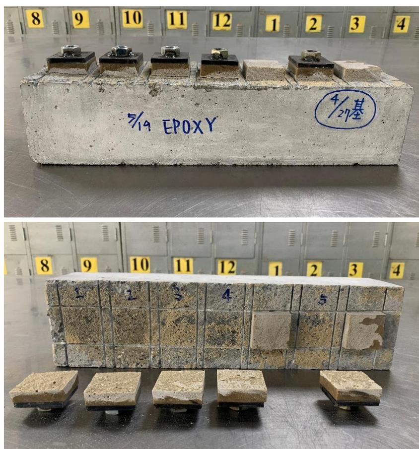
圖 4-41 環氧樹脂砂漿試體於 28 天齡期下黏結強度試驗照片
