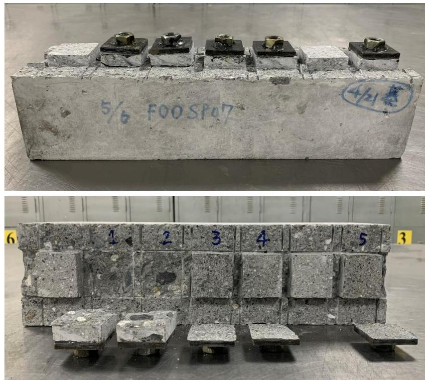
圖 4-23 F00SP07 之 28 天齡期下黏結強度試驗照片
