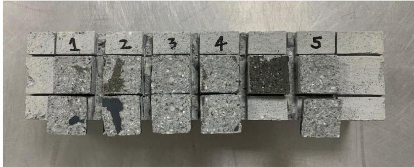
圖 4-12 F00SP00 之 7 天循環齡期下黏結強度試驗照片
