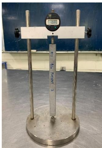
圖 3-5 長度變化試驗儀器
