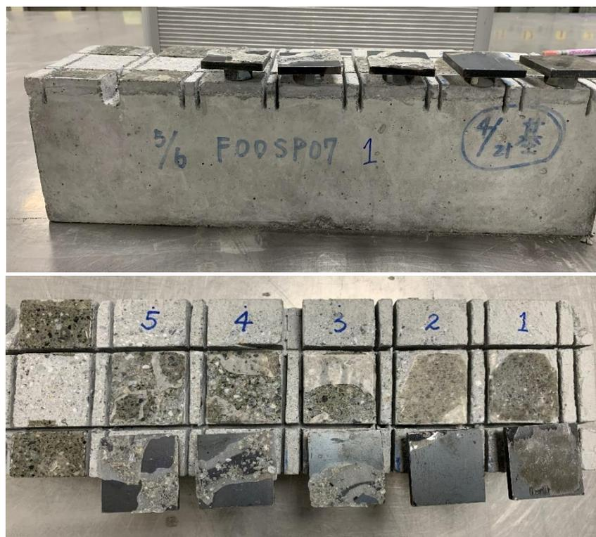
圖 4-22 F00SP07 之 7 天齡期下黏結強度試驗照片
