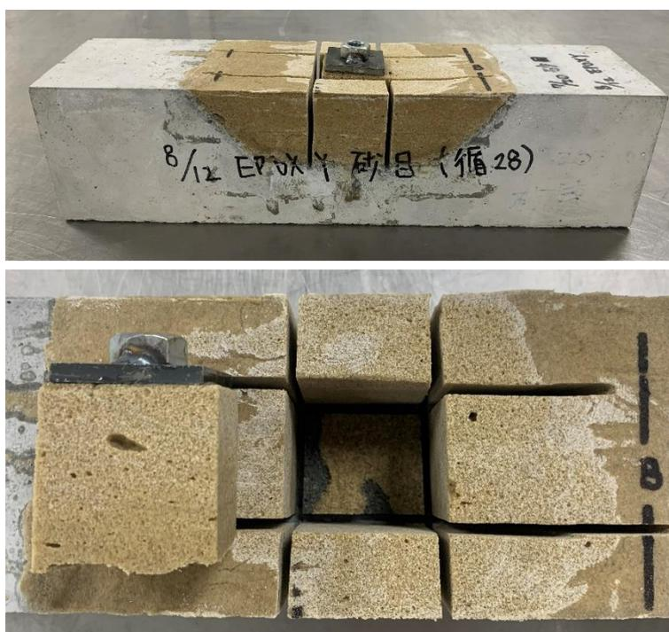
圖 4-58 環氧樹脂砂漿之 28 天循環齡期下表面粗糙度為中間之黏結強度試驗照片
