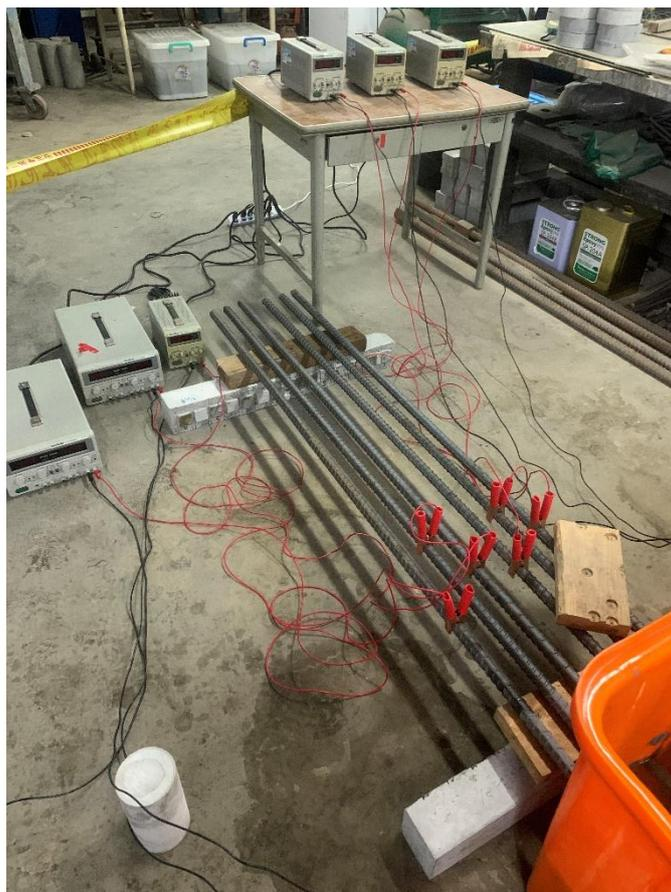
圖 3- 20 正極接於水箱外之鋼筋
