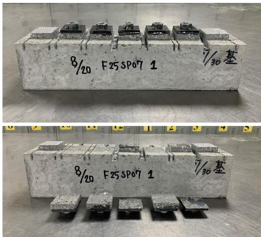
圖 4-30 F25SP07 之 7 天循環齡期下黏結強度試驗照片
