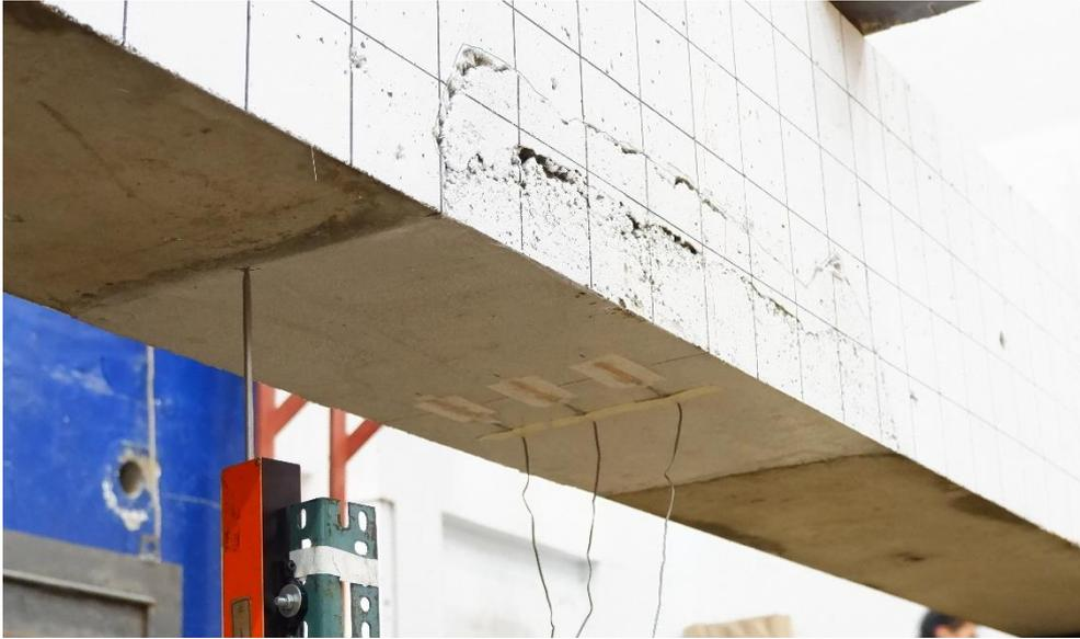
圖 4- 59 由水泥砂漿修復之鋼筋腐蝕梁構件達變位角 0.1 %之修復區域
