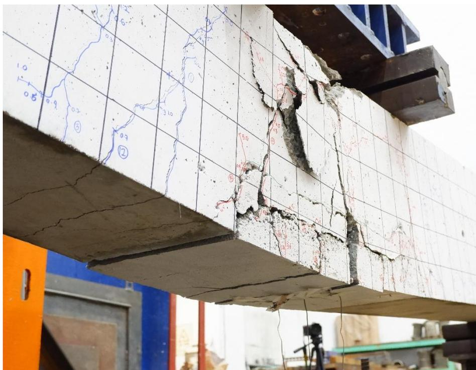
圖 4- 62 由水泥砂漿修復之鋼筋腐蝕梁構件達破壞時之修復區域
