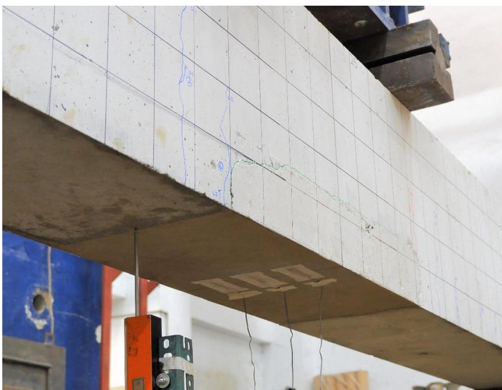
圖 4- 65 由環氧砂漿修復之鋼筋腐蝕梁構件達變位角 0.2 %之修復區域
