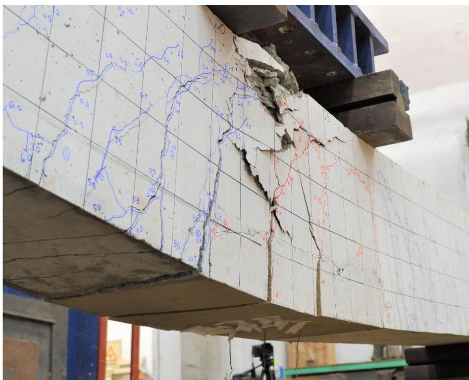
圖 4- 69 由環氧砂漿修復之鋼筋腐蝕梁構件達變位角破壞時之修復區域
