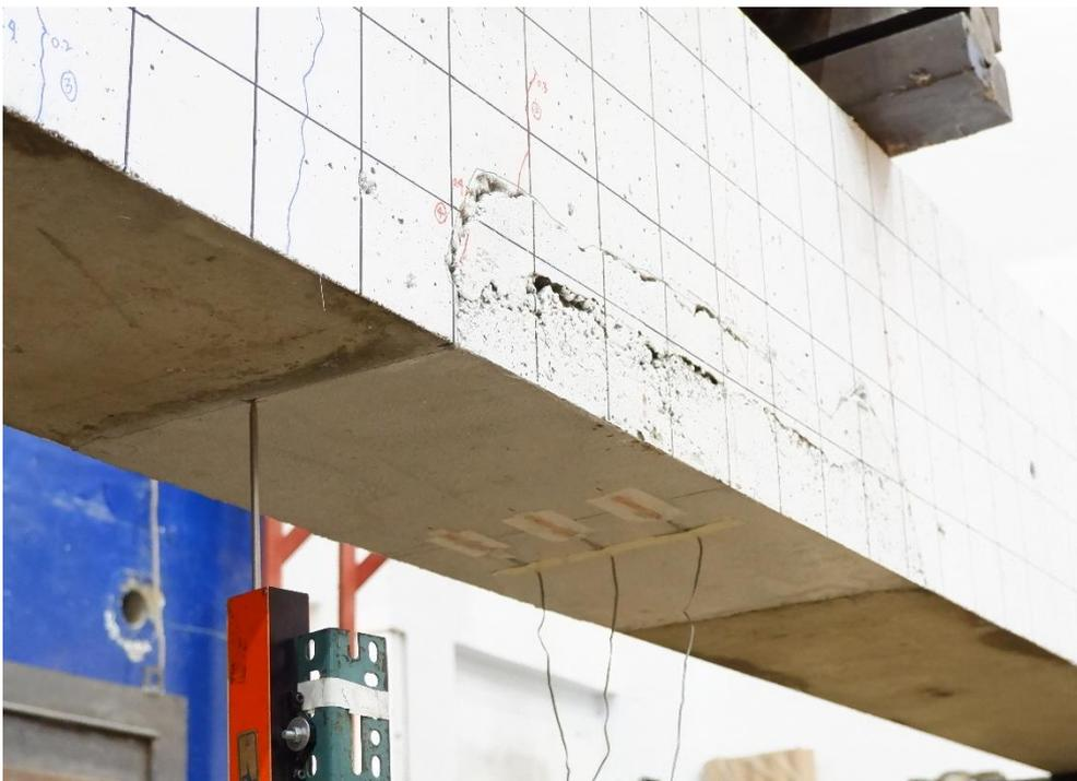
圖 4- 60 由水泥砂漿修復之鋼筋腐蝕梁構件達變位角 0.4 %之修復區域
