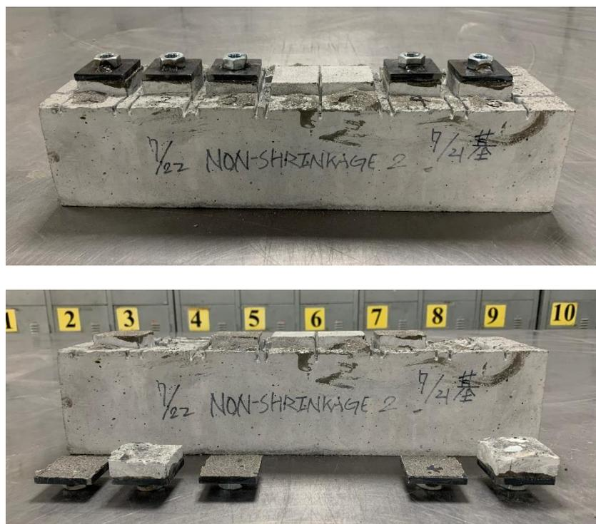
圖 4-34 無收縮水泥砂漿試體於 7 天齡期下黏結強度試驗照片
