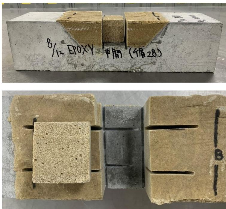
圖 4-57 環氧樹脂砂漿之 28 天循環齡期下表面粗糙度為中間之黏結強度試驗照片
