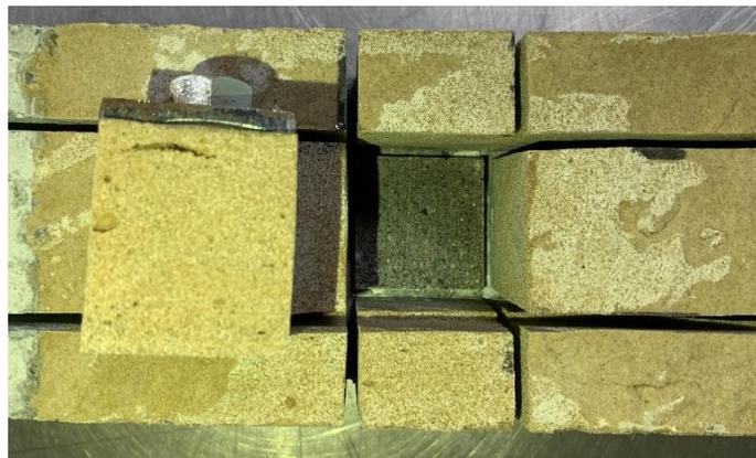
圖 4-56 環氧樹脂砂漿之 28 天齡期下表面粗糙度為砂目之黏結強度試驗照片
