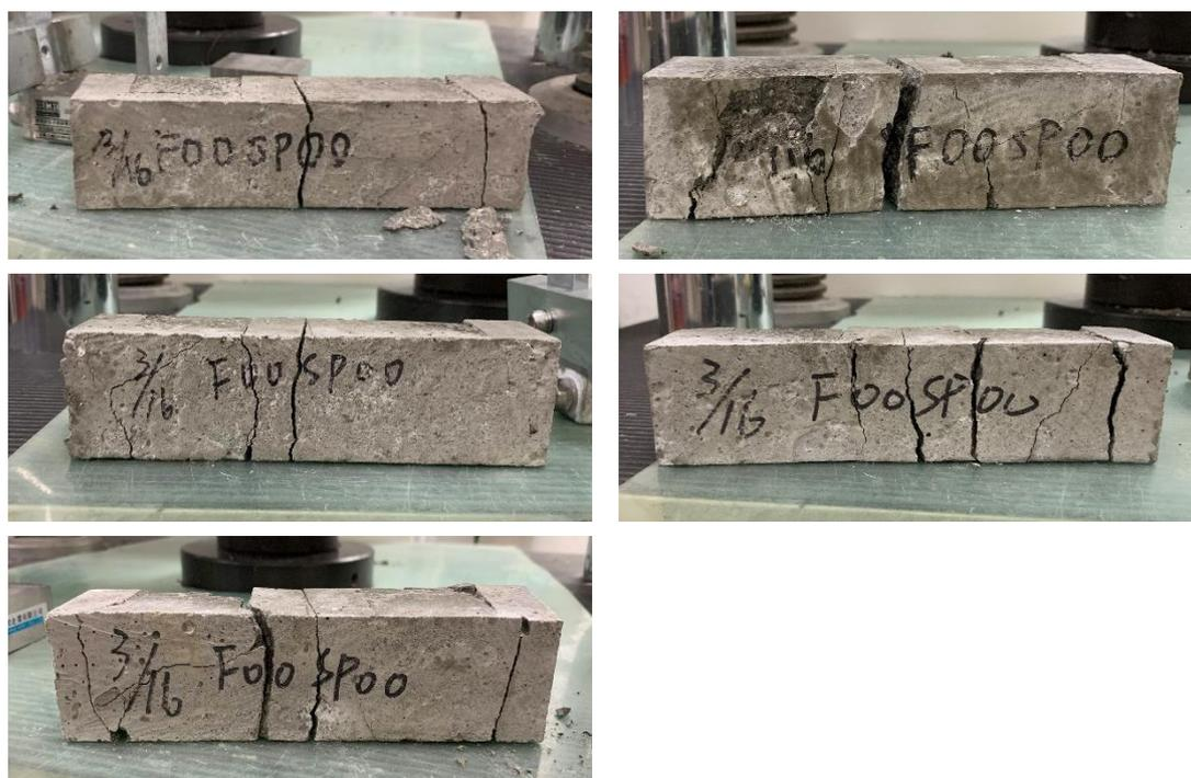
圖 4-8 F00SP00 之 7 天齡期下撓曲及抗壓試驗照片
