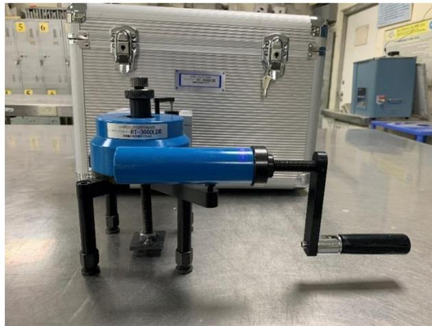
圖 3-4 黏結強度試驗儀器
