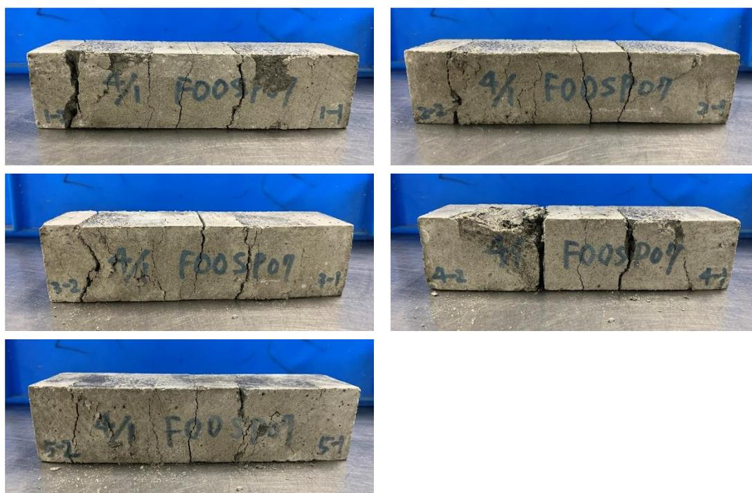
圖 4-20 F00SP07 之 7 天齡期下撓曲及抗壓試驗照片
