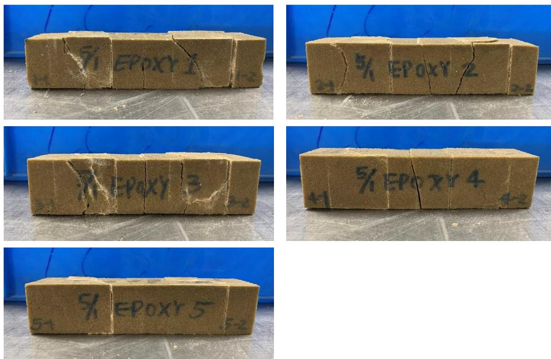
圖 4-38 環氧樹脂砂漿試體於 7 天齡期下撓曲及抗壓試驗照片
