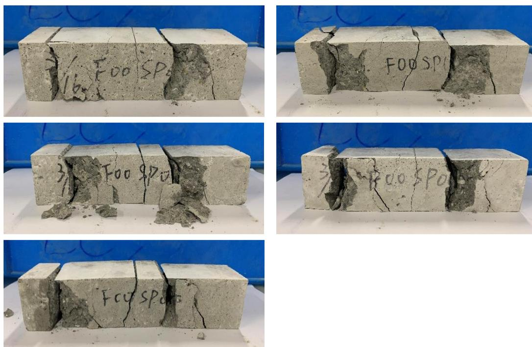
圖 4-9 F00SP00 之 28 天齡期下撓曲及抗壓試驗照片
