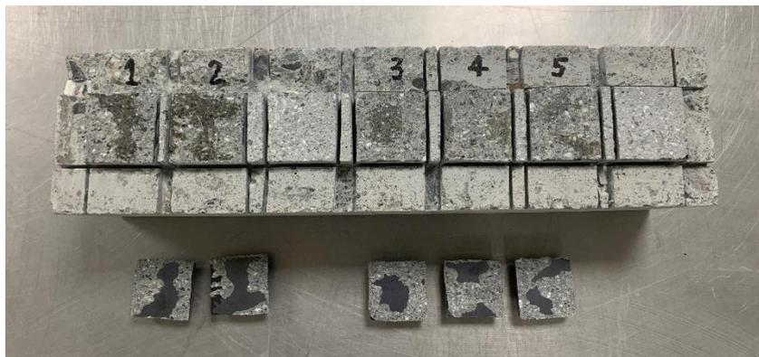
圖 4-13 F00SP00 之 28 天循環齡期下黏結強度試驗照片
