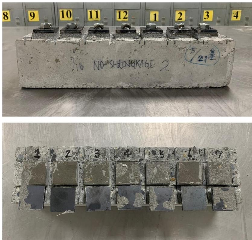
圖 4-37 無收縮水泥砂漿試體於 28 天循環齡期下黏結強度試驗照片
