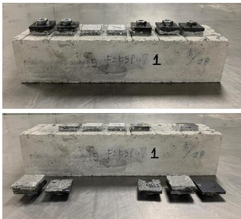
圖 4-31 F25SP07 之 28 天循環齡期下黏結強度試驗照片
