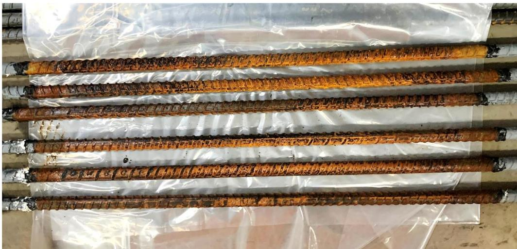
圖 3- 23 本研究鋼筋腐蝕狀態
