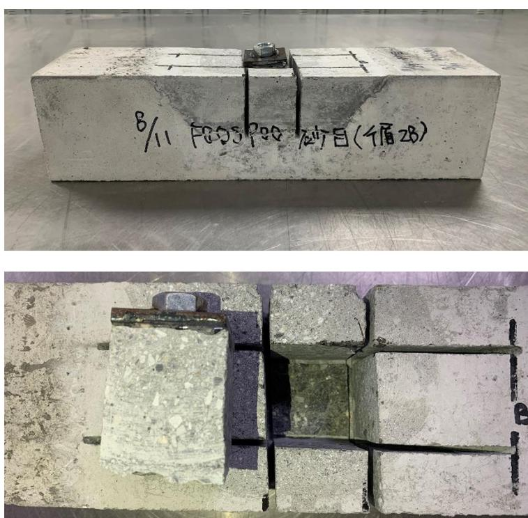
圖 4-46 F00SP00 之 28 天循環齡期下表面粗糙度為砂目之黏結強度試驗照片
