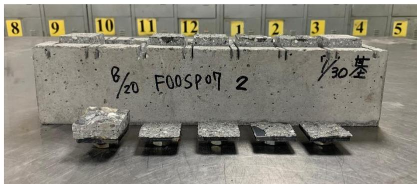
圖 4- 24 F00SP07 之 7 天循環齡期下黏結強度試驗照片
