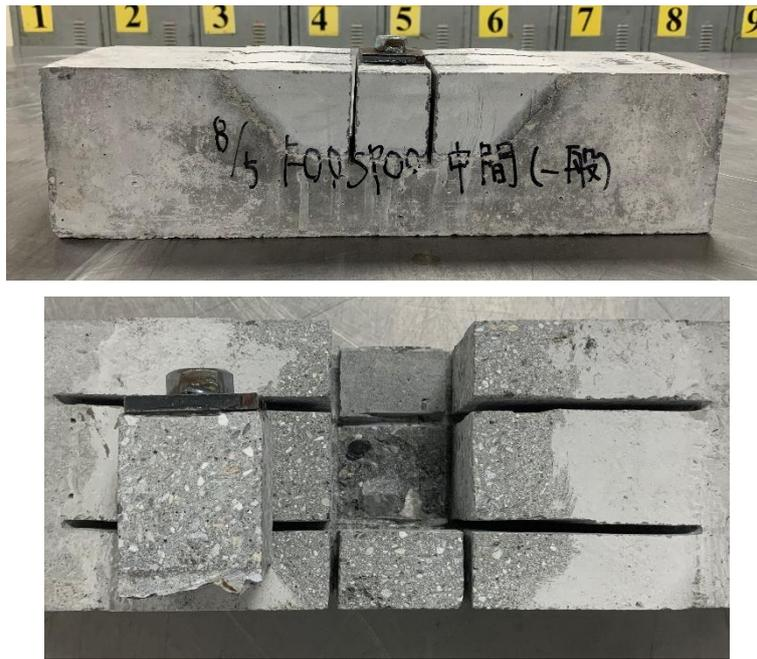
圖 4-43 F00SP00 之 28 天齡期下表面粗糙度為中間之黏結強度試驗照片
