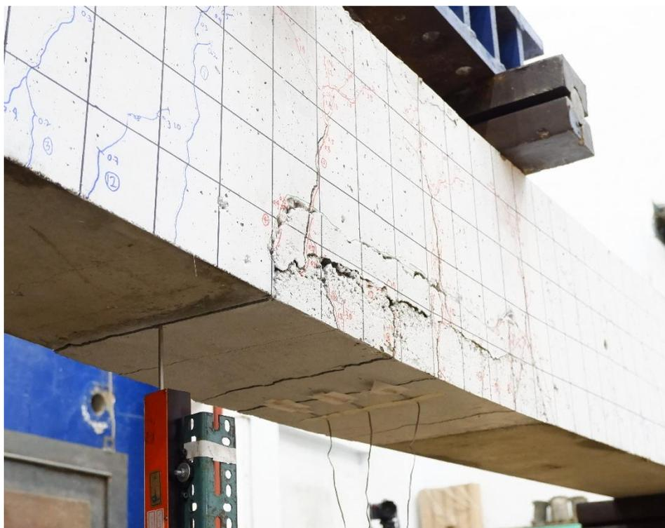
圖 4- 61 由水泥砂漿修復之鋼筋腐蝕梁構件達變位角 3.5 %之修復區域
