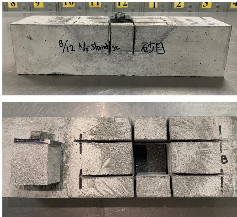
圖 4-54 無收縮水泥砂漿之 28 天循環齡期下表面粗糙度為砂目之黏結強度試驗照片
