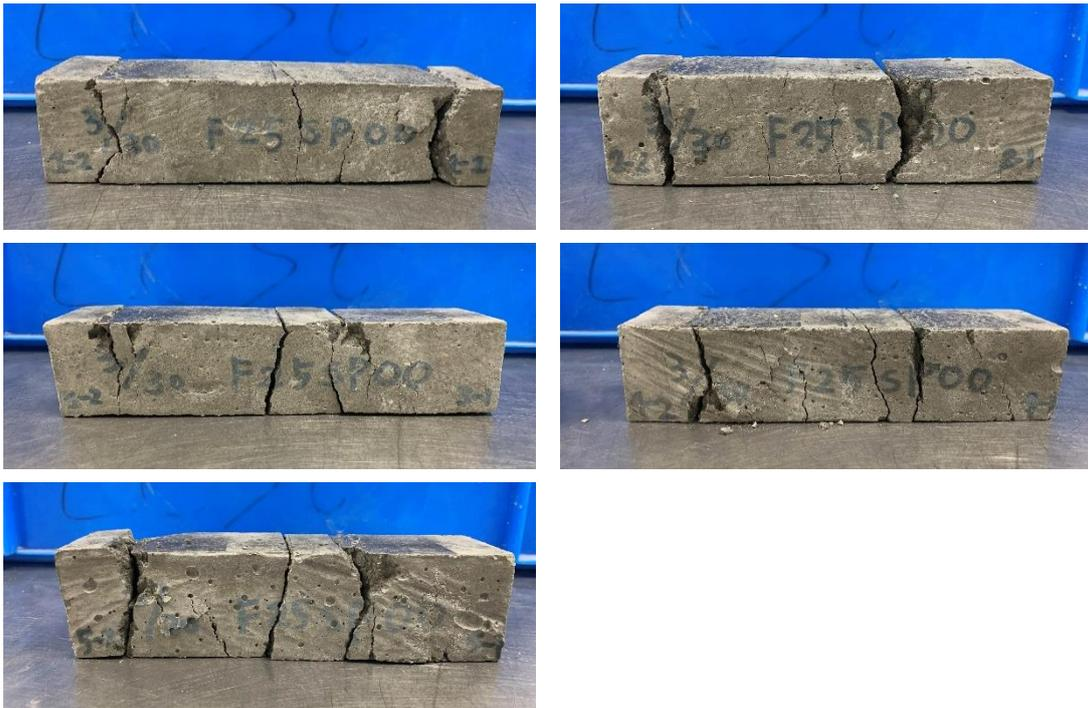
圖 4-14 F25SP00 之 7 天齡期下撓曲及抗壓試驗照片
