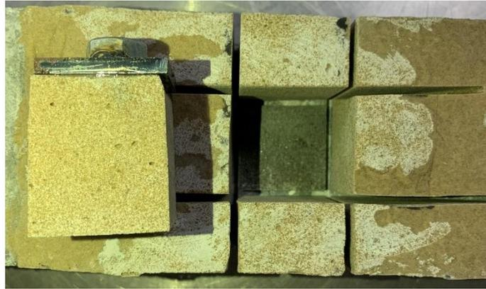
圖 4-55 環氧樹脂砂漿之 28 天齡期下表面粗糙度為中間之黏結強度試驗照片
