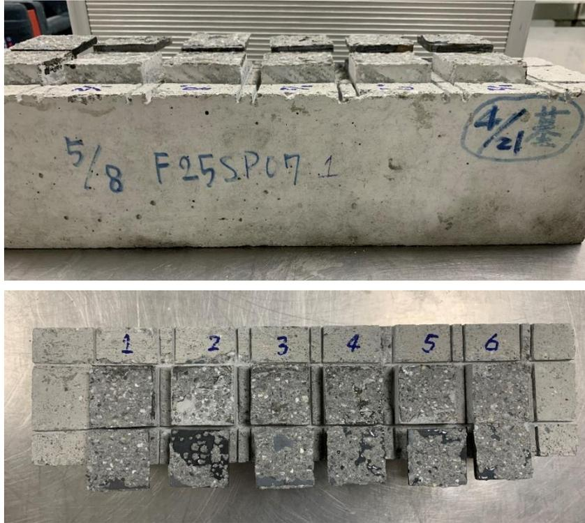
圖 4-28 F25SP07 之 7 天齡期下黏結強度試驗照片
