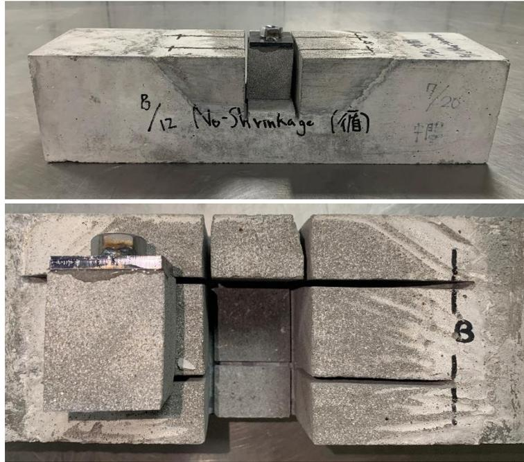
圖 4-53 無收縮水泥砂漿之 28 天循環齡期下表面粗糙度為中間之黏結強度試驗照片
