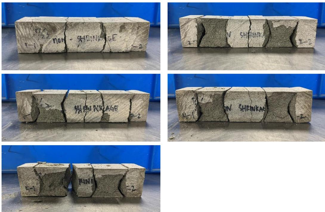
圖 4-33 無收縮水泥砂漿試體於 28 天齡期下撓曲及抗壓試驗照片
