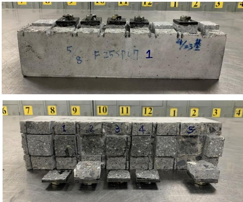
圖 4-29 F25SP07 之 28 天齡期下黏結強度試驗照片
