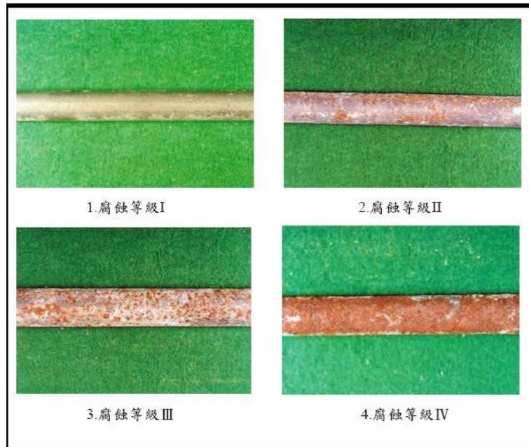
圖 3- 22 鋼筋腐蝕等級目視法
