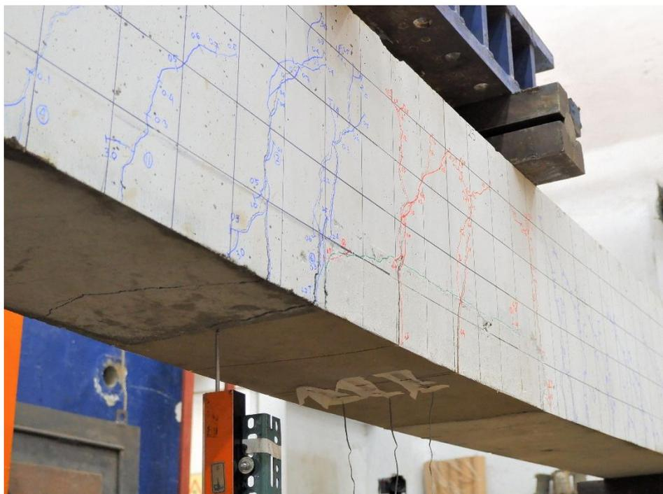
圖 4- 68 由環氧砂漿修復之鋼筋腐蝕梁構件達變位角 3.5 %之修復區域
