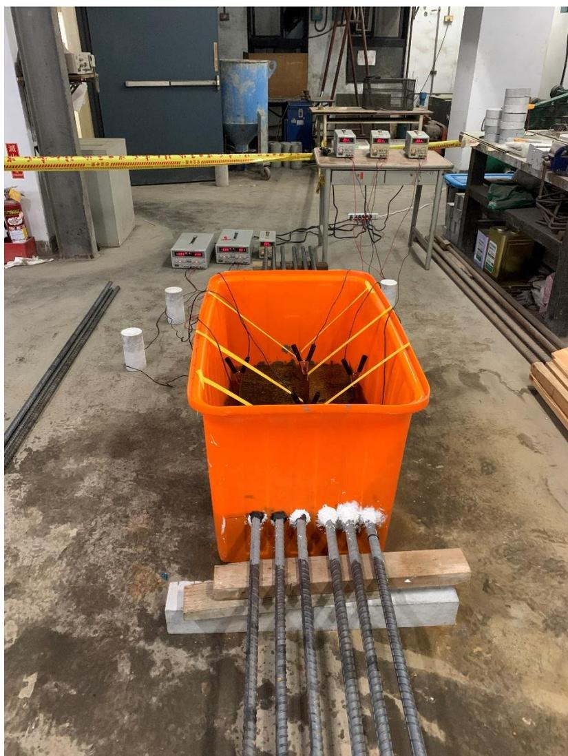
圖 3-16 本研究鋼筋腐蝕之實際配置
