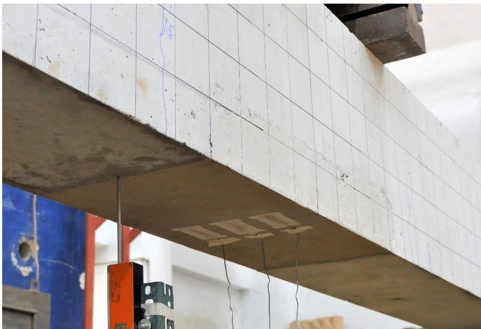
圖 4- 64 由環氧砂漿修復之鋼筋腐蝕梁構件達變位角 0.1 %之修復區域
