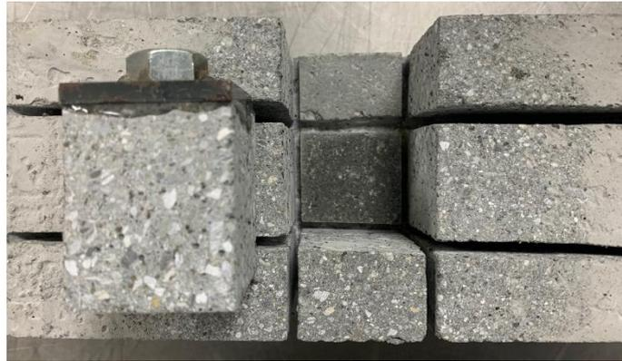
圖 4-47 F25SP07 之 28 天齡期下表面粗糙度為中間之黏結強度試驗照片
