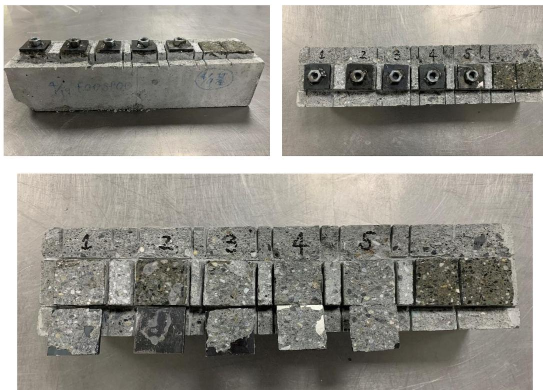
圖 4-10 F00SP00 之 7 天齡期下黏結強度試驗照片
