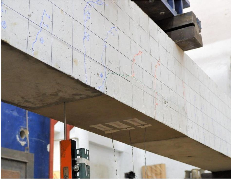
圖 4-66 由環氧砂漿修復之鋼筋腐蝕梁構件達變位角 0.4 %之修復區域
