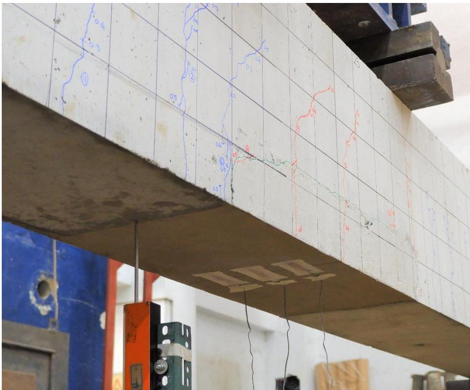
圖 4-67 由環氧砂漿修復之鋼筋腐蝕梁構件達變位角 0.8 %之修復區域
