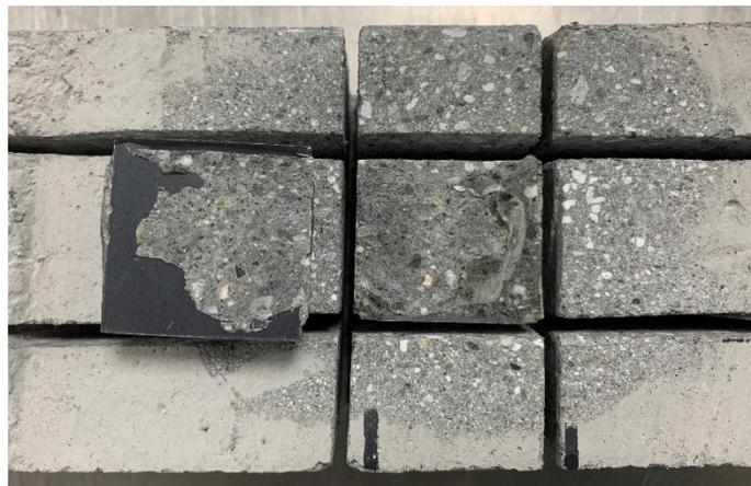
圖 4-48 F25SP07 之 28 天齡期下表面粗糙度為砂目之黏結強度試驗照片
