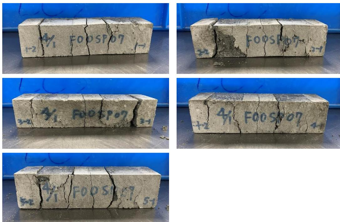
圖 4-21 F00SP07 之 28 天齡期下撓曲及抗壓試驗照片
