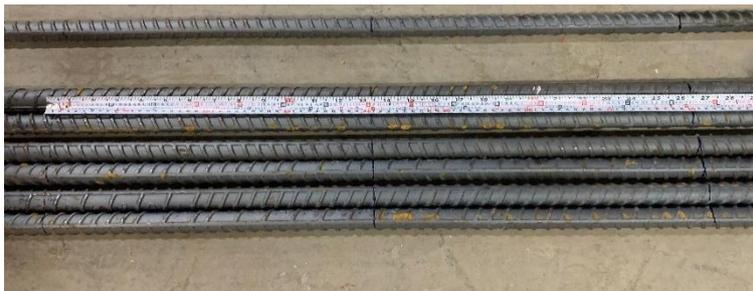
圖 3-17 撓區段鋼筋量測 80 公分
