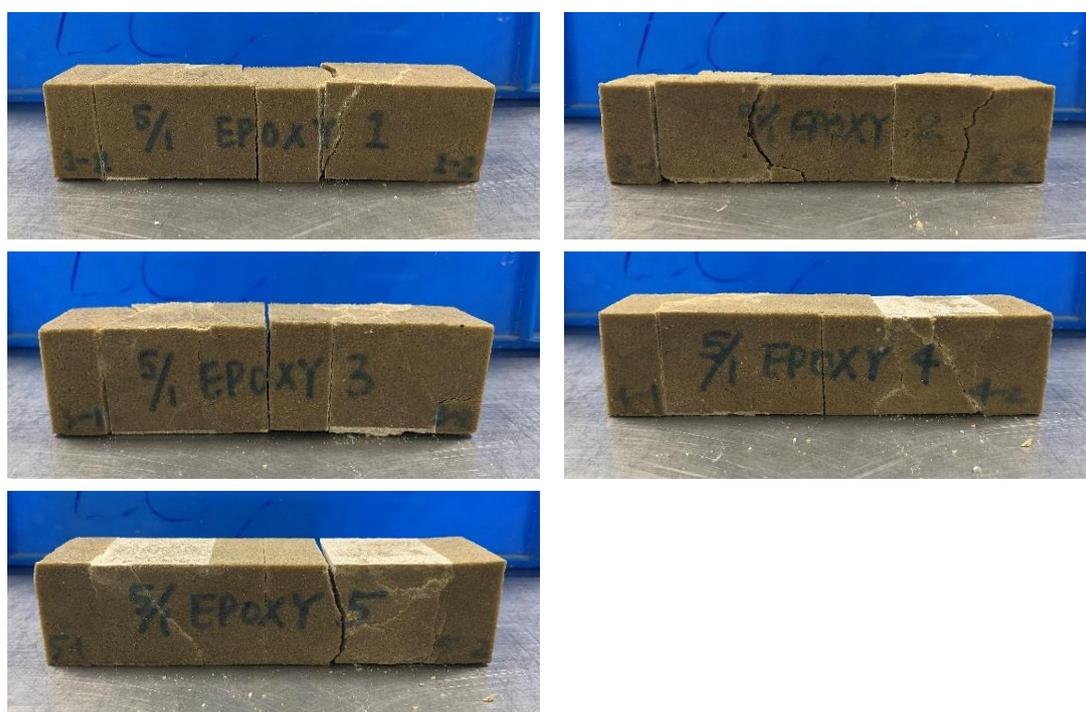
圖 4-39 環氧樹脂砂漿試體於 28 天齡期下撓曲及抗壓試驗照片
