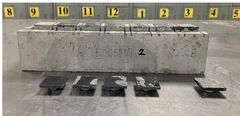
圖 4- 25 F00SP07 之 28 天循環齡期下黏結強度試驗照片
