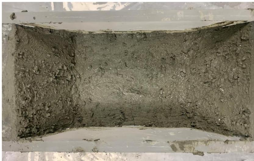
圖 3-14 水泥系黏結材之水泥砂漿
