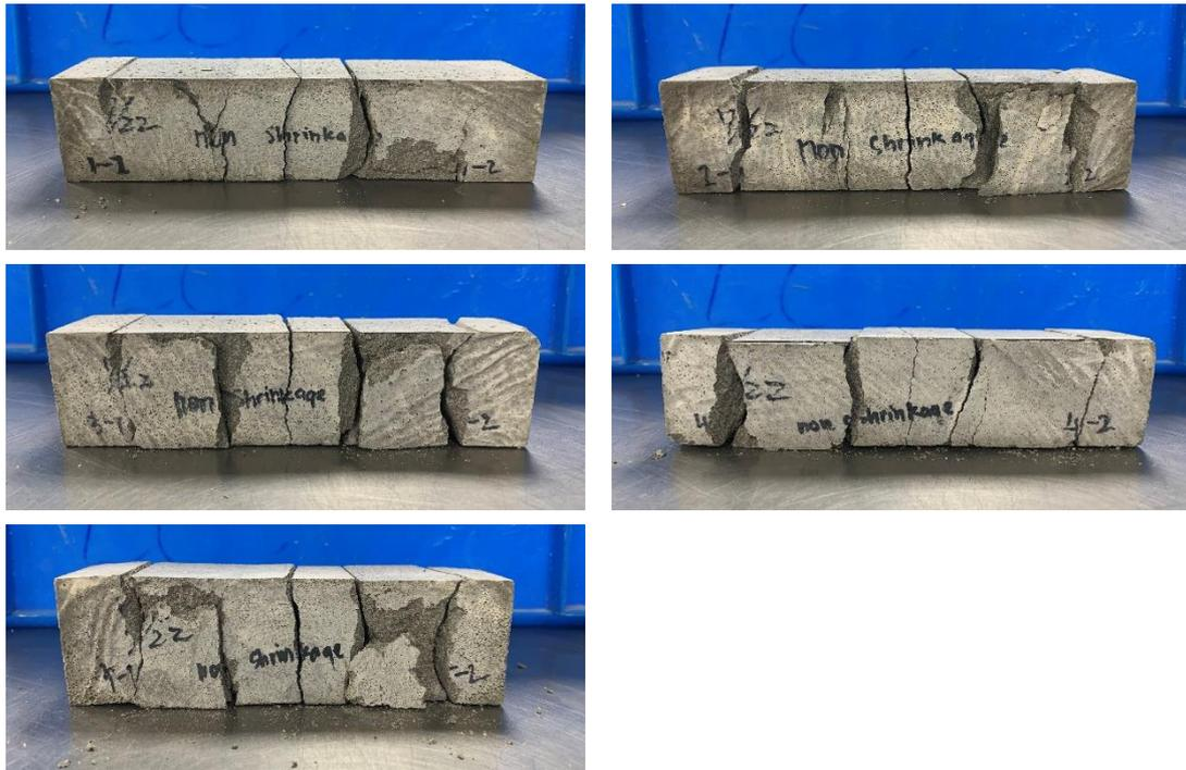
圖 4-32 無收縮水泥砂漿試體於 7 天齡期下撓曲及抗壓試驗照片
