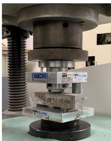
圖 3-2 撓曲強度試驗儀器
