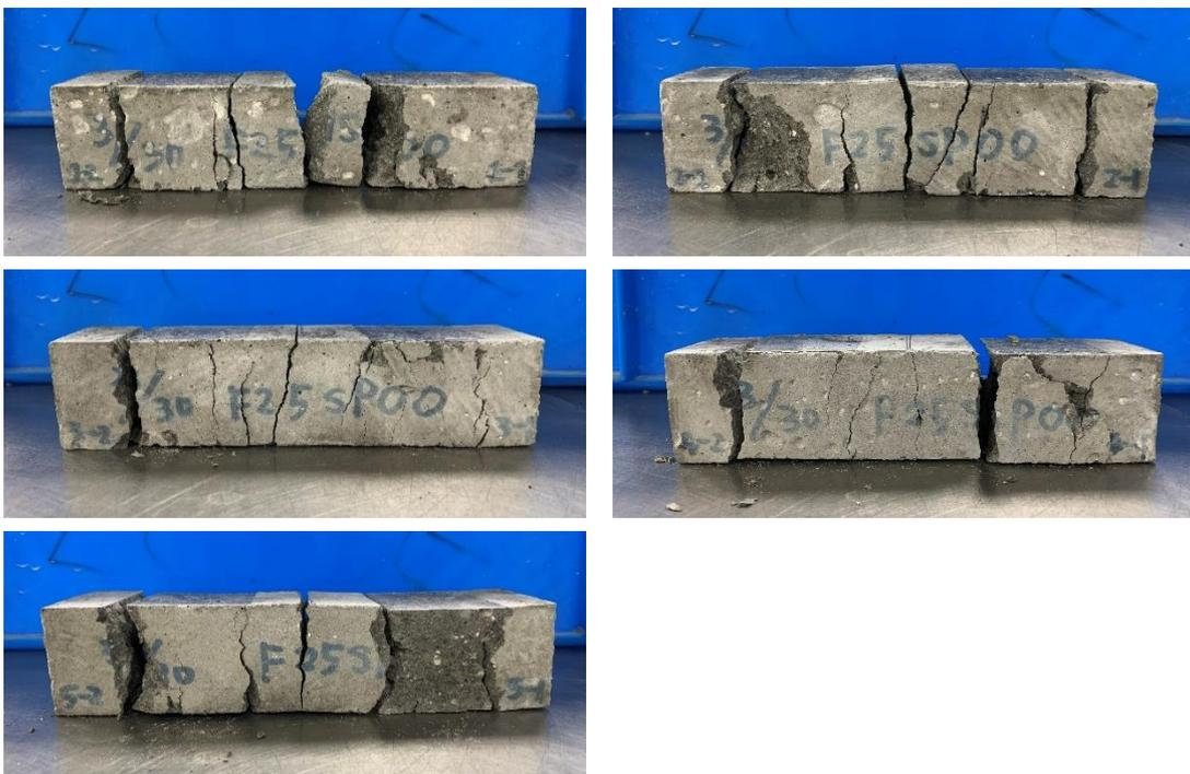
圖 4-15 F25SP00 之 28 天齡期下撓曲及抗壓試驗照片
