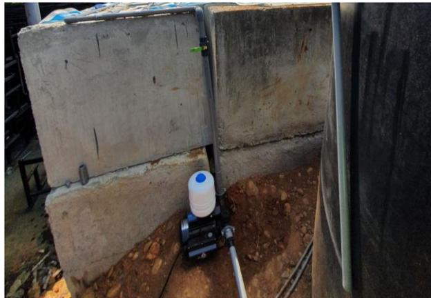
圖 4.2-1 降雨模擬裝置之加壓馬達
