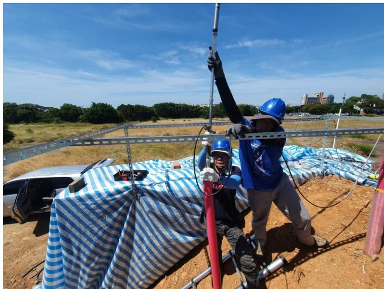
圖 3.2-9 定置型地中傾斜儀於模擬邊坡裝設
