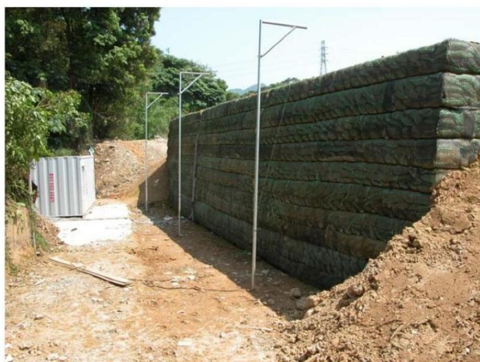
圖 2.4-1 大尺寸加勁擋土牆模型實驗照片(楊錦裕 2004)
