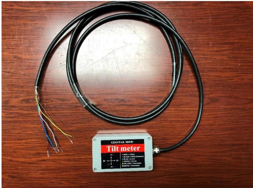
圖 3.2-1 雙軸傾斜儀
