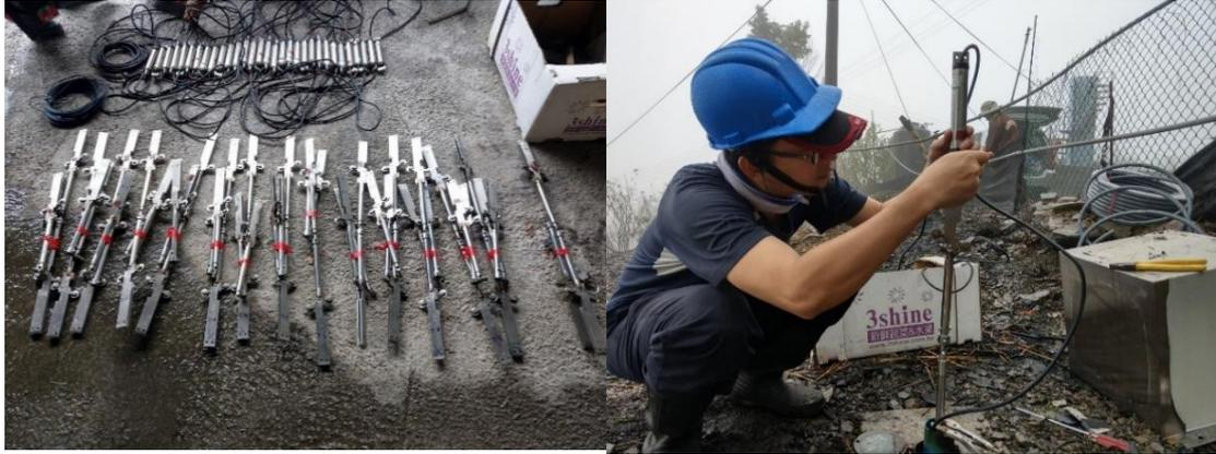
圖 2.2-5 定置型傾斜儀
