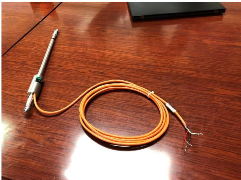
圖 3.2-2 振弦式裂縫計
