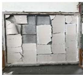
4. 實驗後試體加熱面
