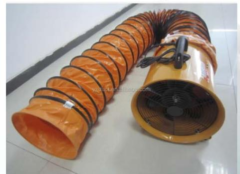
工業通風用排風機(移動軸流式)職業安全衛生設施規則第29-1條
