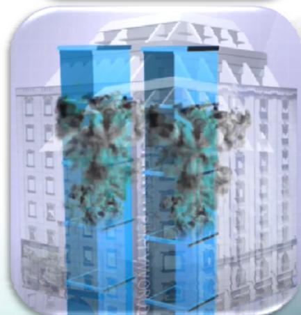
錢櫃KTV區劃破壞後火、煙流擴散示意圖
