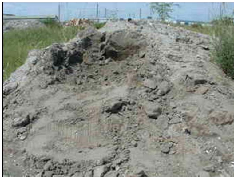
圖3-10 處理場之營建剩餘土石方（B4）
