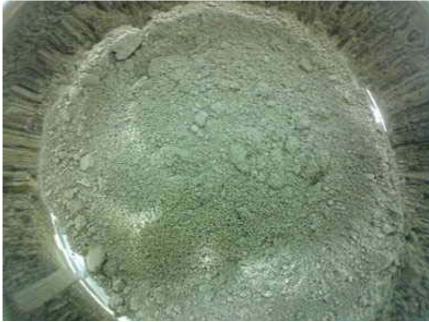
圖3-11 處理過之營建剩餘土石方
