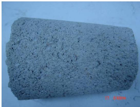
圖 3-22 成型後內部孔隙較為細緻之木質發泡水泥
