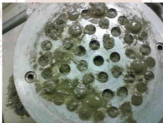
圖 3-13 混合料受壓後之排水情形
