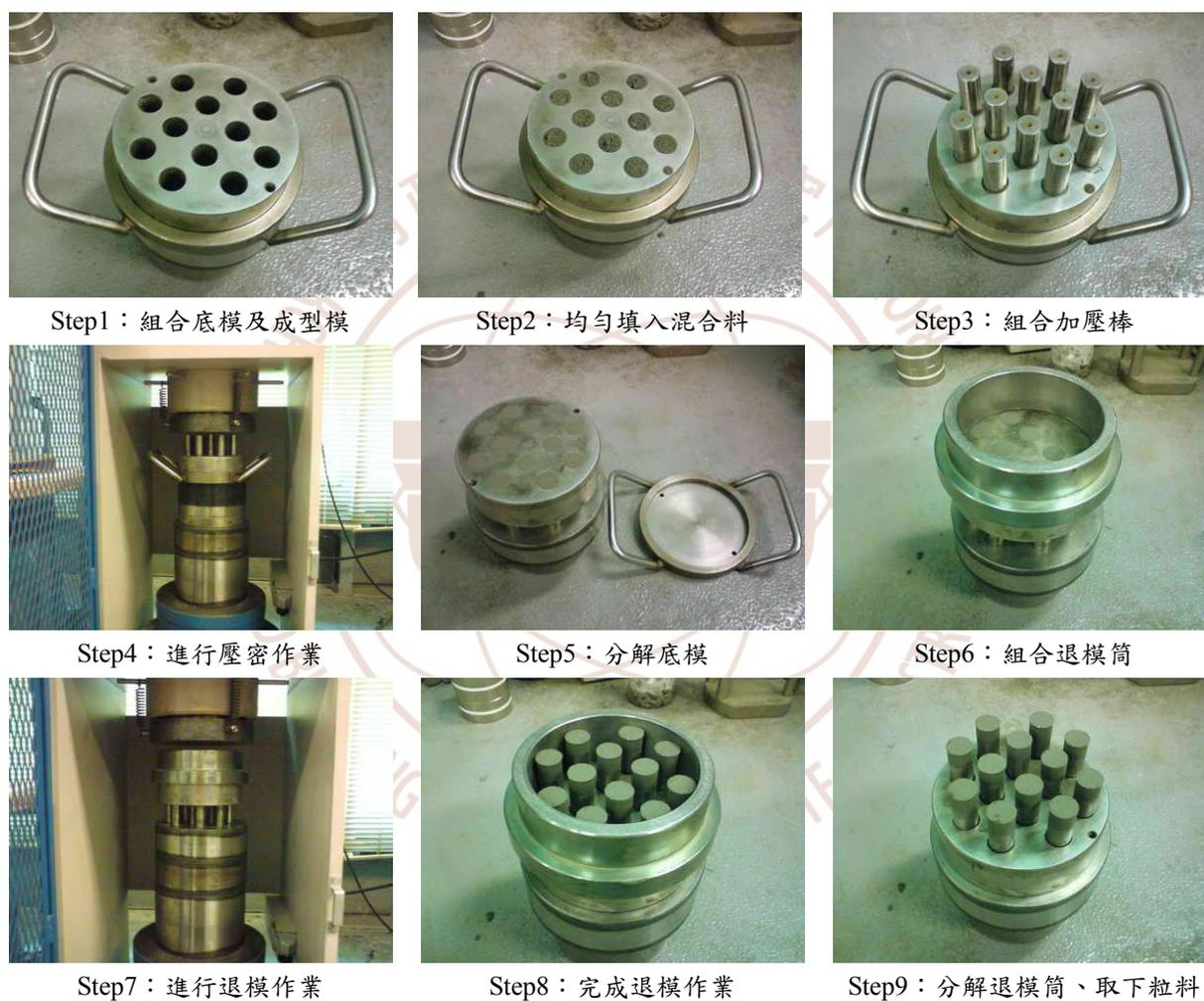
圖 3-17 冷結造粒加壓成型模造粒作業步驟
