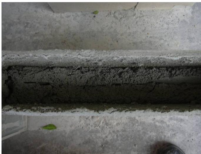
圖 3-30 木屑佔水泥重 50%所試製之成品漿體收縮嚴重與板材無結合
