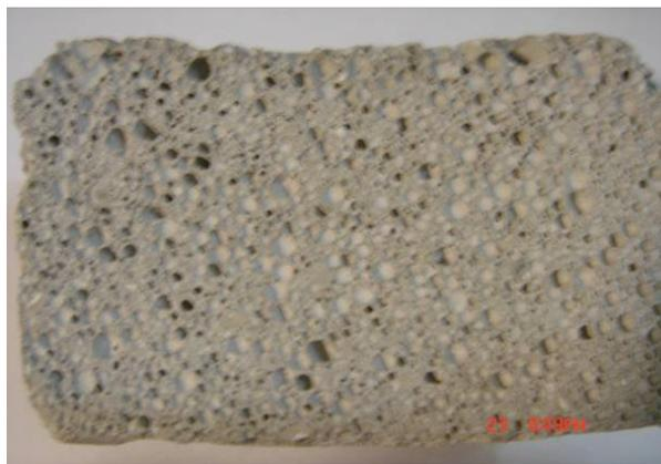
圖 3-21 成型後內部剖面呈現多孔蜂巢狀之發泡水泥
