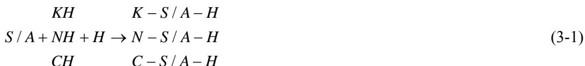
卜作嵐材料顆粒如較細且形狀呈圓形，對增加工作性及塑性有幫助，另因卜作嵐材料會消耗鹼性物質產生膠結反應，包括  $NaOH$ 、 $KOH$  等，因此，可清除水泥中之有害物質，如硫酸根離子及活性骨材的反應，故有助抗硫性質及抗鹼骨材反應作用，更由固化易溶性之  $CH$ ，使骨材與水泥漿界面更穩定，提升混凝土之抗滲能力。利用卜作嵐材料取代部分水泥，其固化作用產生之  $C-S-H$  膠體，可填充水泥水化後剩餘空隙，可確保長期耐久性及提升強度，且在初期水解過程中，可因減少水泥用量而降低水化熱，對延長混凝土可工作時間及降低塑性裂縫有很大助益。
