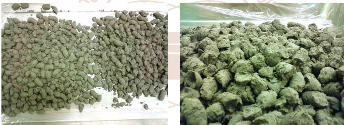
圖 3-11 螺旋擠壓造粒機造粒成品
