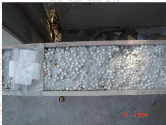
圖 3-20 添加保麗龍顆粒之輕質混凝土材料
