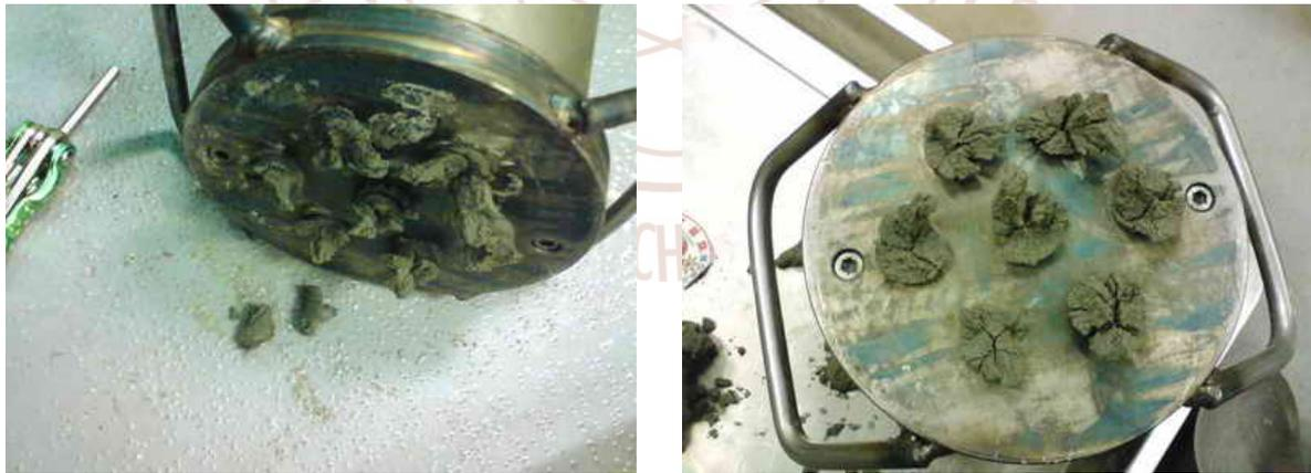
圖 3-15 改良型造粒底模混合料壓出情形
