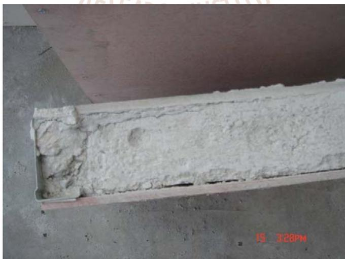
圖 3-29 硬化後成品收縮且鬆脆與外層隔板脫離
