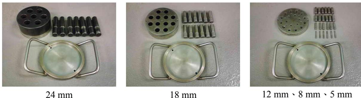
圖 3-16 各尺寸之冷結造粒加壓成型模
