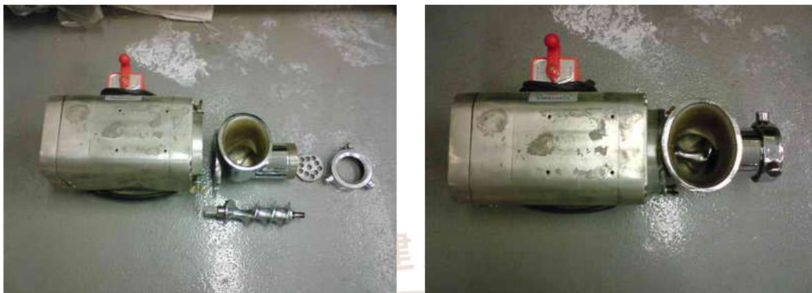
圖 3-10 螺旋擠壓式造粒機分解、組合圖
