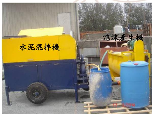
圖 3-23 現場施工製造之發泡機
