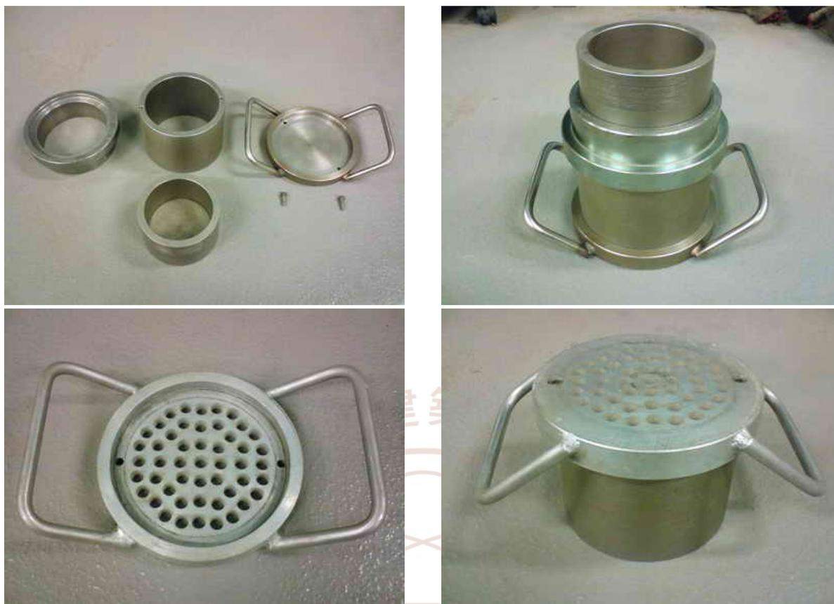
圖 3-12 冷結造粒預壓密模具分解、結合圖及造粒底模
