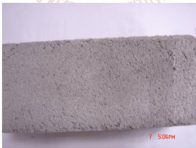
圖 3-35 調整組成所試製之發泡水泥漿體
