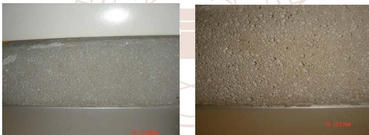
圖 3-37 另灌製於模具內之發泡水泥體孔隙度佳，無收縮現象。
