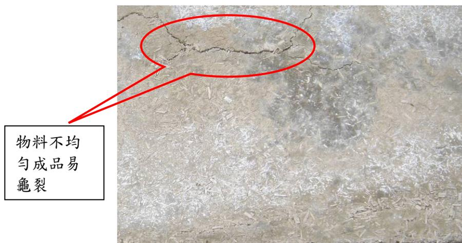
圖 3-43 隔熱磚物料調配不均之龜裂成品
