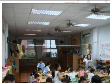
教室照度不足、均齊度不足
