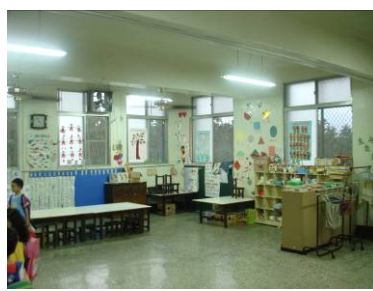
室內有排風扇輔助，但數量不足
