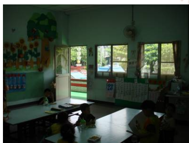
教室室內照度不足，均齊度不佳
