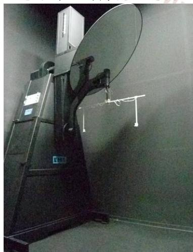
圖 4-2 燈具配光曲線測定儀
