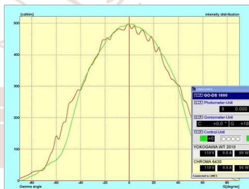
圖 4-26 直射水平面照度
