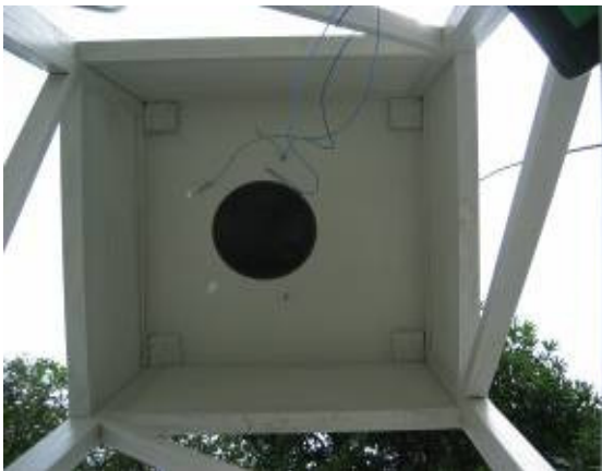
圖25 百葉遮罩吸收率0.29平均表面溫度33.2°C,平均MRT34.8°C
