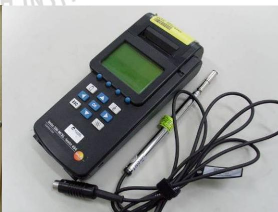
圖 4.5 熱線式風速計
