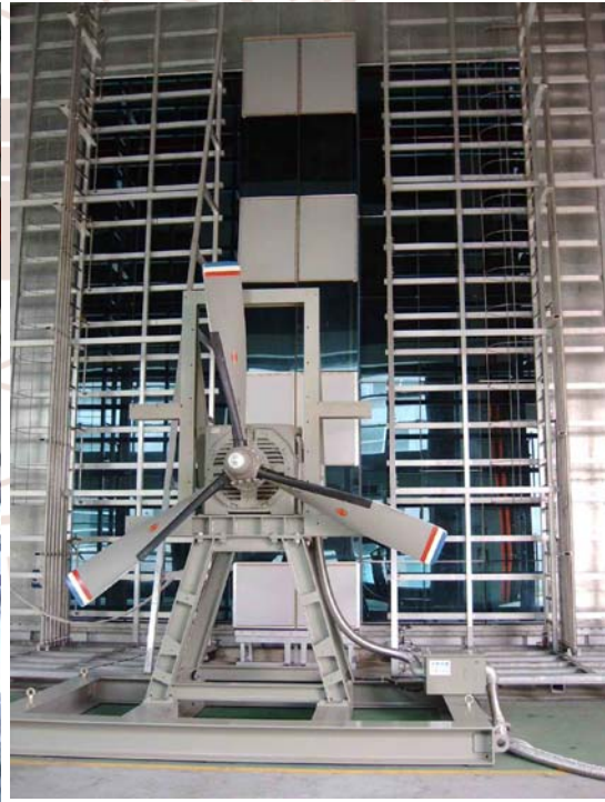
圖 3-4-2-2 造風設備 資料來源：本研究整理
