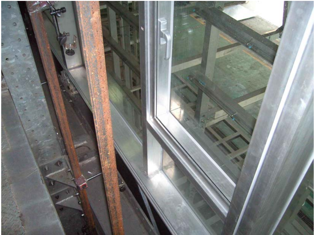
圖 3-3-1 帷幕牆氣密性能（含固定部及開窗部）
