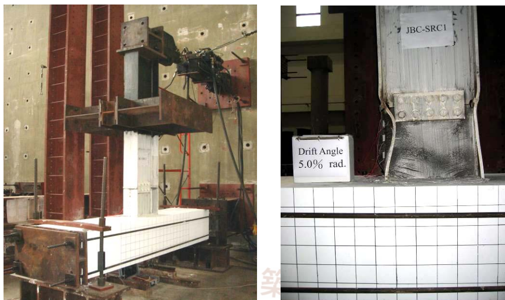
(a) 試體受反復載重作用之情形 (b) 層間變位角達 5.0% 弧度時之情形
