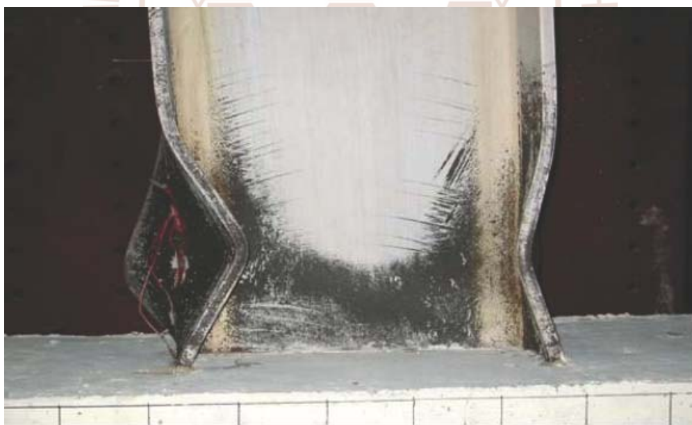
(b) 試體 SRC3-VR0.98 位移 10\Delta y 時(Story Drift Angle \theta_t=4.77\% )
