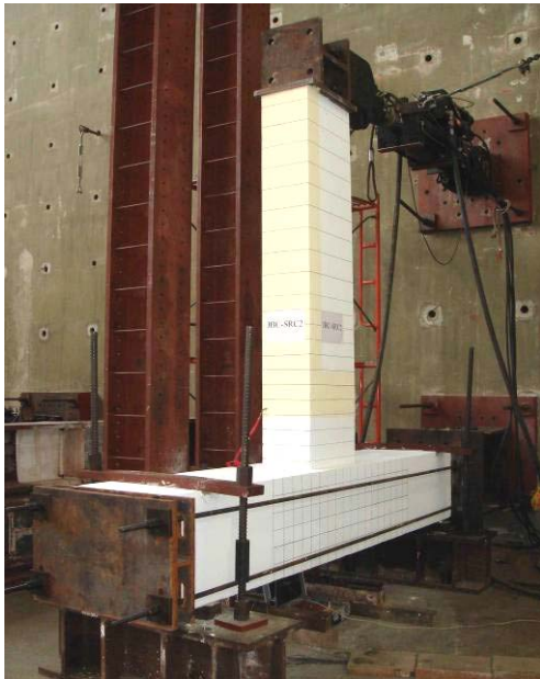
(a) 試體受反復載重作用之情形
