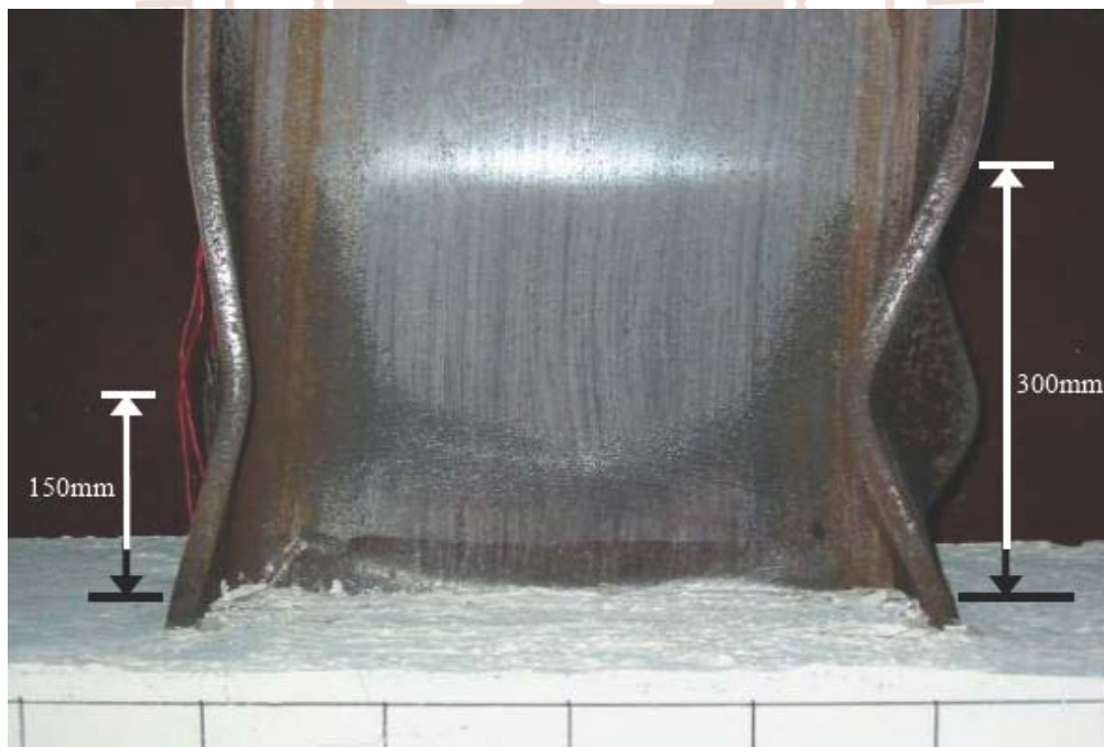
(a) 試體 SRC1-MR2.24 位移 11\Delta y 時( Story Drift Angle \theta_t = 5.24\% \text{ rad} )
