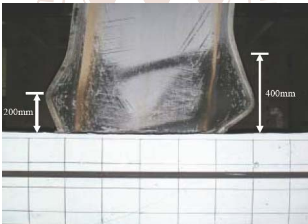
(c) 試體 SRC3-MR1.04 位移 13\Delta y 時( Story Drift Angle \theta_t = 6.22 \% \text{ rad} )
