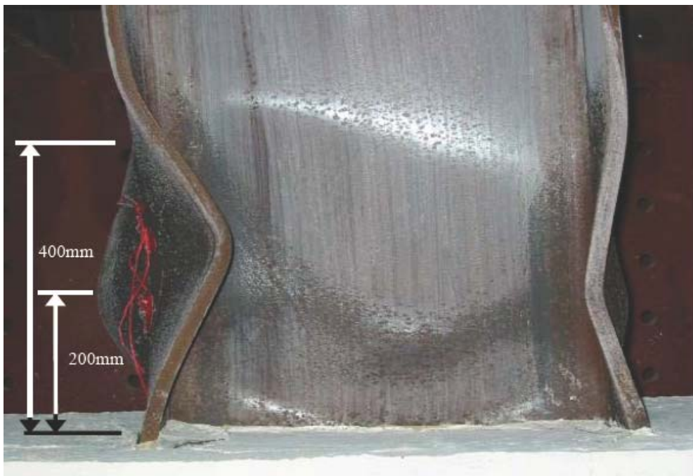
(b) 試體 SRC2-MR1.26 位移 11\Delta y 時( Story Drift Angle \theta_t = 5.23 \% \text{ rad} )
