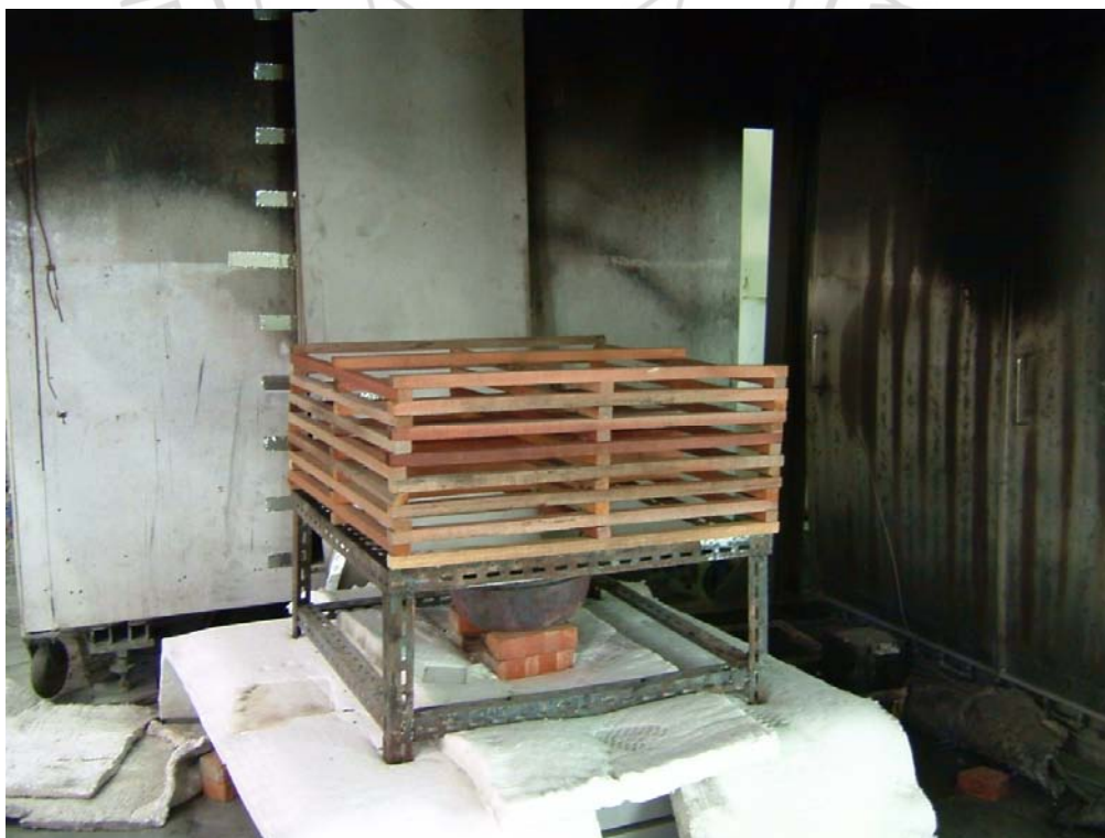
圖 3-3 木堆於煙罩下進行熱釋放率實驗配置（蘇鴻奇，2007）
