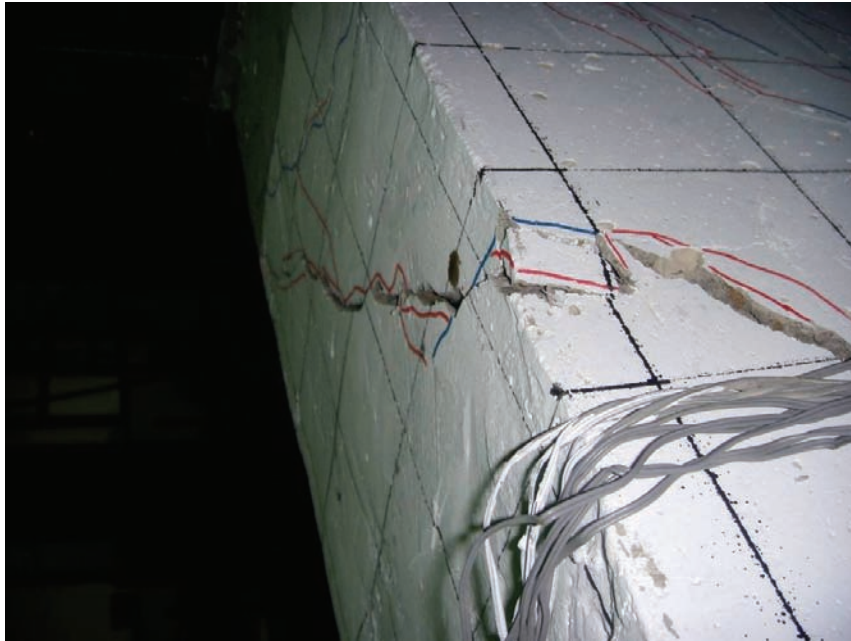
圖 4.5 試體S1-RCt2l2 裂縫寬度達 10 mm
