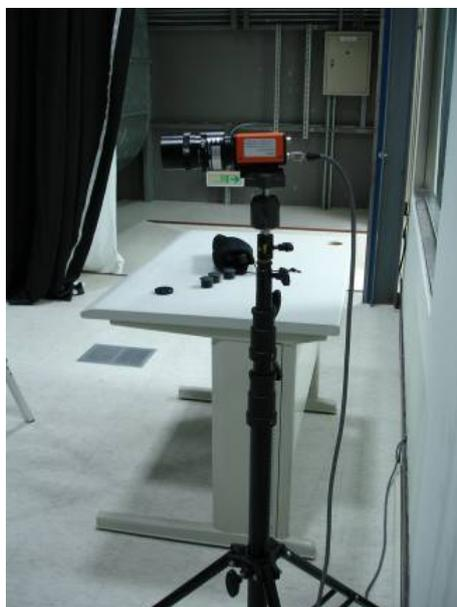
圖 3-6 點線面輝度與色度分佈測定
