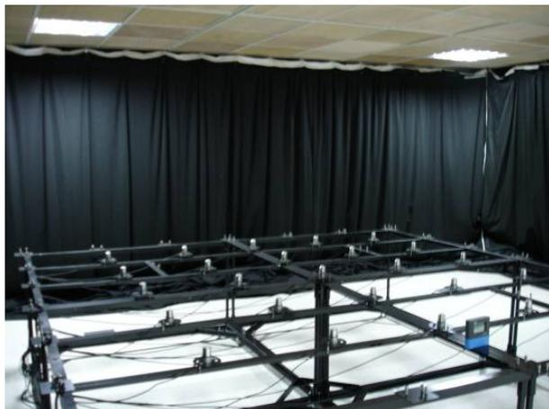
圖 3-5 多點水平面照度測定
