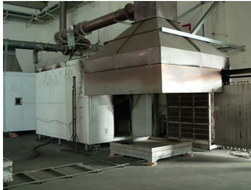
圖 3-1 ISO 9705 試驗房間(Test room)集煙罩及排氣導管
