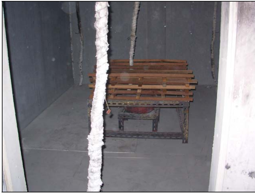
圖 4-2 ISO 9705 木框架實驗前設定情況
