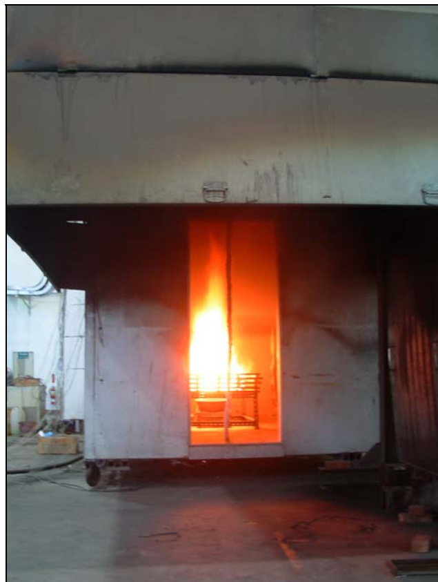
圖 4-3 ISO 9705 木框架實驗過程燃燒情況
