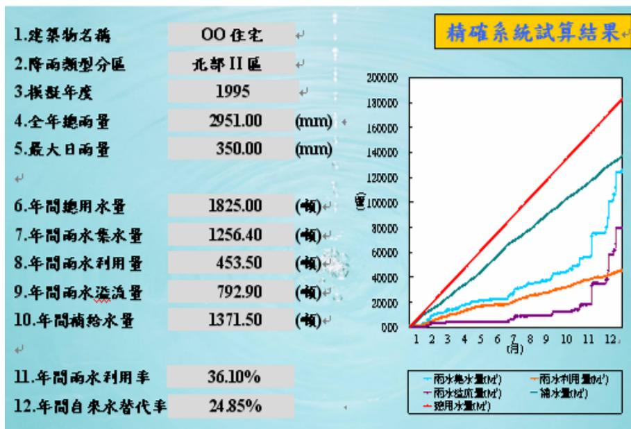
圖 5-3.6 精確系統試算結果
