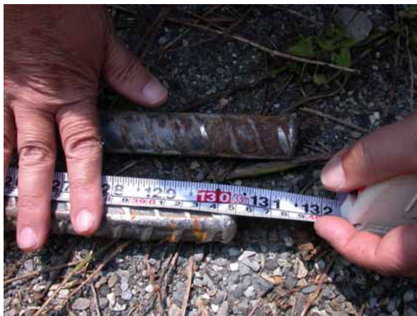
照片 5-12 岩釘案例 I 拔出驗證照片二
