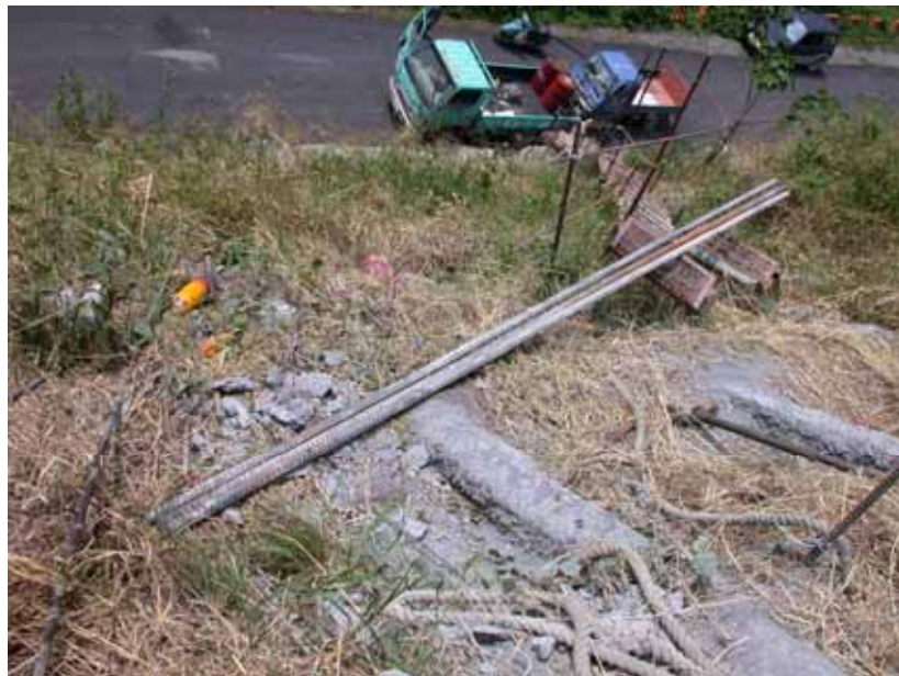
照片 5-11 岩釘案例 I 拔出驗證照片一
