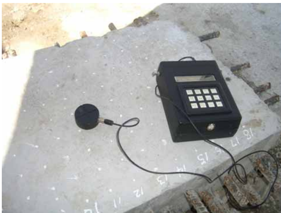
照片 3-6 鋼筋檢測儀試驗過程(一)
