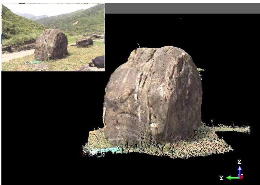
圖 4-28 第一處邊坡旁落石原始三維雷射掃描點疊合照片影像
