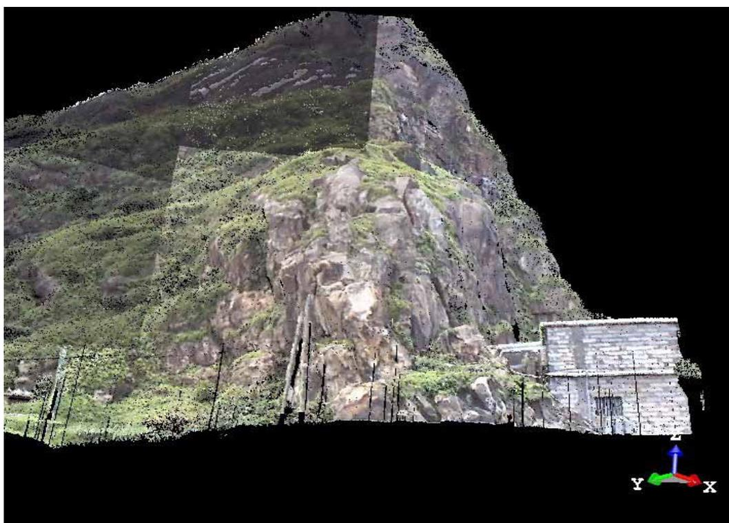
圖 4-31 第二處邊坡數值地形模型疊合照片影像
