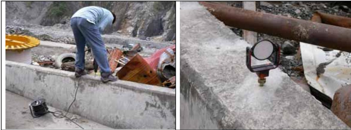
圖 4-7 後方固定孔鑽設(左圖)與固定點反射鏡安裝(右圖)
