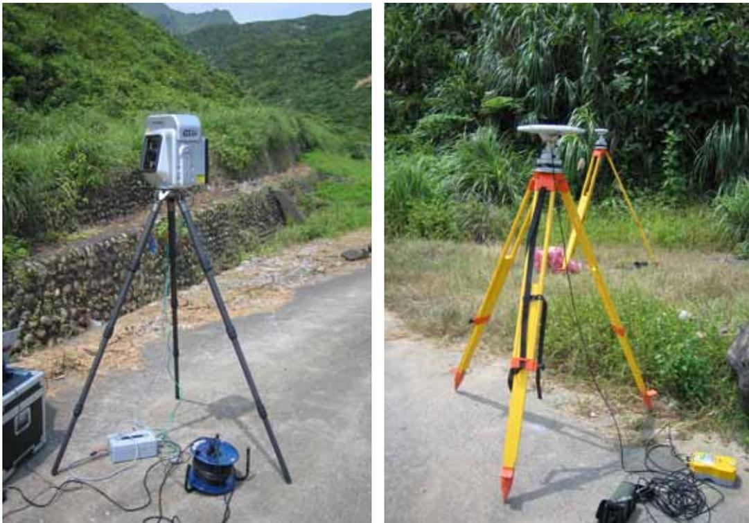
圖 4-22 GS200 雷射掃描儀(左圖)與 GPS 定位(右圖)
