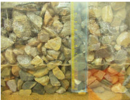
(d) 級配層積水概況
