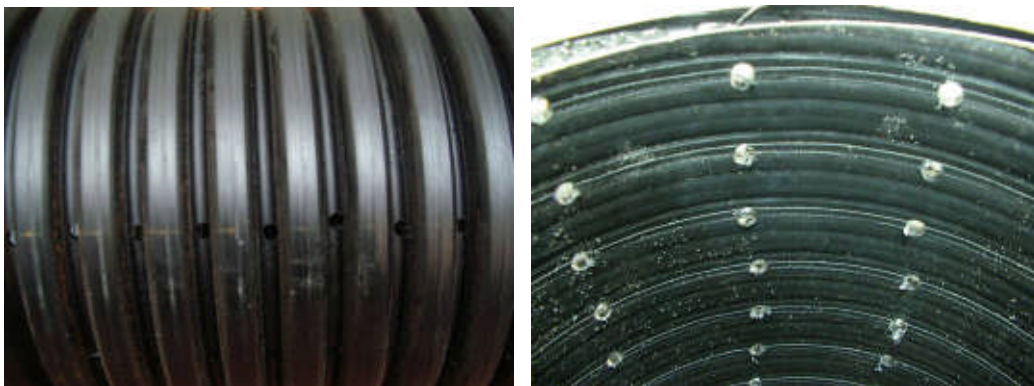
圖3-16 滲透排水管之開孔型式
