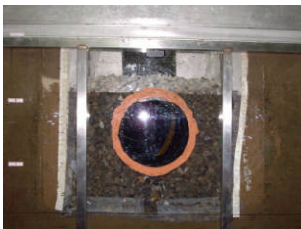
(c) 高水位滲透測試
