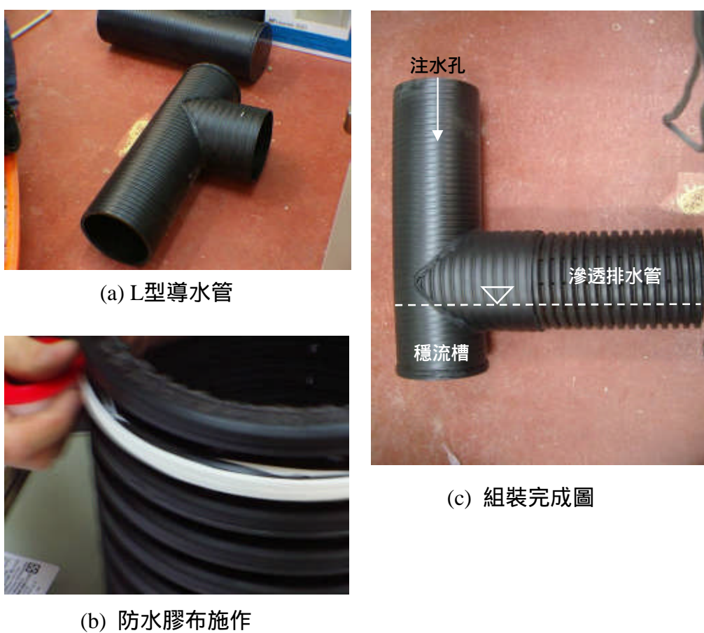
圖3-17 滲透排水管試驗模型
