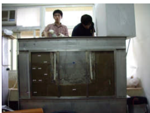
(d) 滲透側溝移除後之試驗模型 (右上方為鋪設新不織布後之管溝設置槽)
