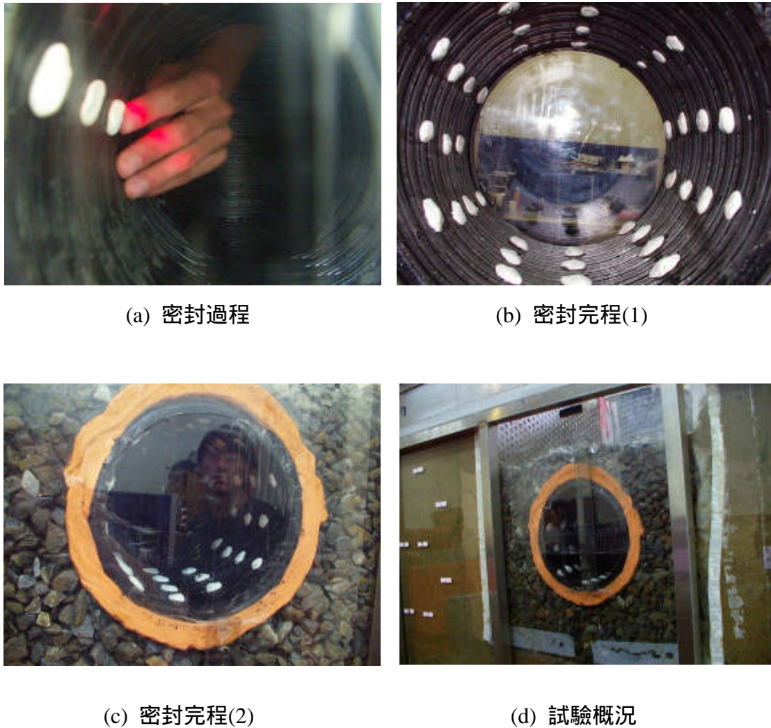
圖 4-3 滲透排水管密封施作及試驗概況
