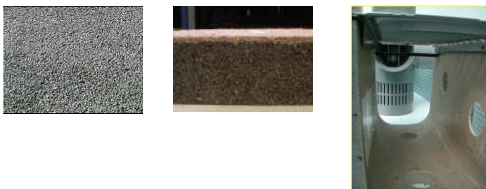
(a) 透水性混凝土 (b) 樹脂混合骨材之透水材料 (c)具排水孔之側溝
