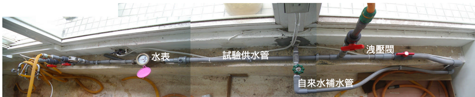
圖 3-23 試驗用水管線配置上視圖
