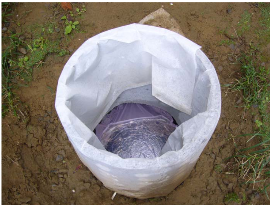
圖 5-31 孔隙減半、底部全封之滲透陰井(直徑 40 cm、開孔率 0.39125%)
