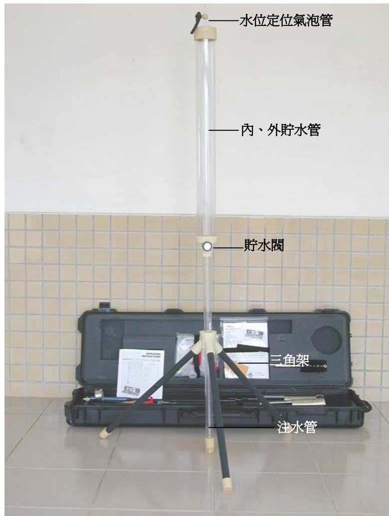
圖 5-5 葛洛夫滲透儀之基本構造
