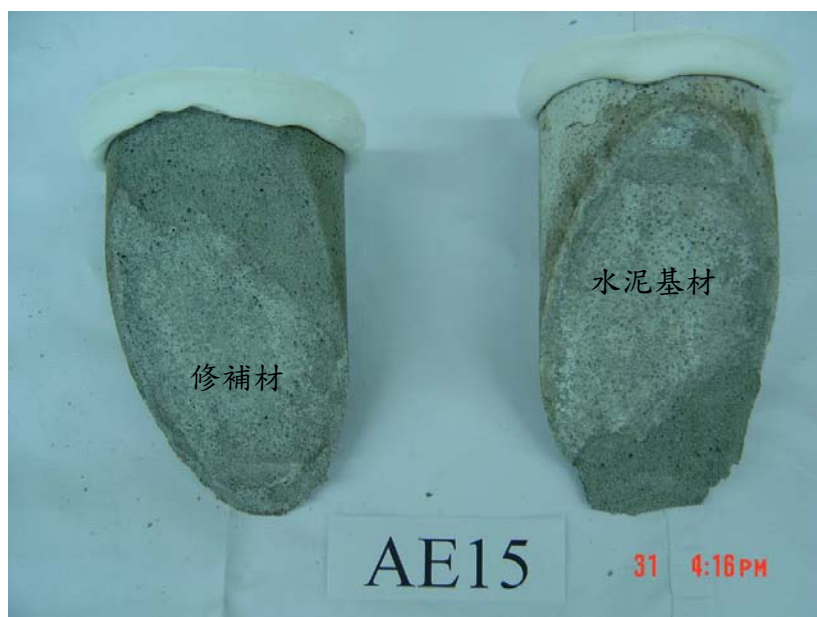
圖 4-36 聚合物改質水泥砂漿之黏結強度破壞試體(AE15)
