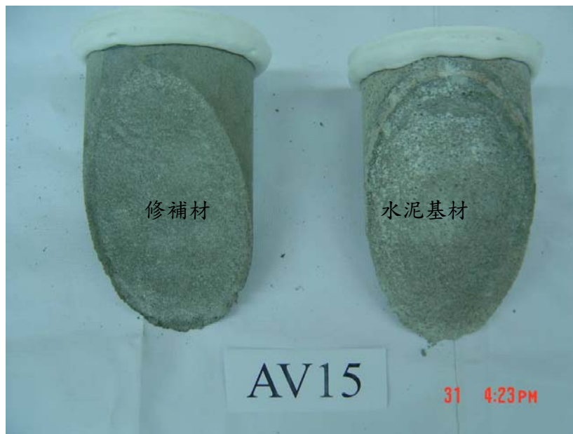
圖 4-39 聚合物改質水泥砂漿之黏結強度破壞試體(AV15)
