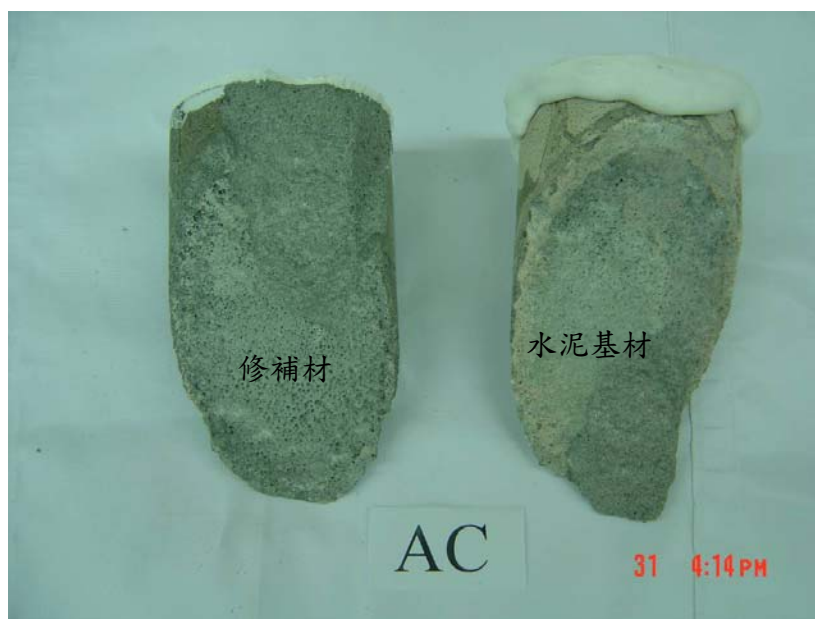
圖 4-33 聚合物改質水泥砂漿之黏結強度破壞試體(AC)
