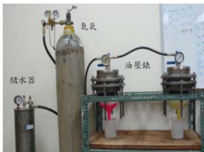
圖 2-7 透水試驗設備(CRD C48)
