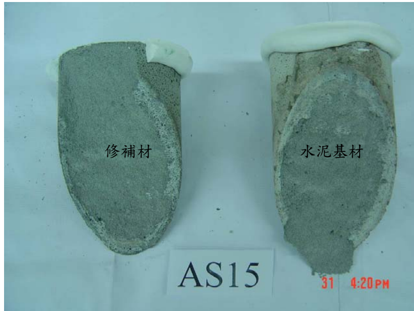
圖 4-42 聚合物改質水泥砂漿之黏結強度破壞試體(AS15)
