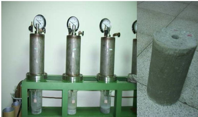
圖 2-6 透水試驗儀外觀與試體外觀
