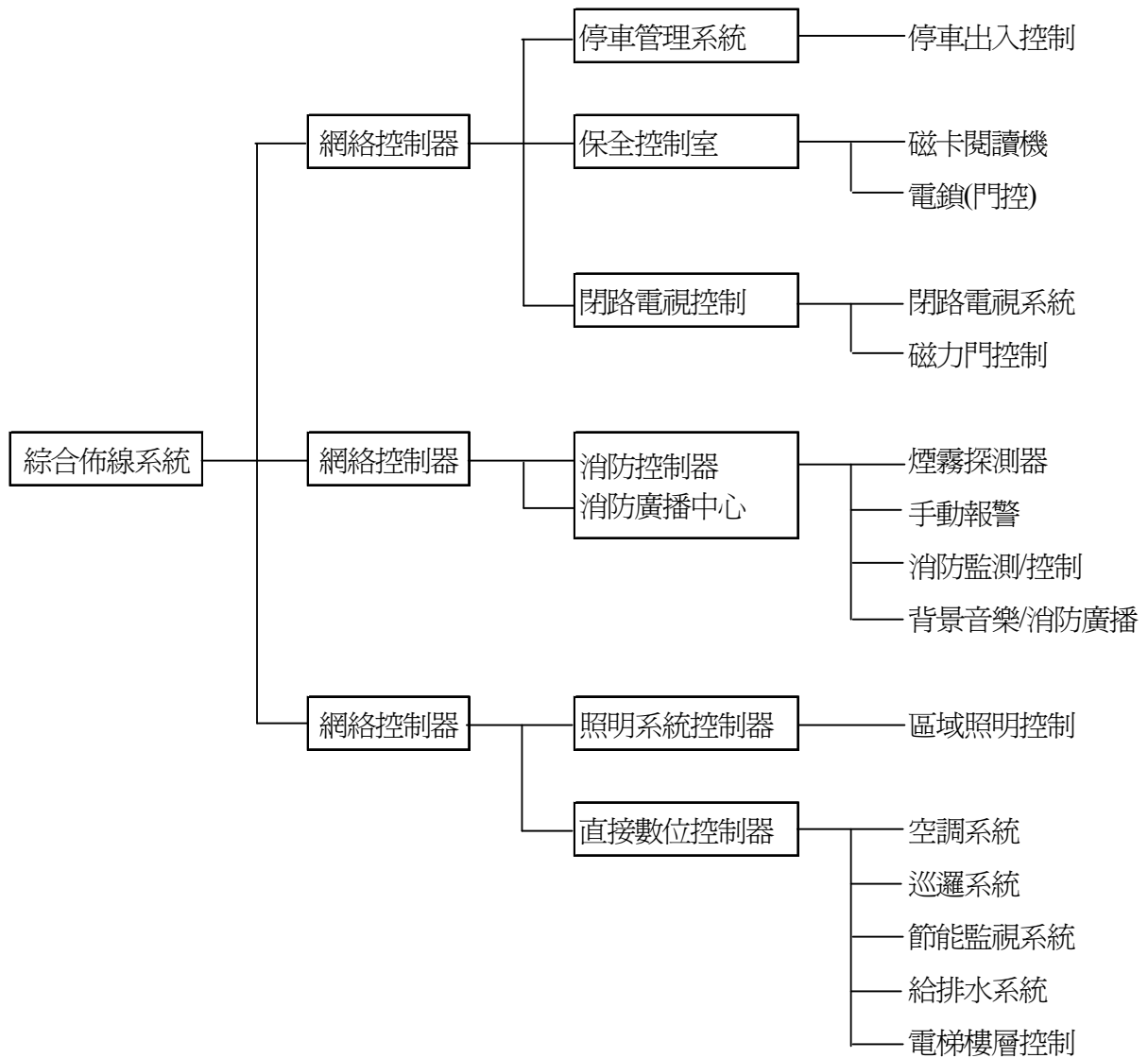
圖 3-8 (智慧建築自動化系統整合結構)
