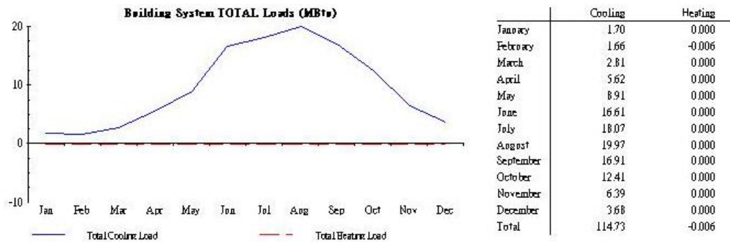
圖 5-59 辦公類標準示範空間全年之每月空調耗能變化圖 (鋪設磨石子 PS 隔熱磚後)
