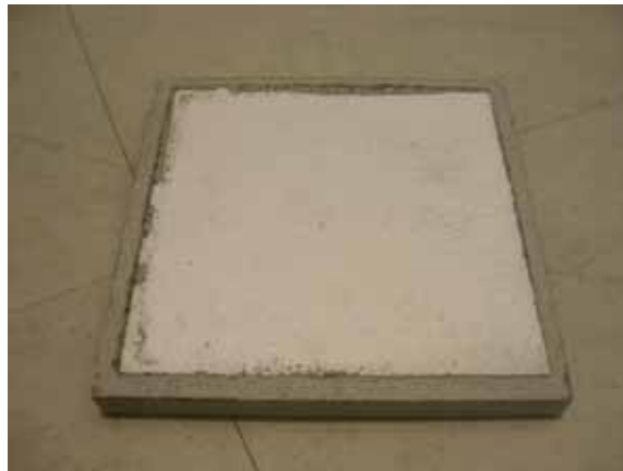
圖 4-7 保麗龍隔熱磚試件之整體近照 （資料來源：本研究整理）
