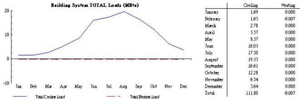
圖 5-29 辦公類標準示範空間全年之每月空調耗能變化圖 (鋪設斷熱陶隔熱磚後)
