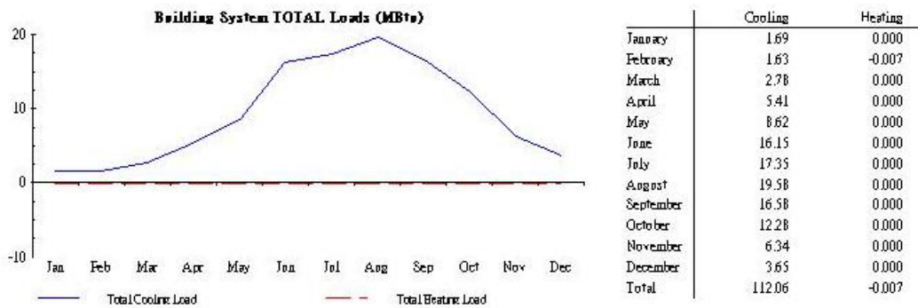
圖 5-65 辦公類標準示範空間全年之每月空調耗能變化圖 (鋪設磨石子隔熱磚後)
