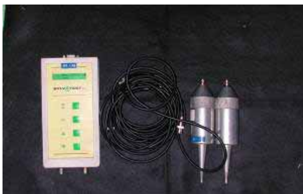
圖 4-10 超音波檢測儀 (Sylvatest Duo) 檢測現況圖
