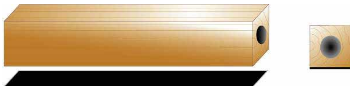
(b) 引張側貼覆 1 層 CFRP、鑽孔直徑 1.8 cm 貫穿全長
