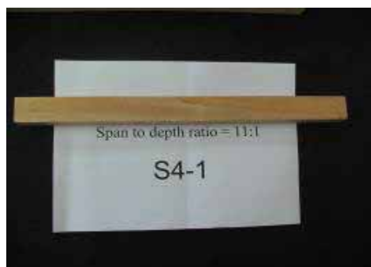
圖 5-5 S4 組試材靜曲破壞現況圖
