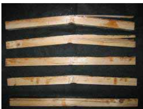
圖 4-13 B-A-1 組試材抗彎測試結果(由上至下分別為試材編號 1~5)
