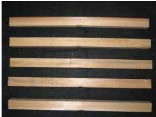
圖 4-37 B-D-1 組試材抗彎測試結果(由上至下分別為試材編號 1~5)
