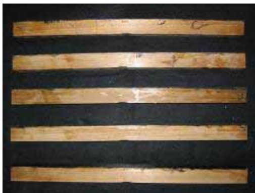
圖 4-38 B-D-2 組試材抗彎測試結果(由上至下分別為試材編號 1~5)
