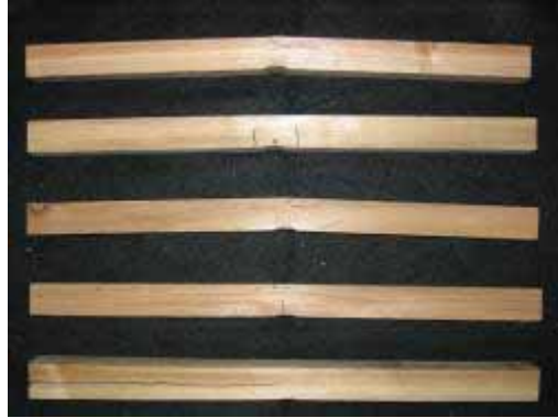
圖 4-21 B-B-1 組試材抗彎測試結果(由上至下分別為試材編號 1~5)
