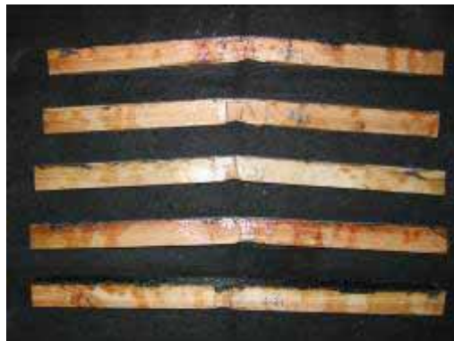
圖 4-15 B-A-3 組試材抗彎測試結果(由上至下分別為試材編號 1~5)
