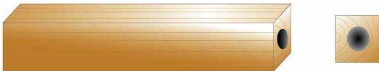
(a) 未貼覆 CFRP、鑽孔直徑 1.8 cm 貫穿全長
