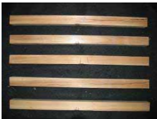
圖 4-44 B-E-0 組試材抗彎測試結果(由上至下分別為試材編號 1~5)
