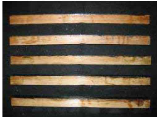
圖 4-31 B-C-3 組試材抗彎測試結果(由上至下分別為試材編號 1~5)
