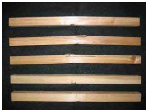
圖 4-28 B-C-0 組試材抗彎測試結果(由上至下分別為試材編號 1~5)
