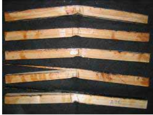
圖 4-15 B-A-3 組試材抗彎測試結果(由上至下分別為試材編號 1~5)
