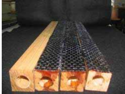
圖 4-28 B-C-0 組試材抗彎測試結果(由上至下分別為試材編號 1~5)
