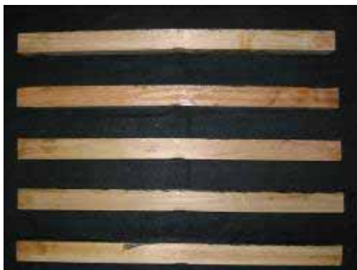
圖 4-38 B-D-2 組試材抗彎測試結果(由上至下分別為試材編號 1~5)
