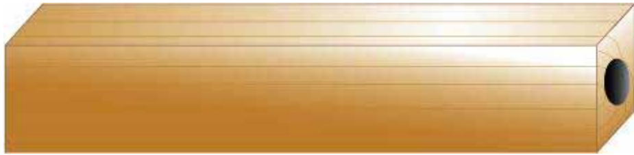
(a) 未貼覆 CFRP、鑽孔直徑 2.2 cm 貫穿全長
