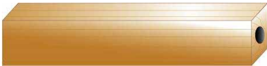
(a) 未貼覆 CFRP、鑽孔直徑 1.5 cm 貫穿全長
