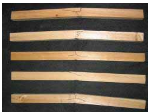
圖 4-13 B-A-1 組試材抗彎測試結果(由上至下分別為試材編號 1~5)
