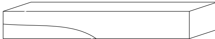
圖 4 撓曲破壞+CFRP 斷裂 (B-1)
