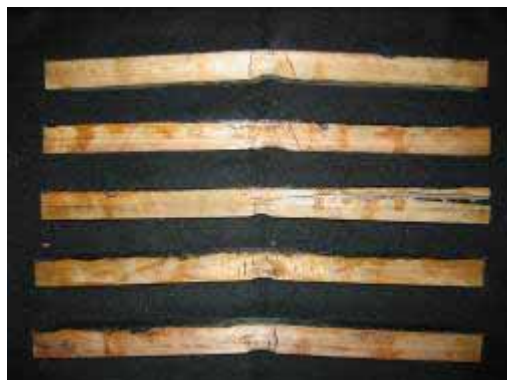
圖 4-22 B-B-2 組試材抗彎測試結果(由上至下分別為試材編號 1~5)
