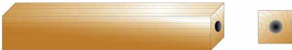
(a) 未貼覆 CFRP、鑽孔直徑 1.2 cm 貫穿全長
