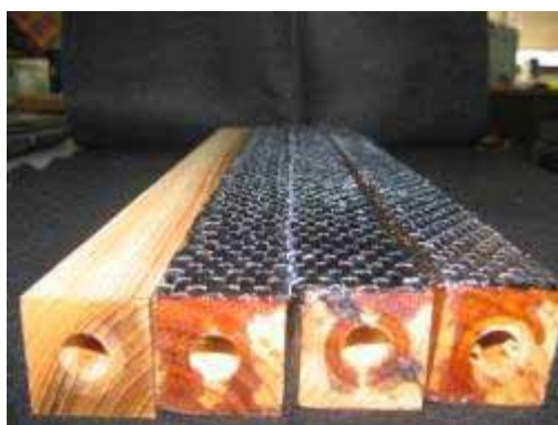
圖 4-19 B-B 組試材現況圖(由左至右分別為對照組、1 層 CFRP、2 層 CFRP 與 3 層 CFRP)
