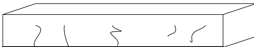
圖 23 撓曲破壞 (H-3)
