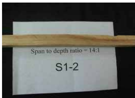
圖 5-3 S2 組試材靜曲破壞現況圖
