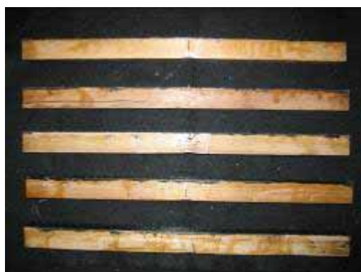
圖 4-47 B-E-3 組試材抗彎測試結果(由上至下分別為試材編號 1~5)
