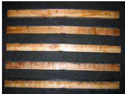
圖 4-31 B-C-3 組試材抗彎測試結果(由上至下分別為試材編號 1~5)
