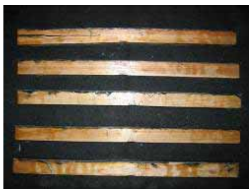
圖 4-47 B-E-3 組試材抗彎測試結果(由上至下分別為試材編號 1~5)
