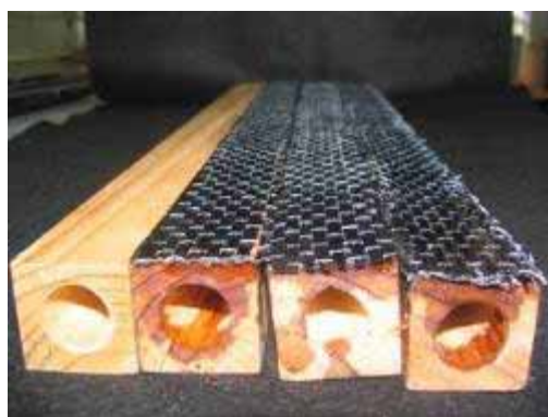
圖 4-35 B-D 組試材現況圖（由左至右分別為對照組、1 層 CFRP、2 層 CFRP 與 3 層 CFRP）
