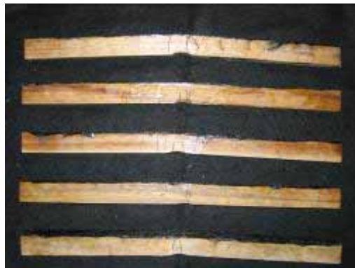
圖 4-22 B-B-2 組試材抗彎測試結果(由上至下分別為試材編號 1~5)
