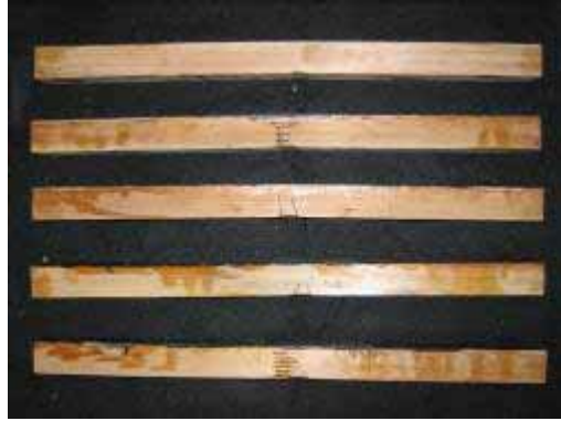
圖 4-29 B-C-1 組試材抗彎測試結果(由上至下分別為試材編號 1~5)
