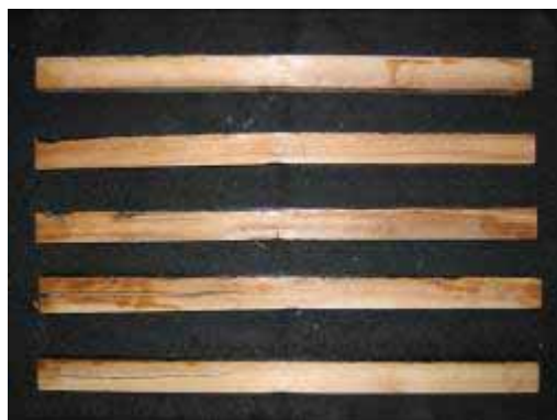
圖 4-45 B-E-1 組試材抗彎測試結果(由上至下分別為試材編號 1~5)
