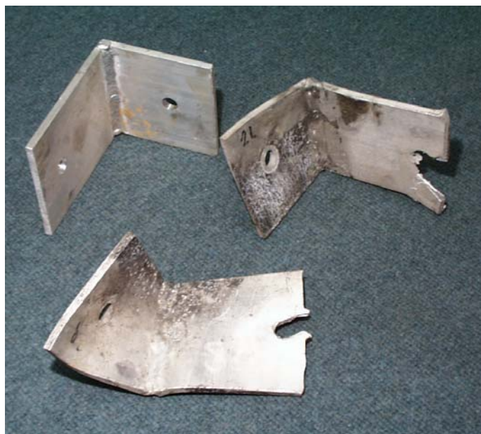
圖 4-4 鋁合金”L”角型繫件”拉穿”破壞情景
