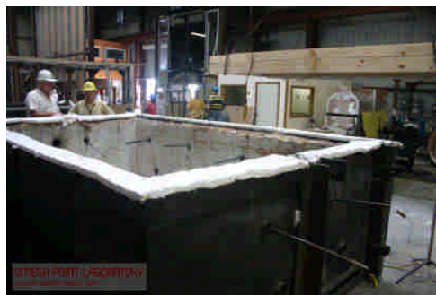
(a) 試驗之耐火爐體
