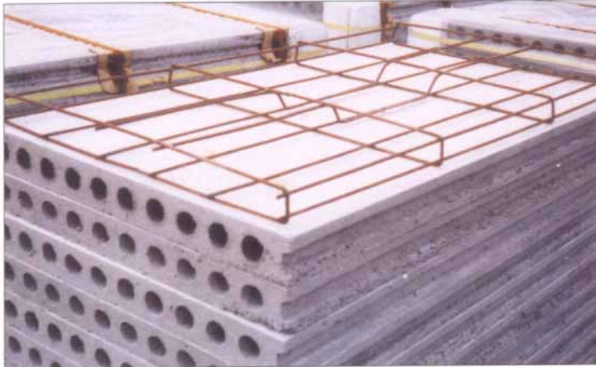
照片 4-3 厚度 6cm 之輕質骨材混凝土預鑄牆板
