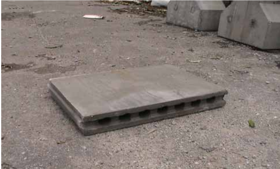
照片 4-1 厚度 8.8cm 之輕質骨材混凝土預鑄企口磚
