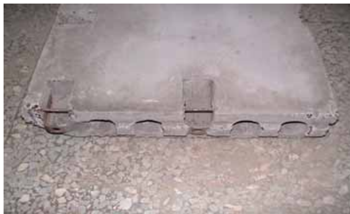
照片 4、厚度 9cm 之輕質骨材混凝土預鑄牆板
