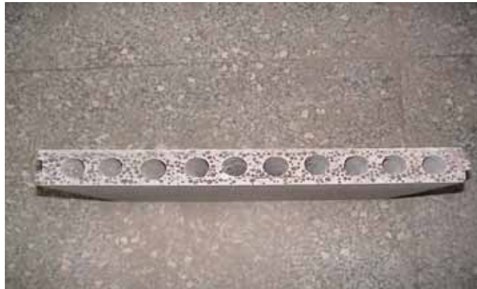
照片 3、厚度 6cm 之輕質骨材混凝土預鑄牆板
