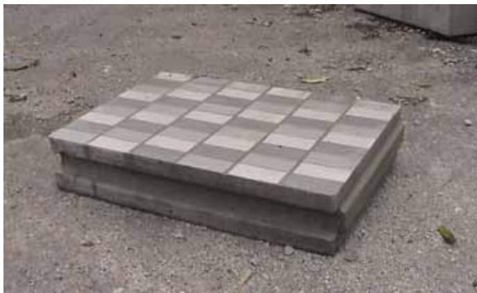
照片 2、厚度 12cm 之輕質骨材混凝土預鑄外牆磚
