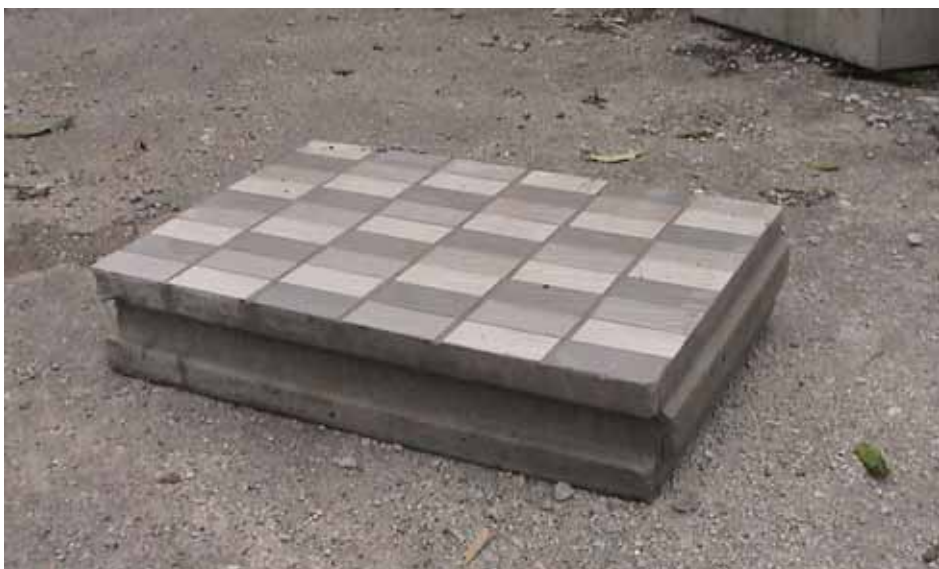
照片 4-2 厚度 12cm 之輕質骨材混凝土預鑄外牆磚
