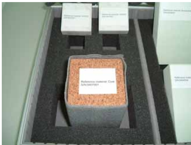
圖 2-16 原廠所附之標準試片 (Extruded polystyrene、Cork、Marble HOR03)
