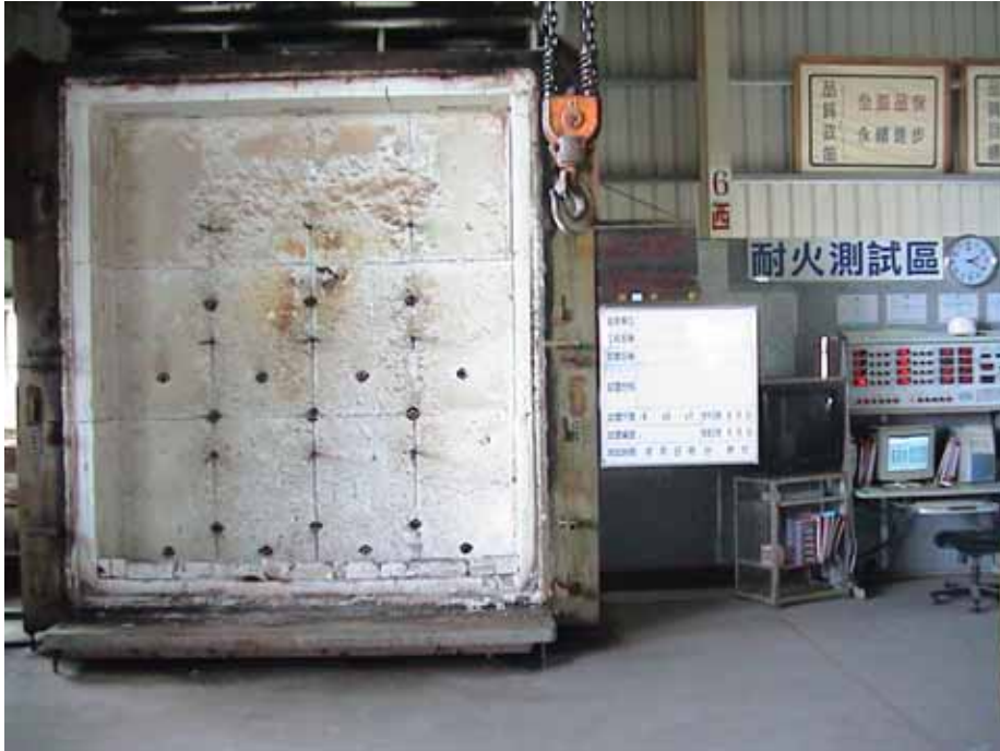
照片 5-5 混凝土版之防火試驗裝置
