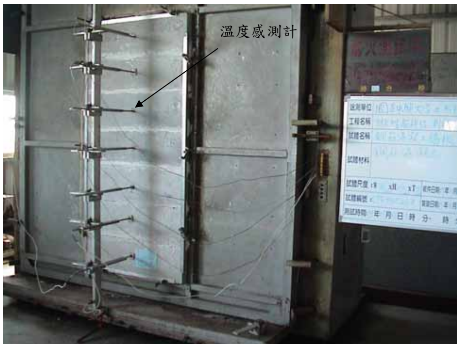
照片 5-6 混凝土版防火試體之裝置情形
