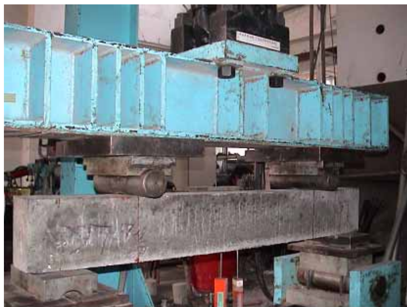
照片 3-3 鋼筋混凝土樑之剪力試驗裝置
