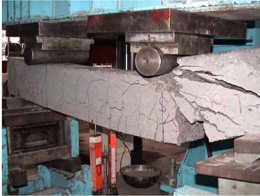
照片 4-3 輕質混凝土樑試體破壞情形(a/d=1.5)
