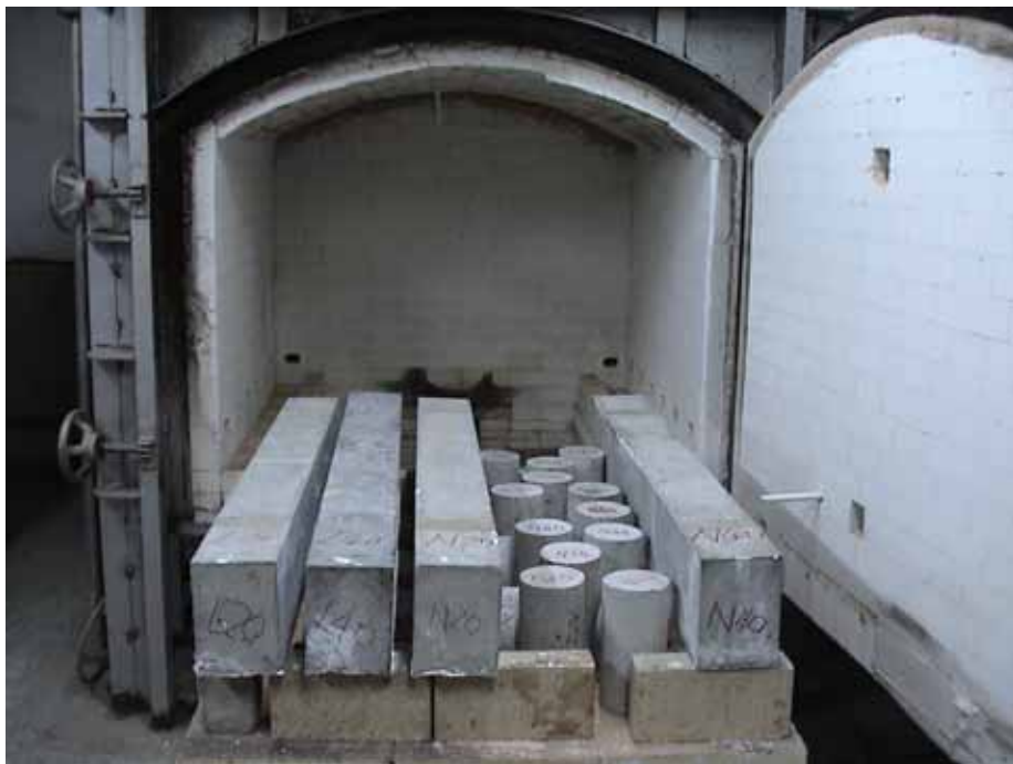
照片 5-2 混凝土樑防火試體之裝置情形
