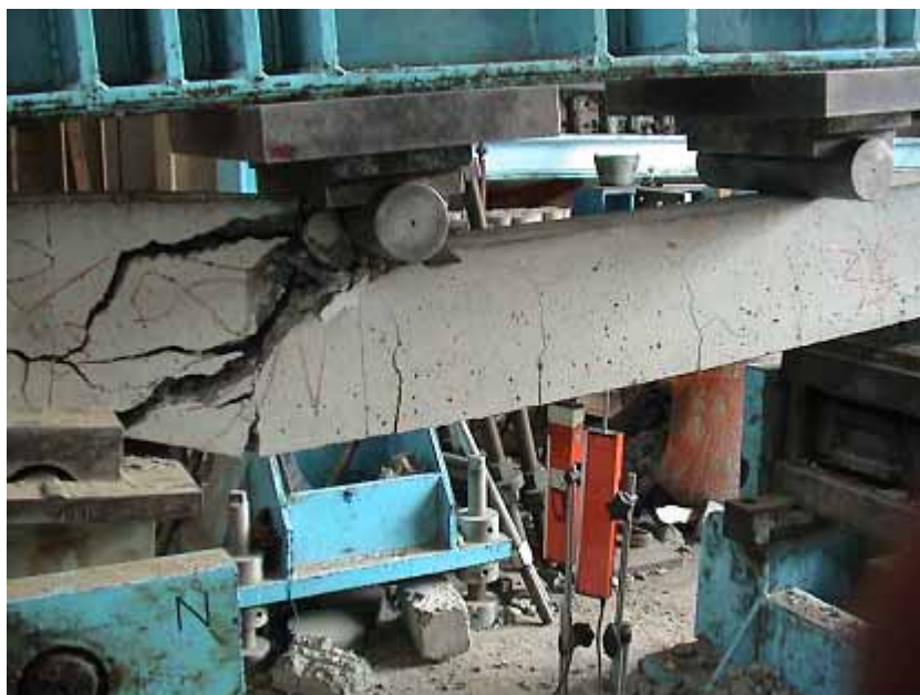
照片 4-4 常重混凝土樑試體破壞情形(a/d=1.5)
