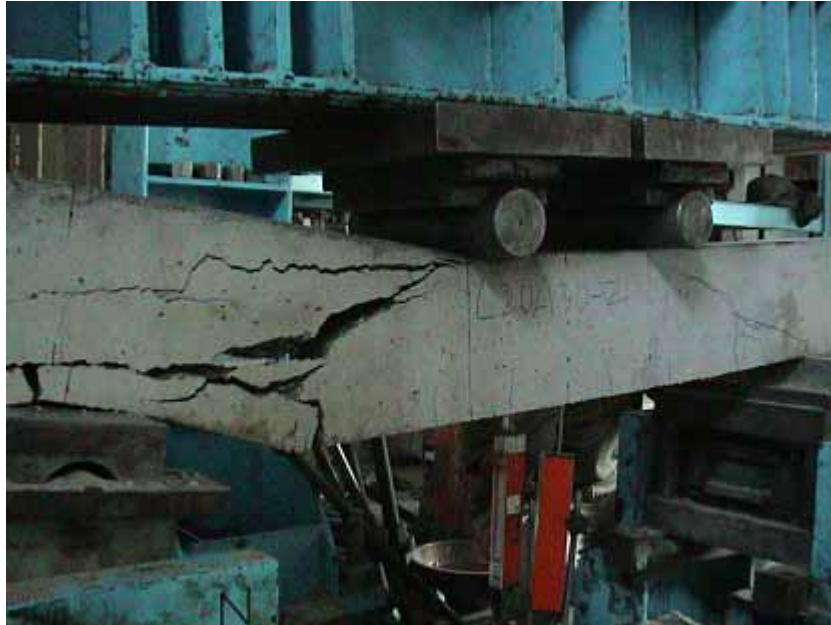
照片 4-5 輕質混凝土樑試體破壞情形(a/d=3.0)
