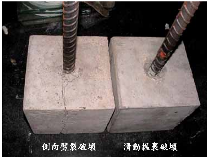
照片 4-1 側向劈裂破壞與滑動握裹破壞
