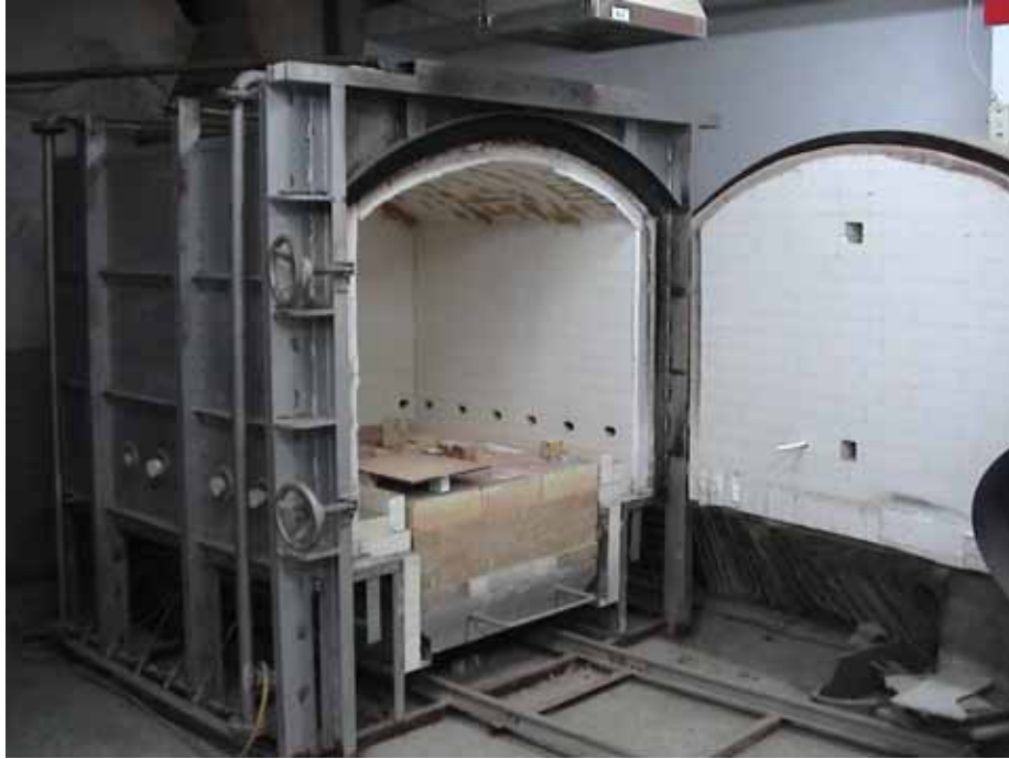
照片 5-1 混凝土樑之防火試驗裝置
