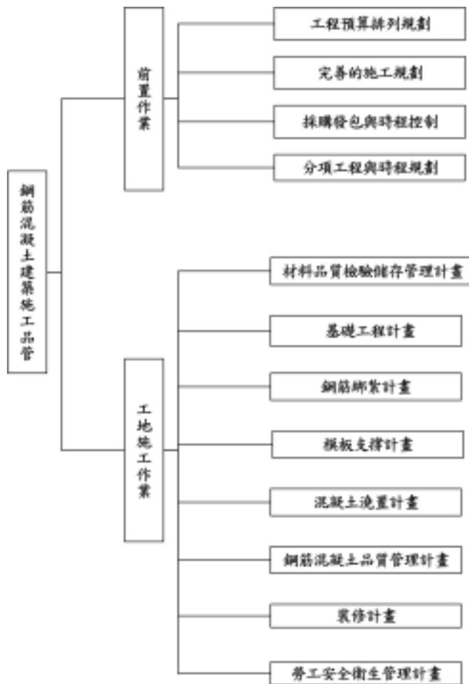
圖 2-1.1 鋼筋混凝土建築施工品管架構
