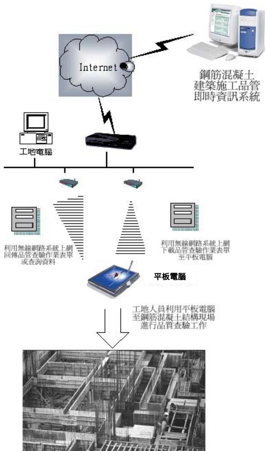
圖 5-2.2 鋼筋混凝土建築施工品管即時資訊系統工地使用架構
