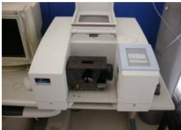
圖 4 量測半球輻射率試件之擺放位置
