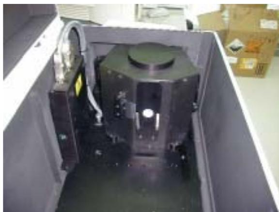
圖 3 量測透射率試件之擺放位置
