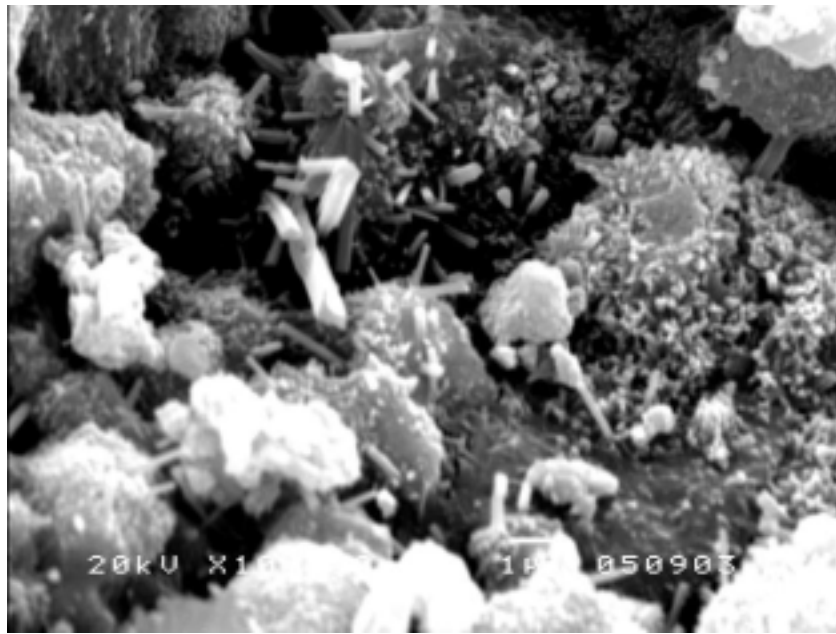
圖 3. 33 花崗岩水泥漿體經室溫養護 28 天的 SEM 圖 ( ×10000 )
