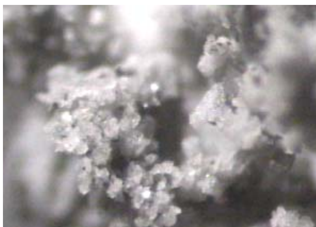
圖 3.37 廢花崗岩石材粉的顯微放大形態 (200 X)
