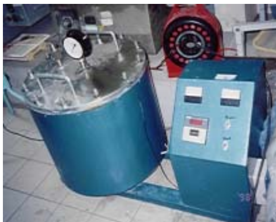
圖 3.10 水泥漿體的高溫養護試驗裝置
