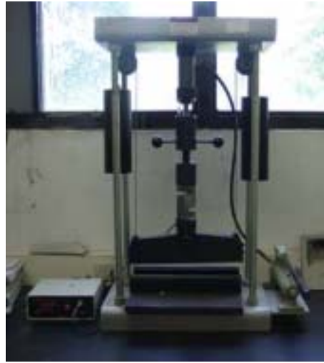
圖 3.42 抗彎強度檢測使用的試驗裝置
