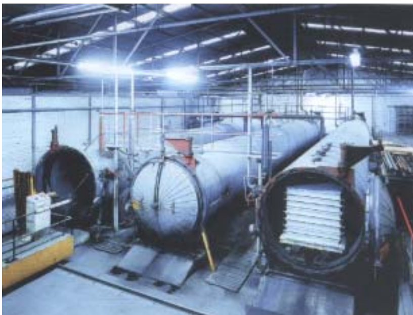
圖 3.48 廠型試製再生原料板胚高壓蒸汽釜處理情景
