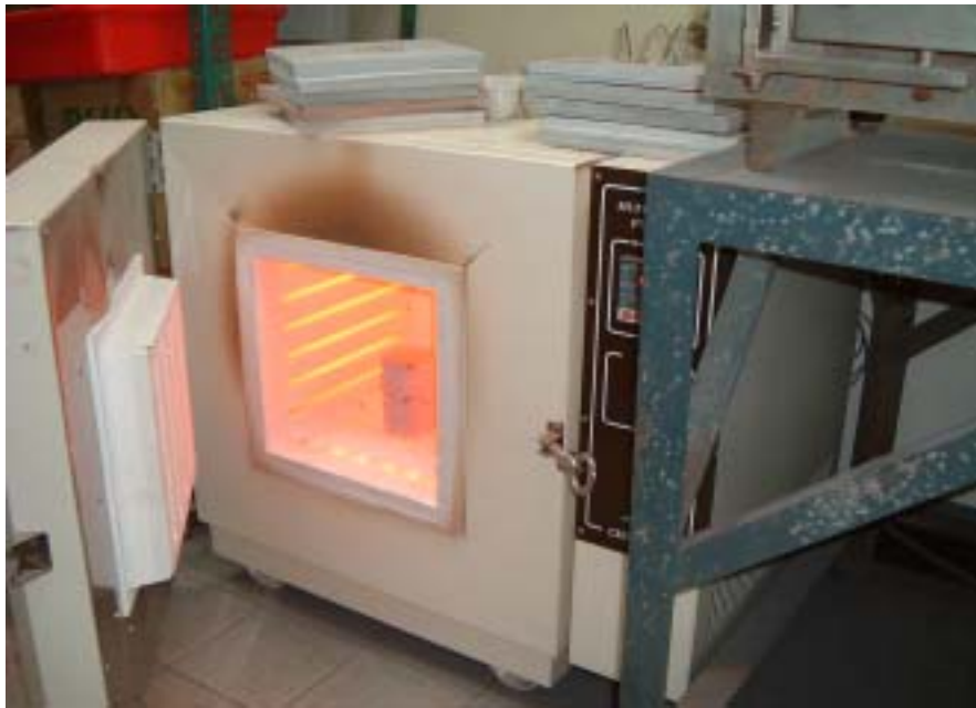
照片三、混凝土試體加熱情形
