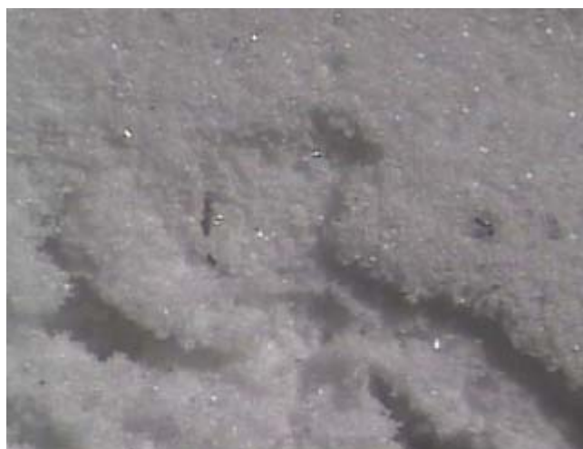
圖 3.36 廢玻璃經過粉磨處理（-200mesh）後的粉體顯微放大形態
