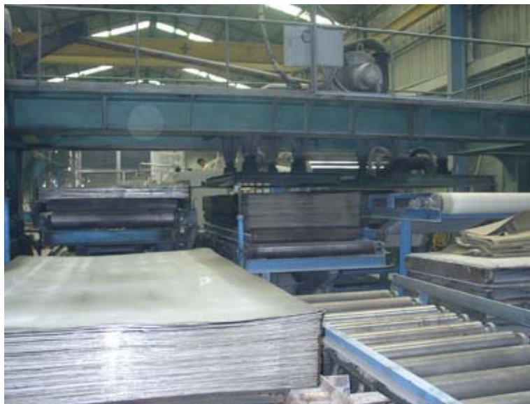
圖 3.52 試製水泥纖維板高壓成型的板胚產物情景
