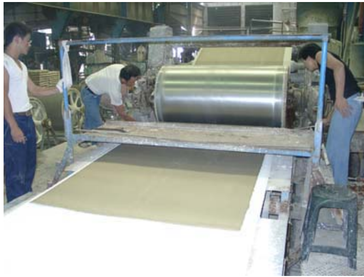
圖 3.51 試製水泥纖維板抄造製程的現場情景
