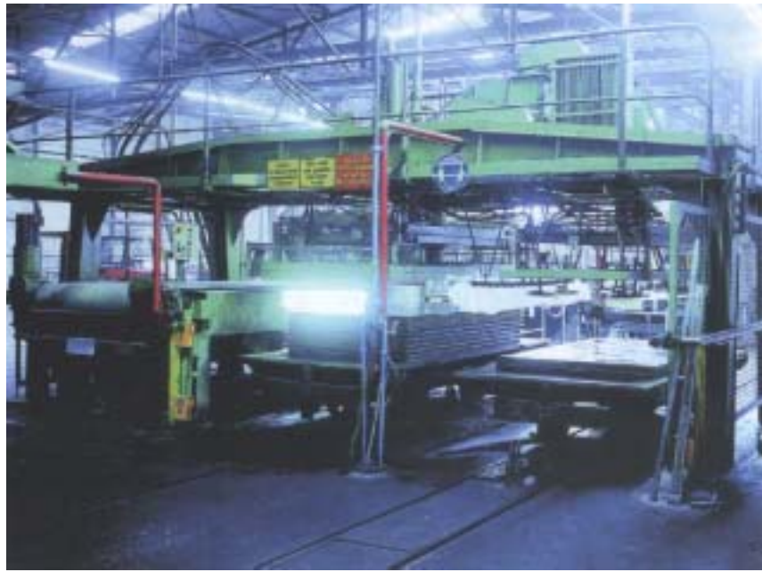
圖 3.47 廠型堆疊板胚的脫模處理情景
