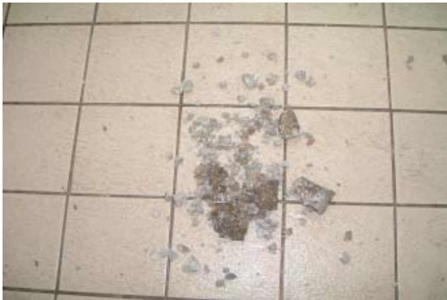
照片四、混凝土試體經熱能、浸水及自由落體實驗崩解後情形
