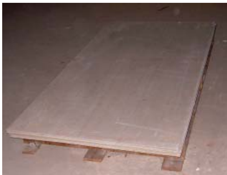
圖 3.53 以花崗石（40%）所試製的水泥纖維板產品
