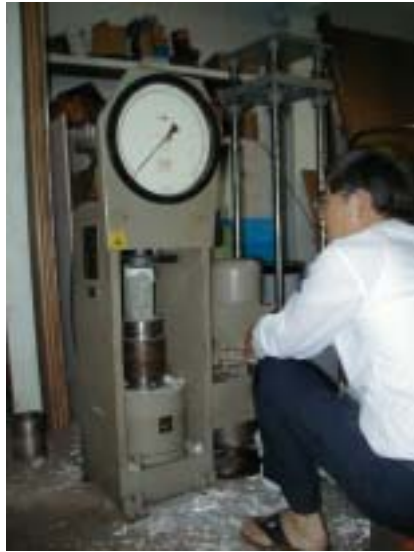
圖 3.40 以萬能試驗機進行抗壓強度檢測
