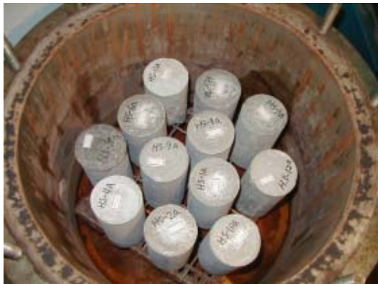
圖 3.39 抗壓試體高溫釜養護處理情形
