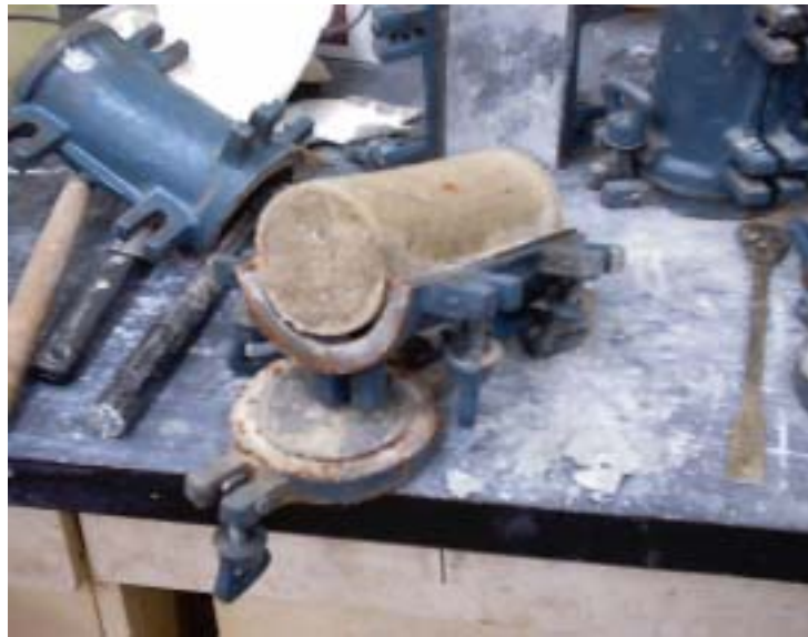
圖 3.38 抗壓試體的模具脫模情形
