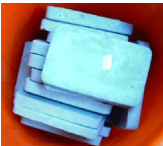
圖 3.11 製備完成的各種檢測用的再生原料漿體試樣
