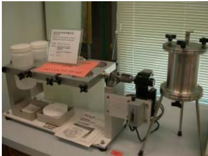
圖 5. 16 毒性溶出檢測裝置
