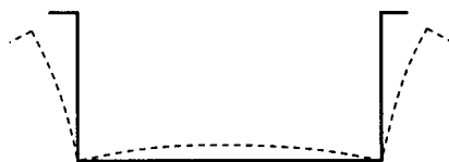
圖 C-6.2-6：U 型斷面樑之側向挫屈
