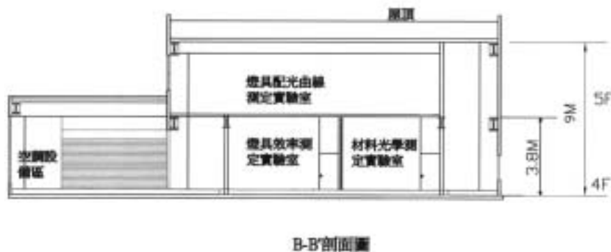
圖二(b)人工光實驗室及自然光實驗設施剖面配置示意圖
