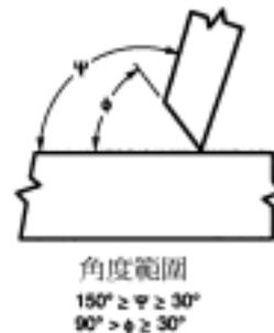
圖3.5(續)--部份滲透T,Y,K形管狀接和預檢定接頭
