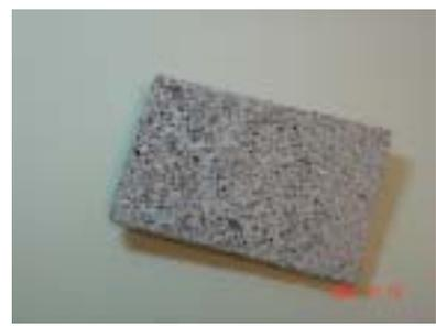
圖 6.23 鋁合金複合材質板(耐燃一級)<sup>63</sup>
