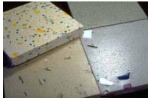
圖 6.37 再生玻璃材質地磚<sup>70</sup>
