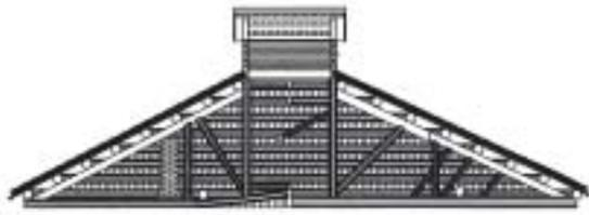
【圖 3-1-6】變異的西式三角桁架
