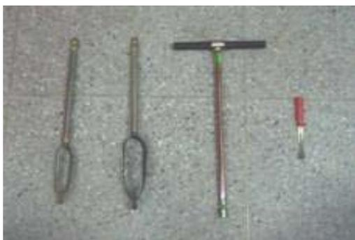
圖 3-2 綜合型手持採樣土器(Hand auger)。
