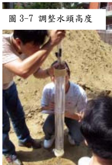
圖 3-7 調整水頭高度
