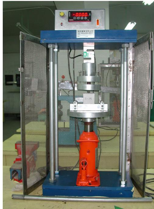
圖 3-1.19 彎曲試驗機
