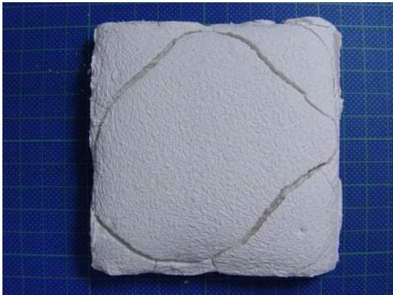
圖 3-2.8 大理石潑灰粉刷層裂縫試驗
