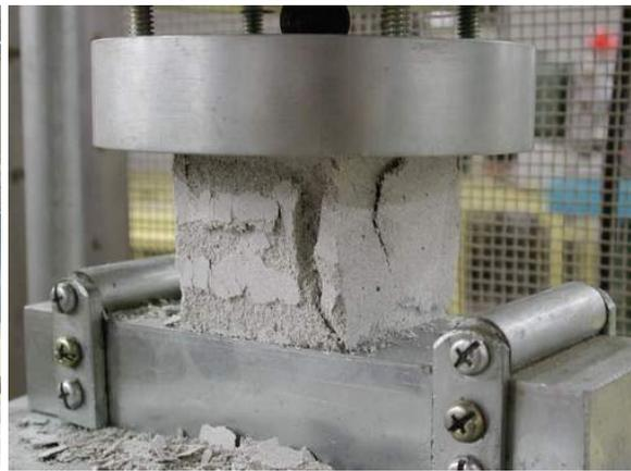
圖 3-1.29 試驗後破壞之試體
