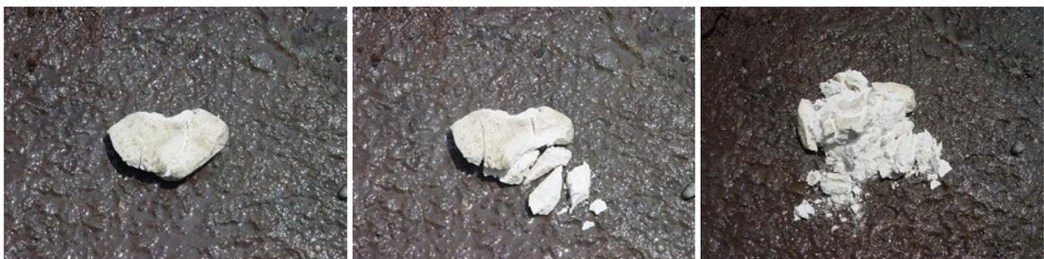
圖 3-1.4 生石灰消化過程—未潑水之生石灰塊      圖 3-1.5 生石灰消化過程—潑水後放熱體積膨脹      圖 3-1.6 生石灰消化過程—最後分解為粉末
