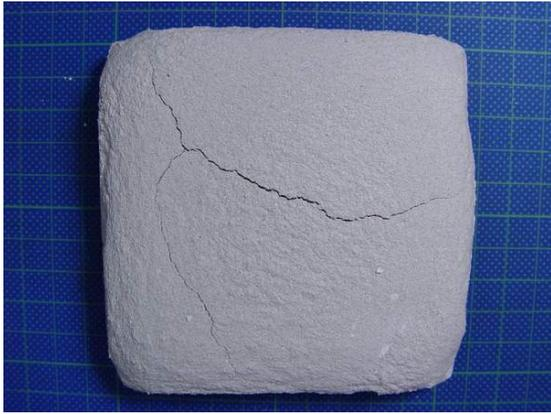
圖 3-2.6 硓古石灰粉刷層裂縫試驗
