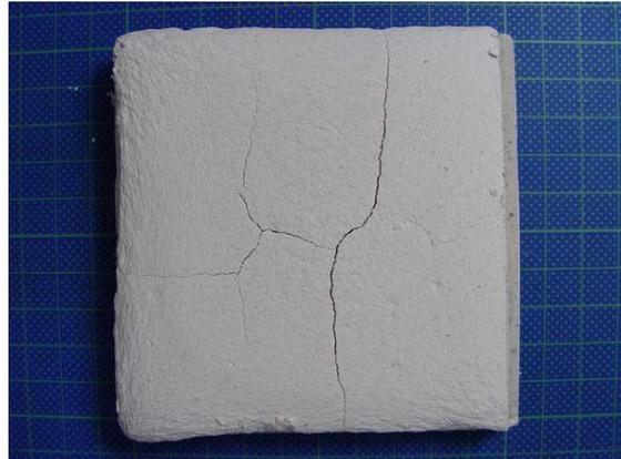
圖 3-2.7 蠣殼灰粉刷層裂縫試驗
