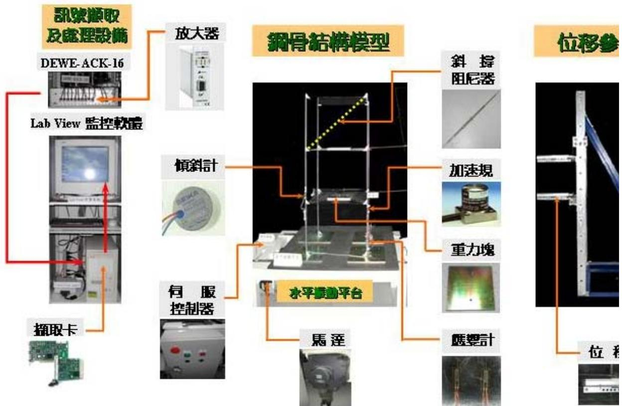
圖 1-7 建築結構狀態監控模擬實驗平台設備圖
